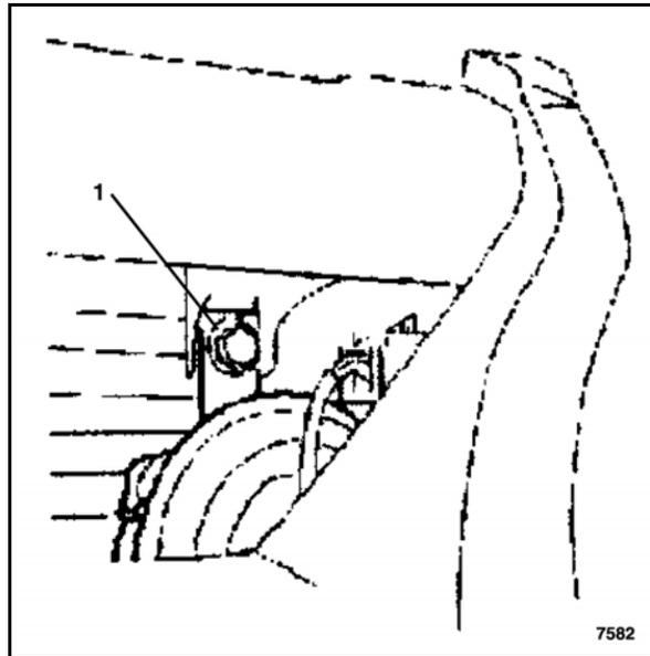
3. Desconecte el conector del arnés de cables del claxon (1).
