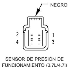
SENSOR DE PRESION DE FUNCIONAMIENTO (3.7L/4.7L)
