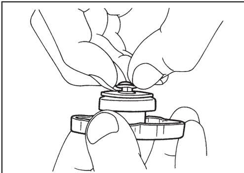
Jale la válvula de presión negativa (vacío) y compruebe que ésta se cierra completamente al soltarla.
