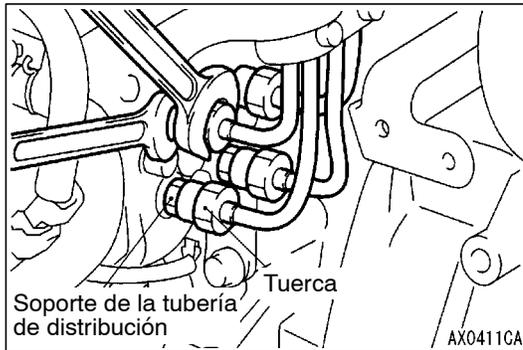
**◀B▶ DESMONTAJE DEL TUBO DE INYECCION DEL COMBUSTIBLE**
