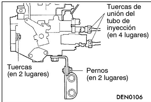
14. Si la aguja indicadora está fuera del valor normal, ajustar la puesta a punto de la inyección utilizando el siguiente procedimiento:
