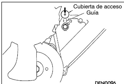
7. Instalar la cubierta de acceso mientras desliza la cubierta inferior delantera a lo largo de las dos guías.
