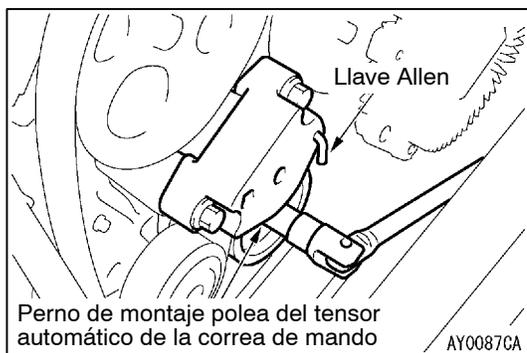
◀C▶ **DESMONTAJE DE LA CORREA DE MANDO DE LA BOMBA DE LA SERVODIRECCION Y DEL ALTERNADOR**
