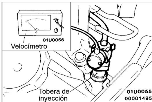
2. Conectar el velocímetro en la tobera de inyección o en el tubo de inyección.
