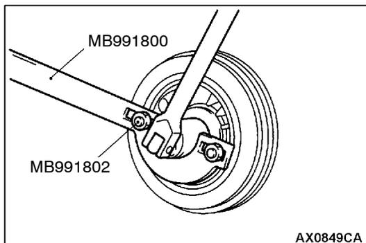
2. Utilizar la herramienta especial para evitar que gire el cigüeñal y desmontar los pernos.
