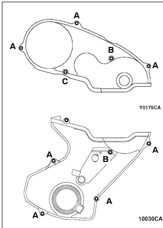
**▶◀ INSTALACION DE LA CUBIERTA INFERIOR DELANTERA DE LA CORREA DE DISTRIBUCION/CUBIERTA SUPERIOR DELANTERA DE LA CORREA DE DISTRIBUCION**
