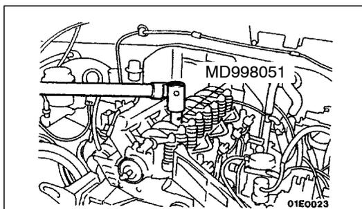
**◀D▶ DESMONTAJE DEL CONJUNTO DE LA CULATA DE CILINDROS**
