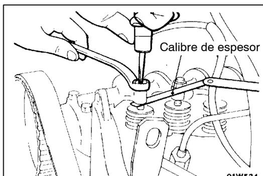
6. Si la holgura de válvula está fuera del valor normal, aflojar la tuerca de fijación del brazo de balancín. Utilizar un calibre de espesor para ajustar la holgura de válvula girando el tornillo de ajuste.
