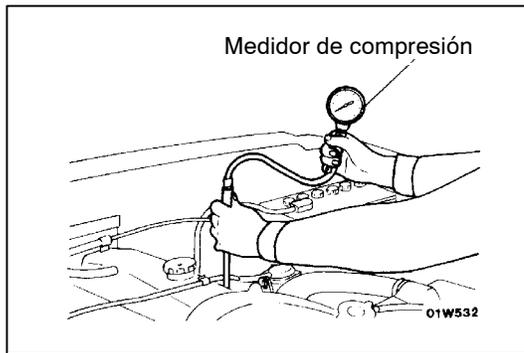
5. Colocar el medidor de compresión en uno de los orificios para bujía de incandescencia.
