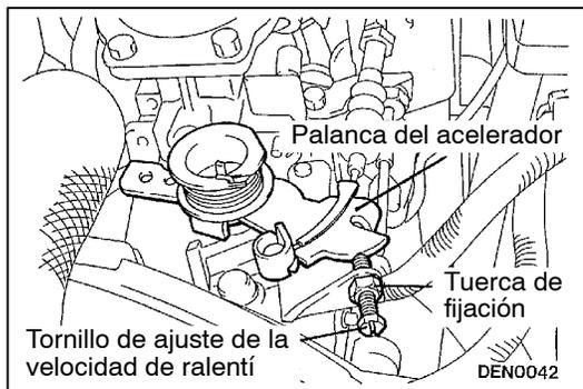
5. Si no está dentro del valor normal, aflojar la tuerca de fijación del tornillo de ajuste de ralentí y girar el tornillo de ajuste para ajustar la velocidad de ralentí. Luego de realizar el ajuste, apretar la tuerca de fijación.
