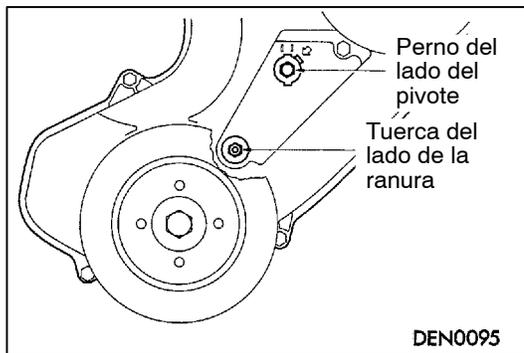
4. Desmontar la cubierta de acceso.
