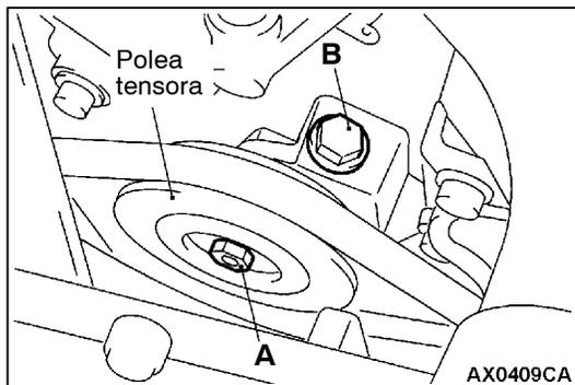
2. Si no se halla dentro de los valores normales, ajustar la tensión de la correa mediante el siguiente procedimiento.
