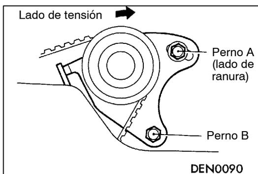
3. Aflojar los dos pernos de montaje de tensor 1 ó 2 vueltas.
