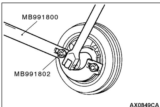
2. Usar la herramienta especial para impedir que el cigüeñal gire y retirar los tornillos.
