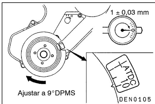
6. Antes de instalar la herramienta especial, verificar que la varilla de empuje sobresale unos 10 mm. La cantidad del saliente de la varilla de empuje se puede ajustar con una tuerca interior.
