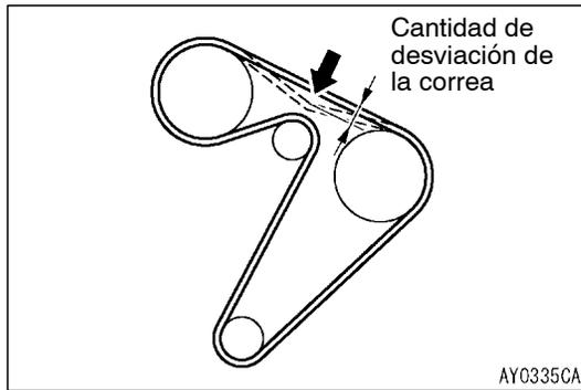
9. Presionar en el centro del tornillo con el dedo índice para comprobar la cantidad de desviación.
