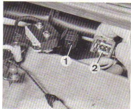
Control del contactor del ralentí
