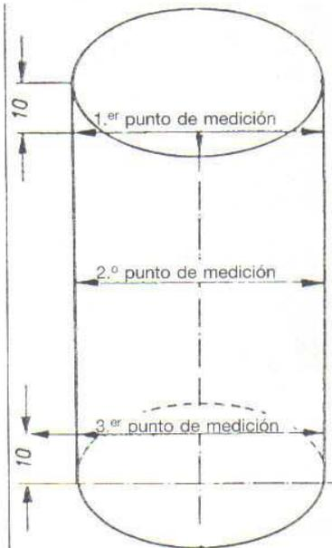
Puntos de medición del diámetro interior del cilindro
