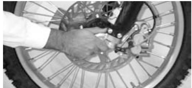
Para comprobar el ajuste de la dirección, levantar la moto del suelo, utilizando un soporte debajo del chasis. Mover el manillar suavemente a cada lado, si al dejar el manillar continúa moviéndose por sí solo, quiere decir que la dirección no está demasiado apretada. Agáchese delante de la moto, agarre la parte más baja de la horquilla delantera (en el eje), empuje y estire la horquilla (tal y como se muestra en la imagen anterior); si hay juego, la dirección está demasiado suelta.
