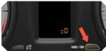
Después de cada revisión, debe poner a cero el indicador de mantenimiento.
