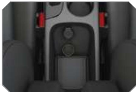
Este módulo de conexión, compuesto por un puerto USB, está situado en el apoyabrazos delantero.
