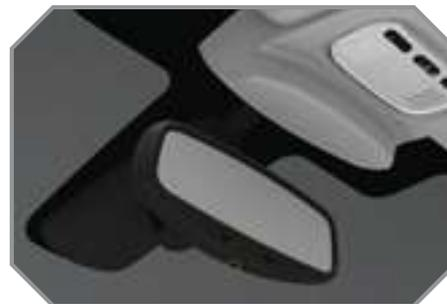
Dispone de un dispositivo antideslumbramiento que ensombrece el espejo del retrovisor, permitiendo reducir las molestias del conductor causadas por las luces de los vehículos que le siguen, el sol...
