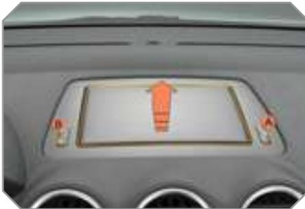
Esta pantalla se despliega y se guarda automáticamente.
