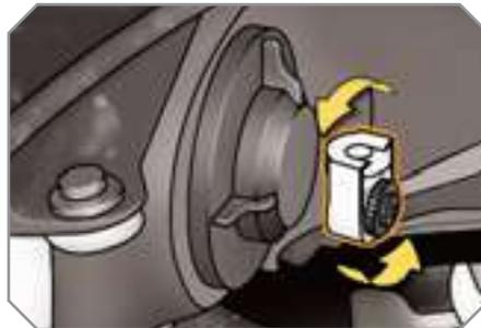
Para no encandilar a los otros usuarios de las calles, los faros deben ser regulados en altura, en función de la carga del Vehículo. El botón de reglaje está situado en el compartimiento motor, en cada bloque óptico.
