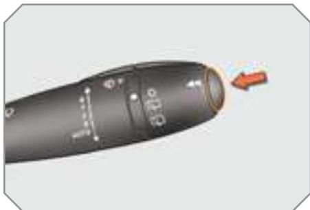
☞ Pulse el botón situado en el extremo del **mando del limpiaparabrisas** para visualizar sucesivamente los distintos datos del ordenador de a bordo.
