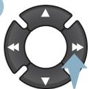
Pulse una de las teclas para seleccionar una pista del CD. Pulse la tecla LIST REFRESH para visualizar la lista de las carpetas de la recopilación MP3. Mantenga pulsada una de las teclas para avanzar o retroceder rápidamente.
