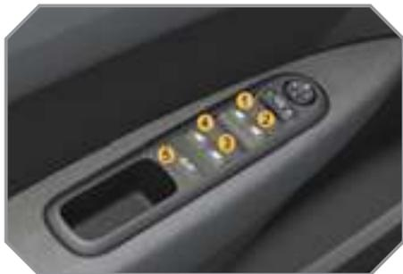
1. Interruptor de levantavidrios eléctrico del conductor
