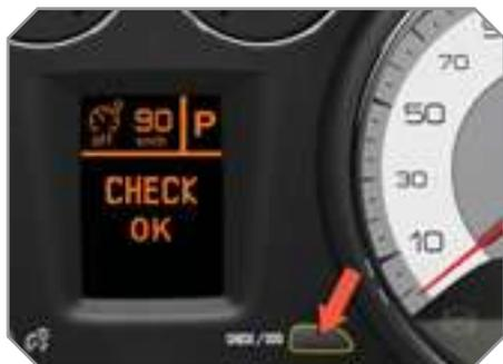
☞ Motor en marcha, para iniciar un check manual, pulse brevemente el botón "CHECK/000" del tablero.
