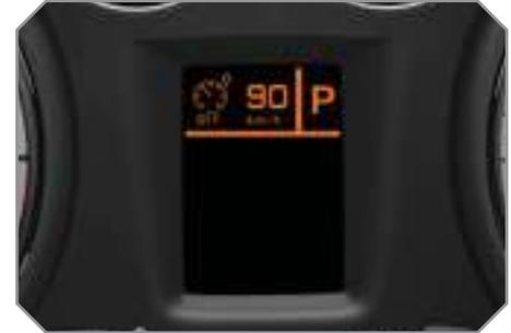
El modo regulador o limitador de velocidad aparece en el tablero de instrumentos cuando está seleccionado.
