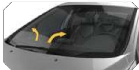
Esta posición permite separar las escobillas del parabrisas delantero.
