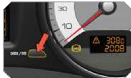
Los kilometrajes total y parcial se muestran durante treinta segundos al cortar el contacto, al abrir la puerta del conductor, así como al bloquear y desbloquear el vehículo.
