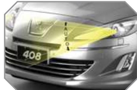
Para no molestar a los demás usuarios de la vía, este sistema corrige automáticamente y con el vehículo parado la altura del haz de luz de los faros de xenón en función de la carga del vehículo.
