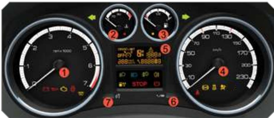
Panel que reagrupa los señalizadores y testigos que indican el funcionamiento del vehículo.
