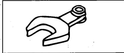
13-025.- Llave de vaso para la barra de acoplamiento de la dirección.
