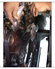
Loosen the clutch fan nut.
