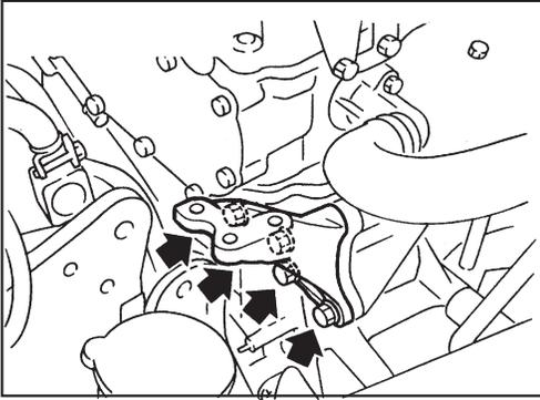
34. Quite los tornillos de la cubierta delantera y la cubierta delantera como se muestra.
