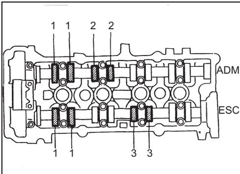
4. Compruebe solamente las válvulas que se indican en la figura.
