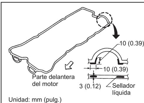
29. Aplique sellador líquido a la junta de la tapa de balancines.
