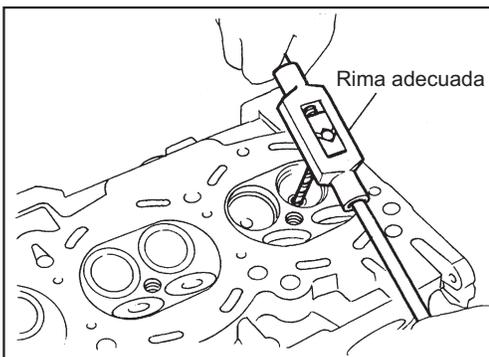
3. Rime el orificio con la guía de válvula de la cabeza.
