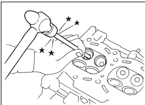
2. Saque la guía de válvula con una prensa [bajo una presión de 2 ton.] o un martillo y una herramienta adecuada.
