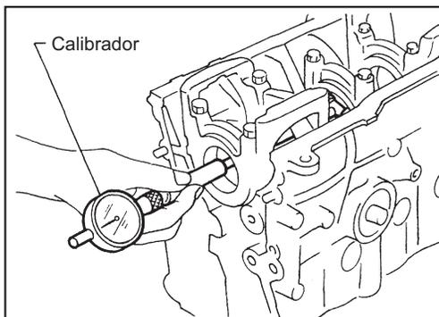
2. Instale la tapa del cojinete principal en el bloque de cilindros.
