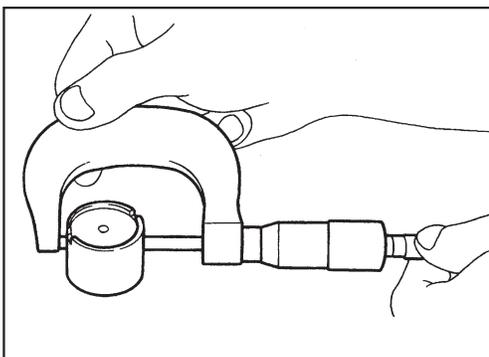
2. Compruebe el diámetro del levantaválvulas y el calibre de la guía del levantaválvulas.
