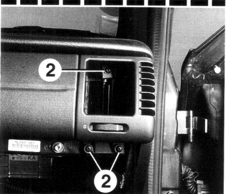
Desmontaje del soporte de salida de ventilación lateral derecho.
