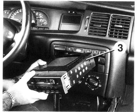
Desmontaje del autoradio.
