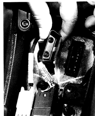
La toma diagnóstica está situada en la consola central.
