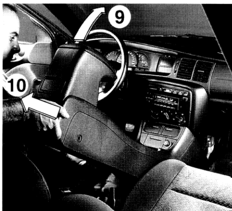
Desprendimiento de la consola central de suelo.
