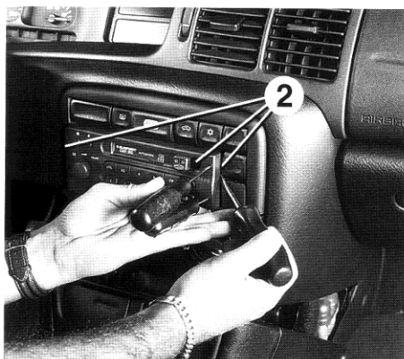
Desbloqueo de las lengüetas del autoradio.
