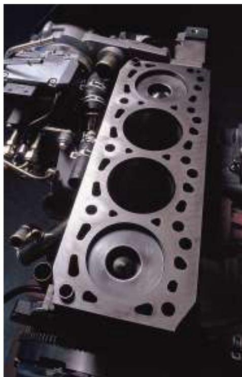
Pistón de un motor diesel de inyección directa
