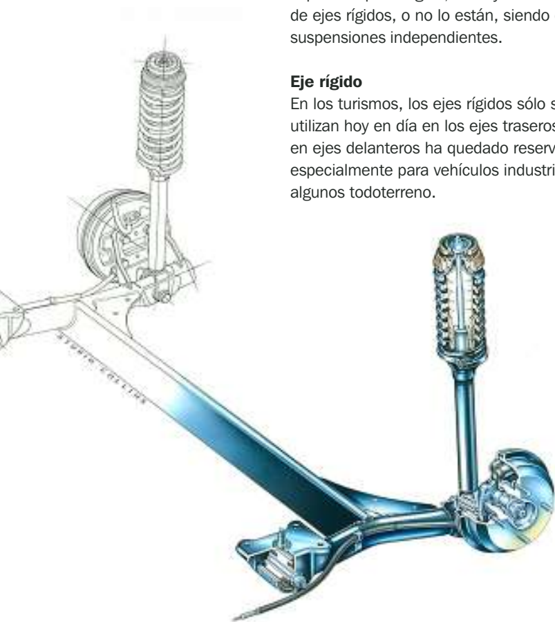
Eje semi-rígido trasero. Ford Ka
