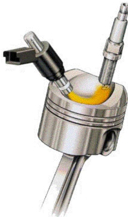
El mejor método para conseguir que un motor de gasolina funcione con mezcla pobre es la inyección directa. Ahora bien, ni todos los motores de mezcla pobre son inyección directa (por ejemplo, el 1,5 l de 114 CV que tiene el Honda Civic), ni todos los motores de inyección directa trabajan con mezcla pobre (por ejemplo, el 2,0 l de 140 CV que tiene el Renault Mégane).
