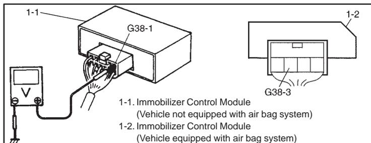
**DTC23 NO ECM/IMMOBILIZER CONTROL MODULE CODE TRANSMITTED FROM ECM OR DLC CIRCUIT OPENED/SHORTED**
