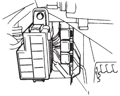
1. A/C condenser fan relay
