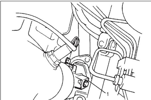
19) Remove exhaust manifold stiffener (1).
