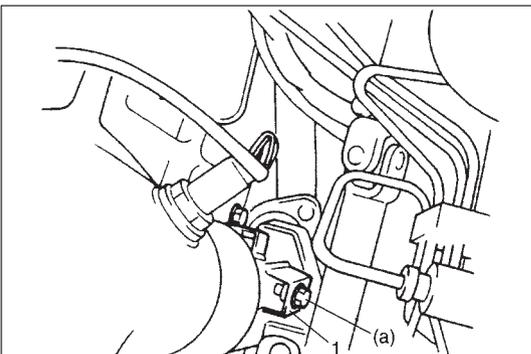
3) Install exhaust manifold stiffener (1).
