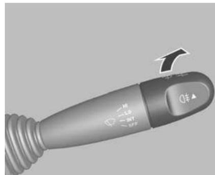
Para encender el piloto antiniebla, gire el extremo de la palanca del limpiaparabrisas con las luces de cruce encendidas.
