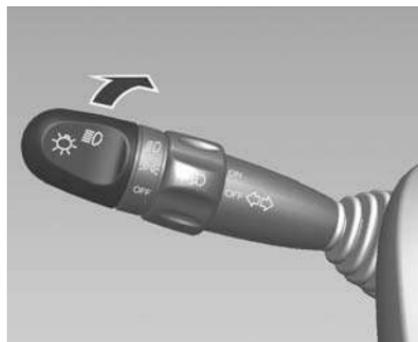
Apague y encienda las luces delanteras y traseras, gire el extremo de la palanca del conmutador combinado.
