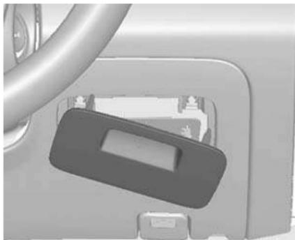
2. Desmonte la tapa del panel de fusibles en diagonal.
