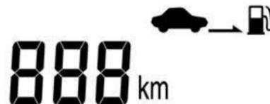
Este modo indica la distancia estimada que se puede recorrer hasta que se vacíe el depósito, basándose en el combustible que hay en ese momento en el depósito.
