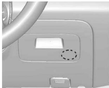
El bloque de fusibles interior está situado en la parte inferior del tablero de instrumentos, en el lado del conductor.
