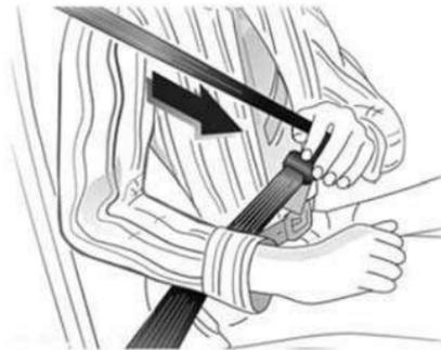
Extraiga el cinturón del retractor, guíelo por encima del cuerpo sin retorcerlo e inserte la lengüeta en el cierre.
