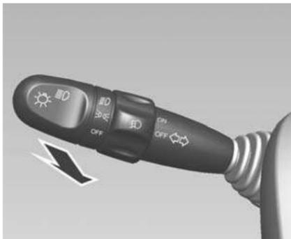
La palanca volverá a su posición normal al soltarla. Las luces de carretera estarán encendidas mientras sujete la palanca del conmutador combinado hacia usted.
