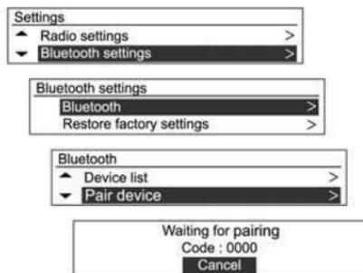
Pulse el botón **CONFIG** y utilice el botón **MENU** con el dial TUNE (Sintonizar) para acceder a Configuración → Configuración Bluetooth → Bluetooth → Asociar dispositivo y, a continuación, pulse el botón **MENU**.
