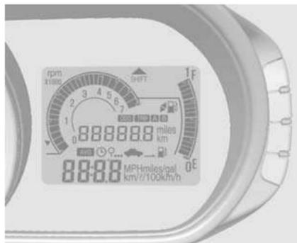
El ordenador de a bordo suministra al conductor información útil como la distancia que se puede recorrer con el combustible que queda, la temperatura ambiente, la velocidad media y el tiempo de conducción.
