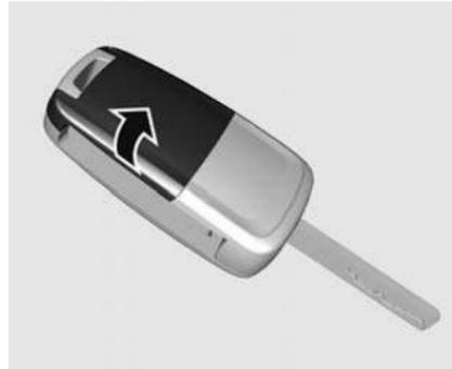
**Nota:** Utilice una pila de repuesto CR2032 (o una equivalente).
