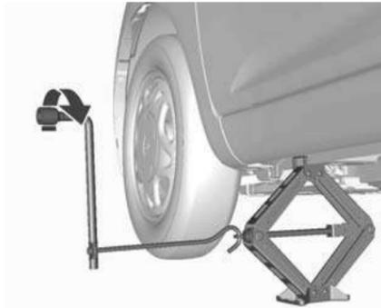
5. Gire la llave, comprobando la posición correcta del gato, hasta que la rueda se despegue del suelo.
