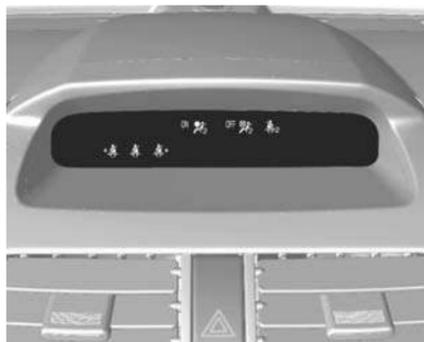
En caso de colisión, los sistemas de airbag para el asiento del acompañante se inflarán siempre que el testigo de control
