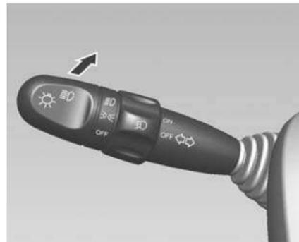
Para cambiar de luz de cruce a luz de carretera, pulse la palanca.
