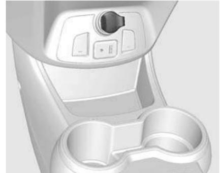
Hay una toma de corriente de 12 V situada en la consola delantera.
