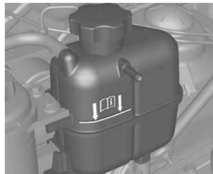
Con el sistema de refrigeración frío, el nivel del refrigerante debe estar por encima de la marca de la línea de llenado. Rellénelo si el nivel es bajo.
