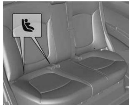
2. Localice las posiciones de los dos anclajes inferiores. La ubicación de los anclajes inferiores está señalada con una marca circular en el borde inferior del respaldo del asiento trasero.
