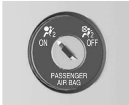
El sistema de airbag del acompañante se puede desactivar mediante una cerradura en el lado del salpicadero, visible con la puerta del acompañante abierta.
