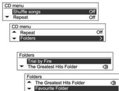
Para el disco MP3 (WMA), gire el dial **TUNE** (Sintonizar) en el menú de CD para ir a las carpetas y luego pulse el botón **MENU**
