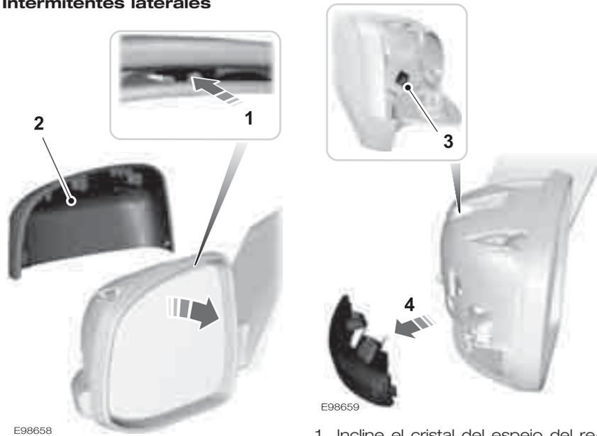
1. Incline el cristal del espejo del retrovisor hacia abajo, todo lo que sea posible. Suelte el clip de fijación con cuidado.
