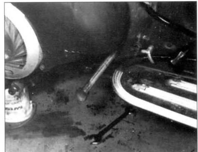
■ 1.5.10c El tornillo atraviesa el bastidor.
