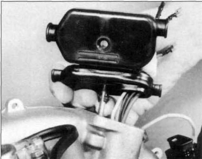
■ **7.30.7a** Se coloca la caja de empalmes y se vuelven a conectar los cables.
