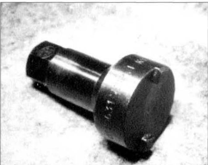
4.3.11d Herramienta especial para desenroscar el aro de fijación del cojinete.
