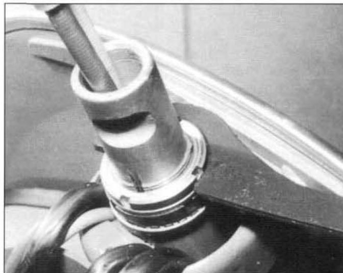
■ 10.2.9d ... y se aprieta la tuerca de bloqueo para fijar el ajuste.
