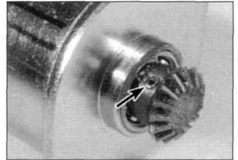
■ **13.19.9** Sacar el pasador (flecha) para liberar el piñón del extremo del eje del motor.
