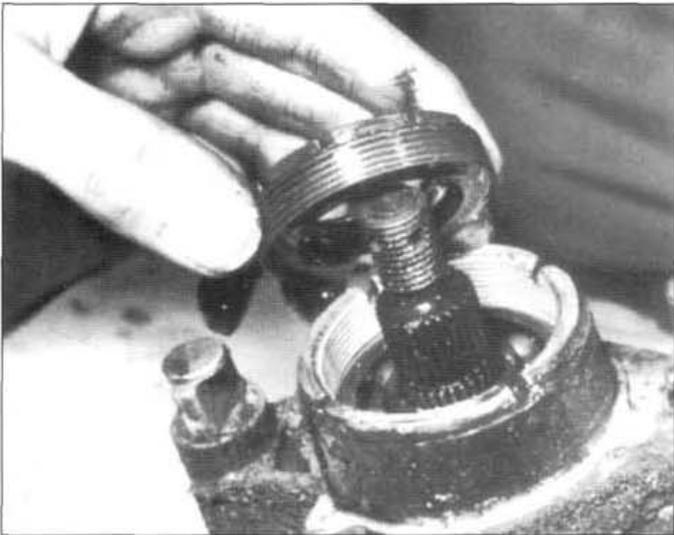
■ 1.13.4b Extraer el aro roscado de sujeción del cojinete para poder acceder a éste.
