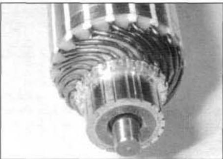
■ **13.19.11** Revisar los segmentos del colector por si existe un desgaste excesivo o hay daños.
