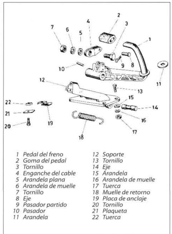
■ Fig. 11.2 Conjunto del pedal del freno.
