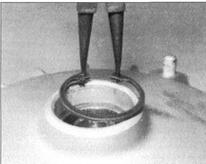
■ 11.5.2d Frenar el cojinete con el circlip.
