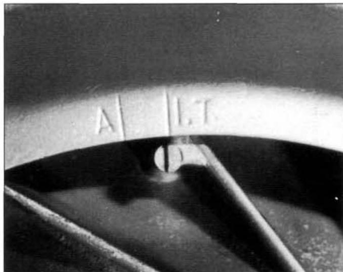
■ 9.12.4 Marcas para el calado del encendido en la serie PX.
