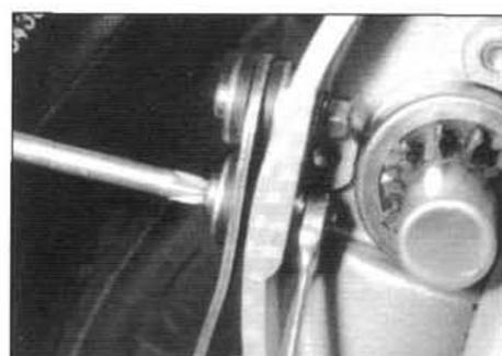
■ **13.18.4a** La centralita del encendido se saca de su soporte y se desenrosca el soporte del cárter; anótese la ubicación de la goma del soporte para que sirva de referencia durante el montaje.
