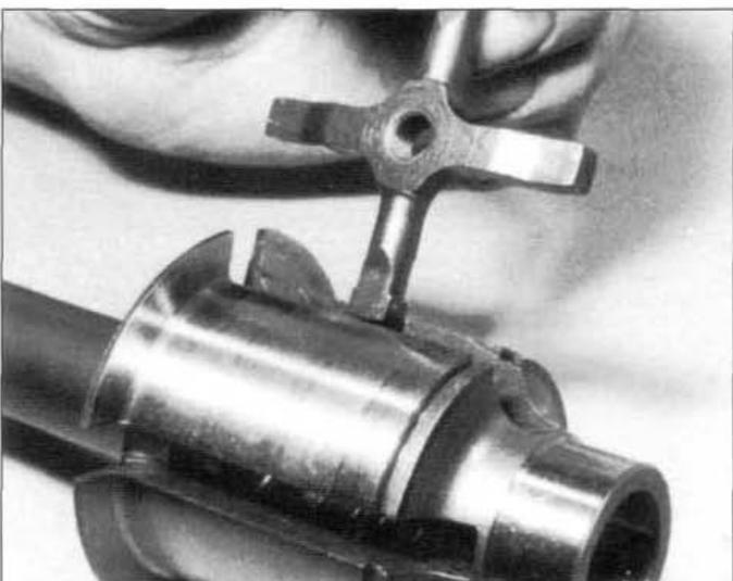
7.22.9a Se desliza el selector interno por la ranura en el eje principal y se gira 90° (obsérvense las patas redondeadas para permitir el giro).
