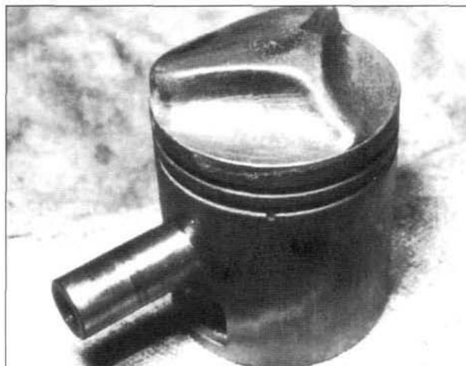
1.11.3c Marcar la posición del pistón para poder luego volver a montarlo correctamente.
