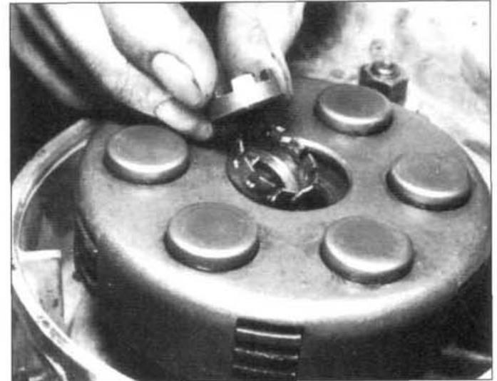
■ **1.30.1c** Se coloca la arandela de seguridad y se aprieta la tuerca central con la llave especial.
