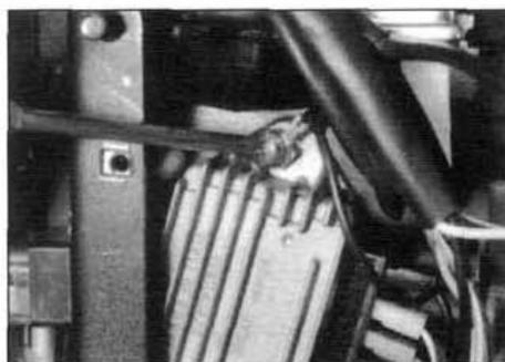
■ 13.15.3 El tornillo de anclaje superior del regulador/rectificador también sujeta el cable a masa.
