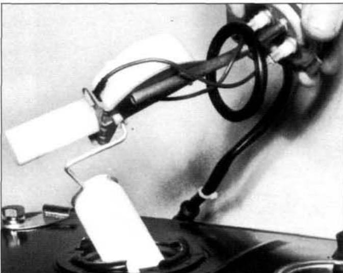
■ 12.12.2 El medidor del nivel de gasolina puede sacarse girándolo a la izquierda. Hay que proceder con cuidado para no dañar el flotador ni su brazo.
