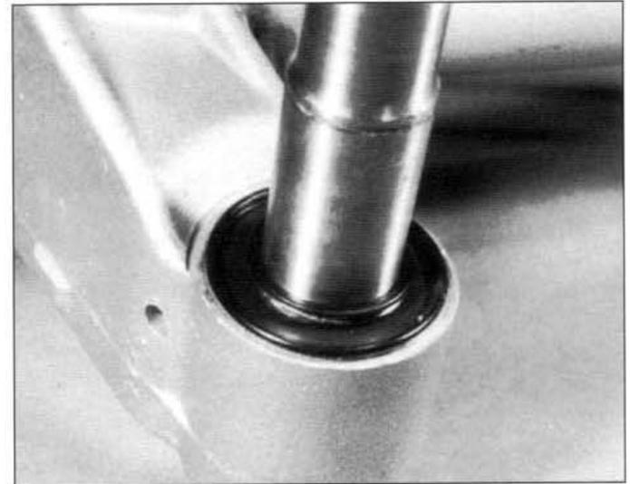
■ 11.3.5d ...seguido de la junta de estanqueidad del plato...
