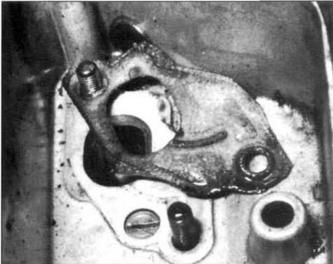
■ 1.7.3a La junta del carburador oculta el tornillo de sujeción de la carcasa.
