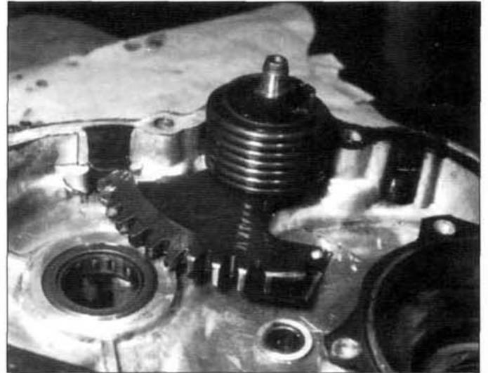
1.22.1 Un tope de goma amortigua el retorno del engranaje del pedal de arranque.
