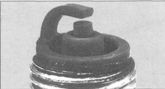
■ **Acumulación de hollín:** Depósitos negros y secos que provocan fallos de encendido y chispa débil. Están causados por una mezcla excesivamente rica, funcionamiento defectuoso del estrangulador o filtro de aire bloqueado o muy sucio.
