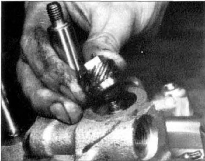
4.3.11b La tuerca del piñón de transmisión del velocímetro tiene la rosca a la izquierda.
