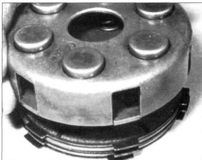
1.25.6 Ensamblar con el disco de compresión arriba.
