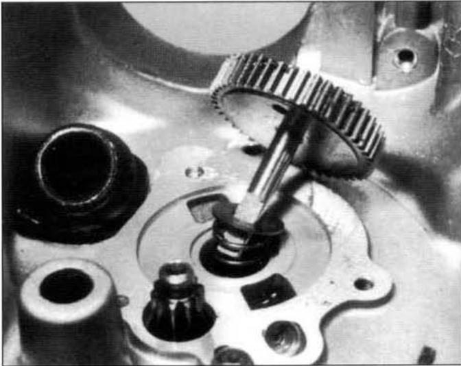
7.27.1b Reponer el muelle, la arandela y el piñón tal como se muestra, además de una junta nueva para la tapa.
