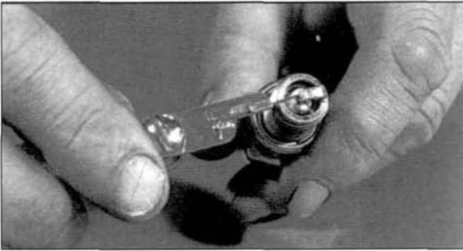
■ **Comprobación de la distancia entre los electrodos:** La separación entre electrodos debe comprobarse con una galga.
