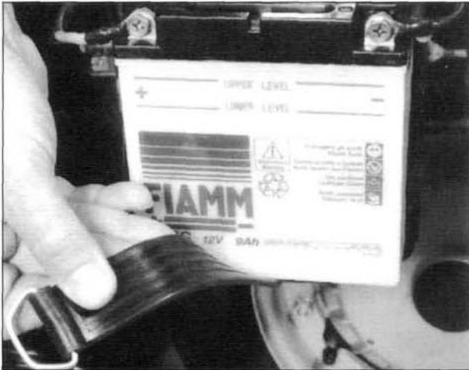
■ 13.2.2 El nivel del electrolito de la batería debe estar entre las marcas UPPER y LOWER, indicadas en la carcasa.
