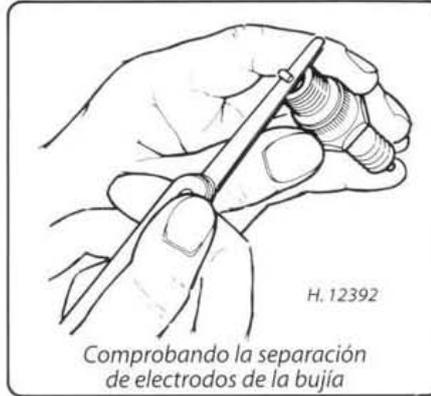
Comprobando la separación de electrodos de la bujía
