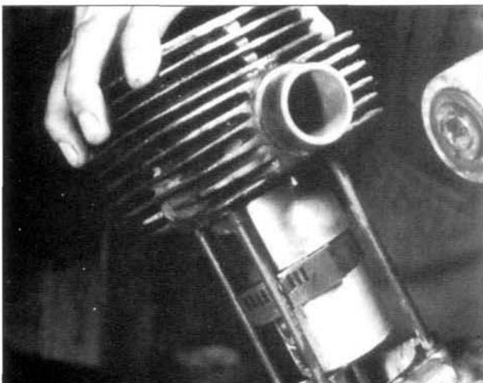
■ 1.32.5 Una abrazadera que comprima los aros, facilitará el montaje del pistón en el cilindro.
