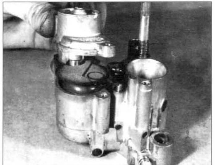
2.7.2 La parte superior de la cubeta del flotador va sujeta por dos tornillos.
