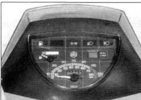
■ **13.11.1** Panc! de instrumentos sobre la carcasa del manillar. La foto muestra el de las primeras T-5.
