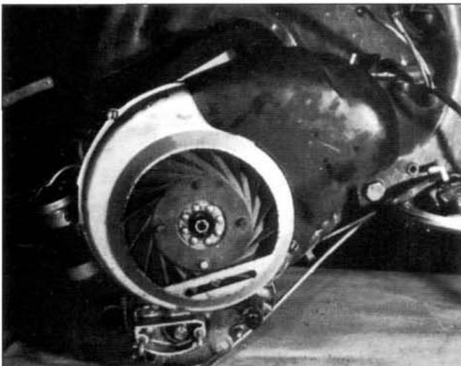
■ 1.36.2a Colocar primero el tornillo del soporte delantero del motor.
