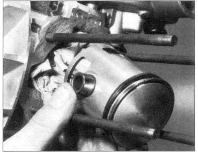
■ 7.6.5 Retirar ambos circlips y desplazar el bulón para liberar el pistón.
