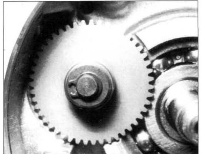
7.26.1c ...una segunda arandela y el circlip de fijación.
