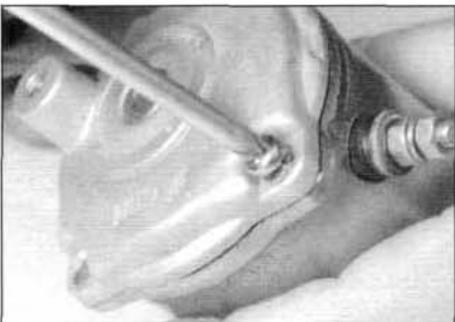
■ **13.19.2** Se quitan los tres tornillos para soltar la tapa del motor de arranque.
