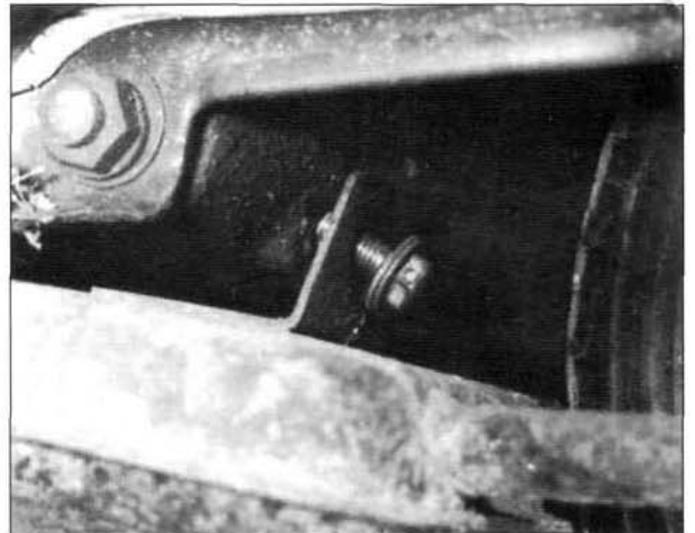
1.5.1b El silencioso va fijado con un tornillo a la parte inferior del bastidor.
