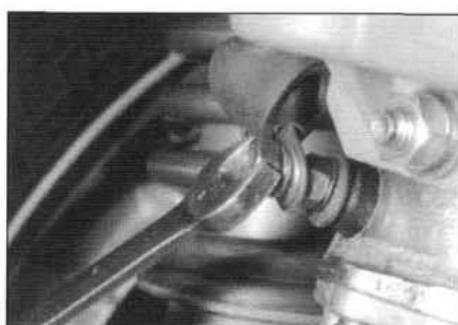
■ **13.18.5** Se desconecta el cable del motor de arranque.
