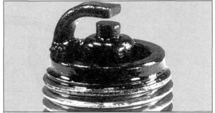
■ **Bujía engrasada:** Depósitos húmedos de aceite que provocan fallos de encendido o chispa débil. Se deben a un exceso de lubricación.
