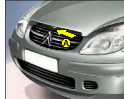
Levantar la paleta **A** situada en el borde y en el centro del capó y levantarlo
