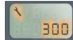
Unos segundos después de cortar el contacto, el cuentakilómetros total recupera el funcionamiento normal y **la llave de mantenimiento se queda encendida.**
