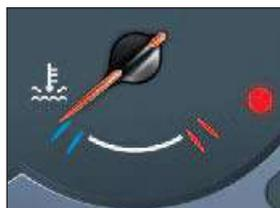
**Indicador de temperatura del líquido de refrigeración**
