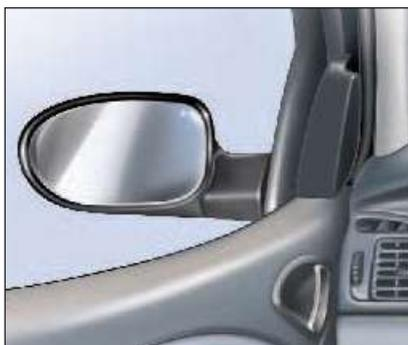
Si la caja de retrovisor se sale de su posicionamiento inicial, colocarlo de nuevo, con el vehículo parado, ejerciendo una acción manual o utilizando el mando eléctrico para abatirlo.
