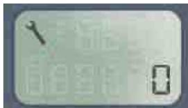
**Observación:** si el tiempo máximo entre dos vaciados fuera alcanzado antes del límite de kilometraje establecido, el símbolo de mantenimiento se enciende y el indicador señala «0» una vez rebasado dicho kilometraje.
