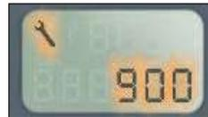
Pasados unos segundos aparece indicado el nivel de aceite; seguidamente, el cuentakilómetros total recupera su funcionamiento normal y la llave de mantenimiento se queda encendida.
