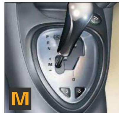
**Observación :** El paso de una marcha a otra solo se produce si lo permiten las condiciones de velocidad y de régimen motor.
