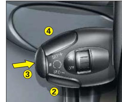
El regulador de velocidad sólo deberá utilizarse cuando lo permitan las condiciones de rodaje a velocidad constante. No utilizarla cuando la circulación sea muy densa ni en carreteras accidentadas cuyo firme presente unas deficientes condiciones de adherencia o cualquier otra dificultad.
