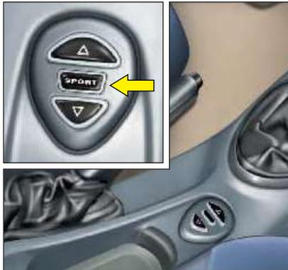
La suspensión hidractiva III se adapta automáticamente al estado de la calzada y al estilo de conducción.
