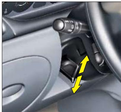
El volante puede ser regulado en altura y en profundidad.
