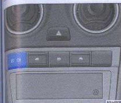
Fig. 64 Interruptor de funcionamiento de los faros antiniebla
