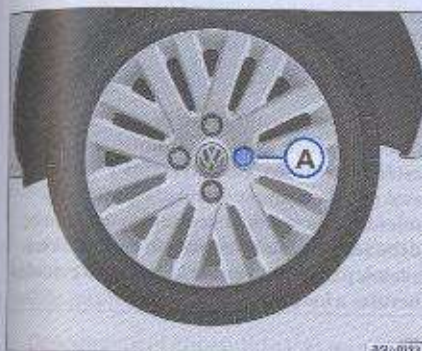
Fig. 131 Secuencia de remoción de los tornillos de rueda
