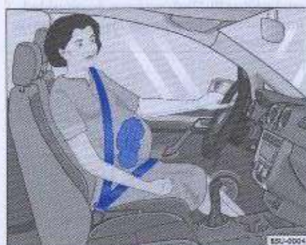
Fig. 18 Posición correcta del cinturón de seguridad en embarazadas
