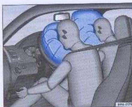
Fig. 24 Ilustración del funcionamiento: airbags inflados
