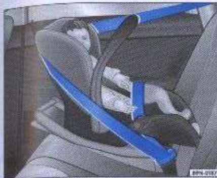
Fig. 27 Asiento para niños de la clase 0, montado en el sentido contrario al de la marcha, en el asiento trasero
