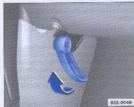
Fig. 107 Detalle del área de los pies en el lado del conductor; palanca desbloqueadora de la tapa del vano motor
