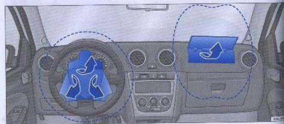
Fig. 25 Rayo de acción y coberturas de los airbags en caso de accionamiento
