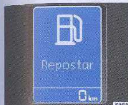
Fig. 46 Luz indicadora y texto de alerta en el display
