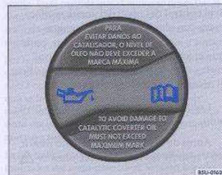
Fig. 111 En el vano motor: tapa de la boquilla de llenado de aceite del motor
