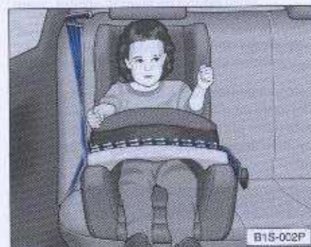
Fig. 28 Asiento para niños de la clase 1, montado en el sentido contrario al de la marcha, en el asiento trasero
