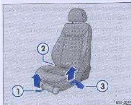
Fig. 79 Elementos para la regulación del asiento delantero lado conductor
