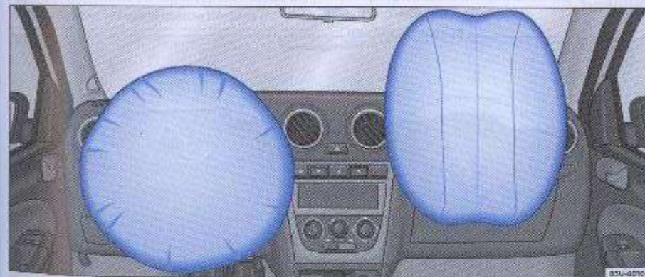
Fig. 23 Airbags accionados, vistos en el sentido de la marcha
