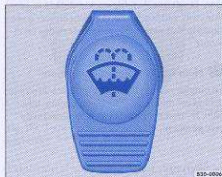
Fig. 114 En el vano motor: tapa del depósito del limpiaparabrisas / luneta
