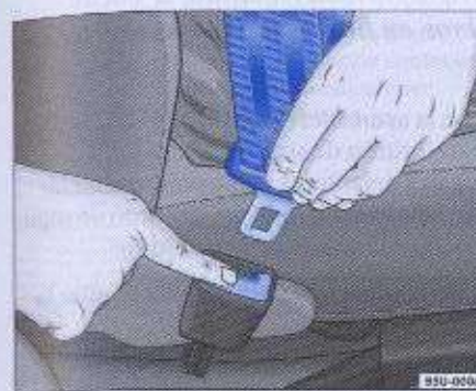
Fig. 19 Soltar la lengüeta del cierre del cinturón
