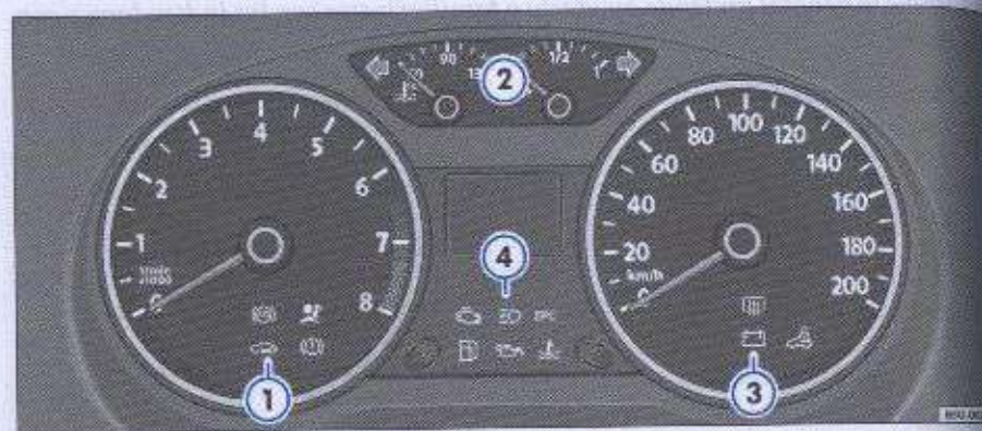
Fig. 33 Cuadro de instrumentos con luces indicadoras. Algunas luces son mostradas sólo con el encendido conectado. Algunas de las luces indicadoras aquí presentadas pertenecen a determinadas versiones o son opcionales.
