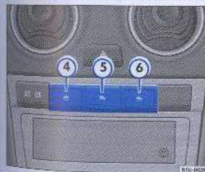
Fig. 62 Teclas de mando de los cristales traseros en el panel
