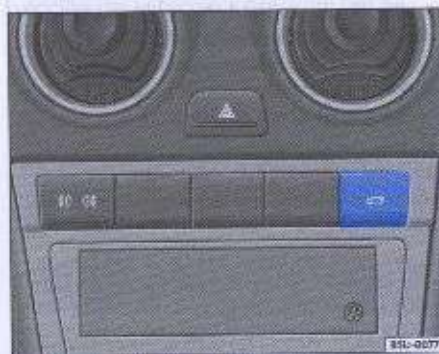
Fig. 58 Detalle en el tablero de instrumentos: interruptor de apertura de la tapa del maletero
