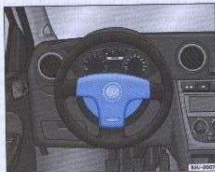
Fig. 21 Ubicación del airbag del conductor; en el volante
