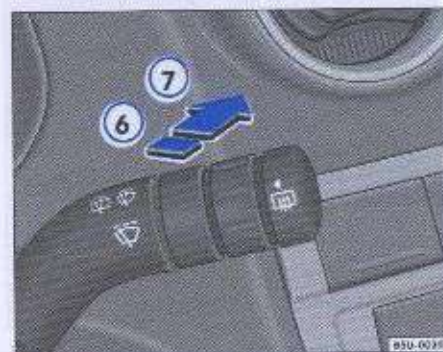
Fig. 72 Palanca del limpiador/lavador de la luneta
