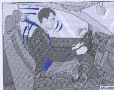
Fig. 11 Conductor protegido por el cinturón de seguridad correctamente abrochado durante una frenada brusca
