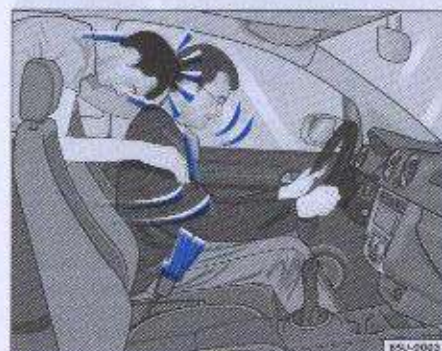
Fig. 10 El pasajero del asiento trasero que no se puso el cinturón de seguridad es proyectado hacia adelante, sobre los pasajeros de los asientos delanteros
