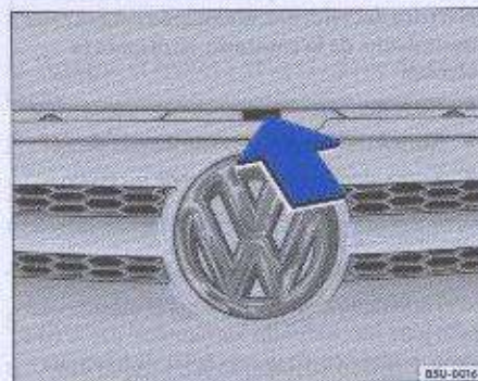
Fig. 108 Traba de seguridad para abrir la tapa del vano motor
