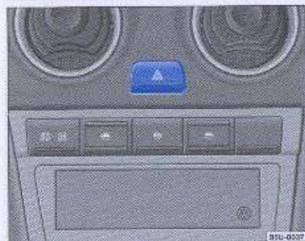
Fig. 65 Detalle en el tablero: interruptor de la luz de advertencia
