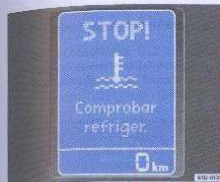
Fig. 45 Luz indicadora y texto de advertencia en el display del cuadro de instrumentos
