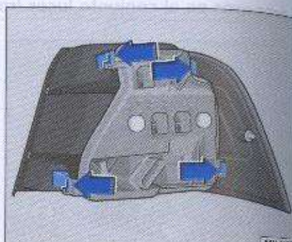
Fig. 150 Soporte de las lámparas en el conjunto linternas traseras
