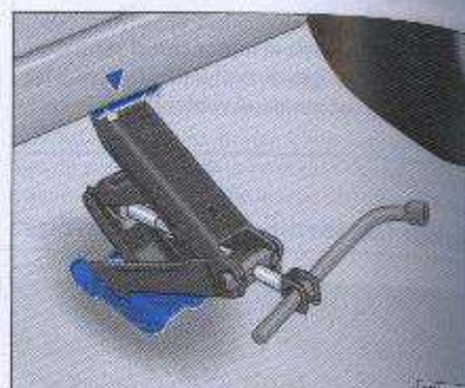
Fig. 130 Gato colocada en la parte trasera, lado izquierdo
