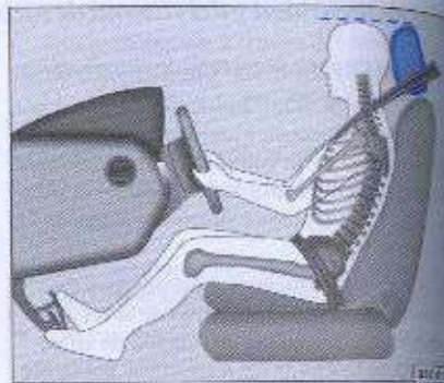
Fig. 76 Vista lateral: apoyo para cabeza correctamente ajustado y la correa del cinturón correctamente puesta
