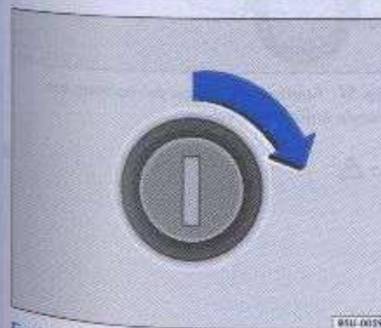
Fig. 55 Tapa del maletero: apertura
