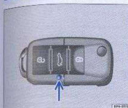
Fig. 53 Luz piloto de la batería en la llave con mando a distancia
