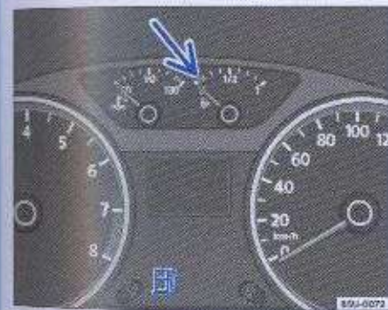
Fig. 37 Detalle del cuadro de instrumentos: Indicador del nivel de combustible - los vehículos con tacómetro
