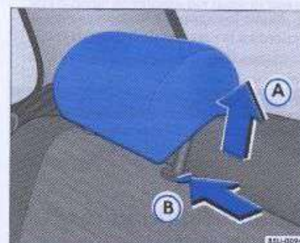
Fig. 78 Ajustar o remover los apoyos para cabeza traseros
