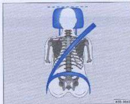
Fig. 75 Vista frontal: apoyo para cabeza correctamente ajustado y la correa del cinturón correctamente puesta
