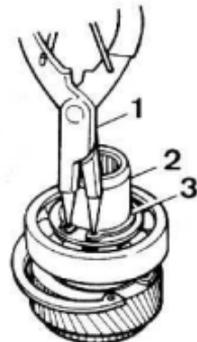
Ensamblado del cubo de garras de cambio a cuatro ruedas motrices.
