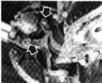
Tornillos de fijación de una pinza.
