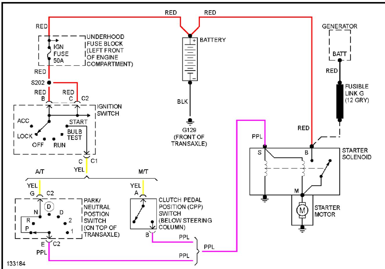
**Fig. 41: Starting Circuit**
