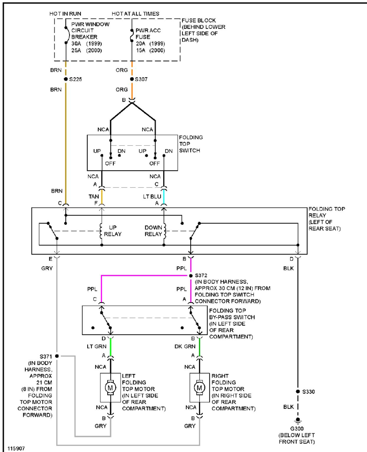
**Fig. 33: Convertible Top Circuit**
