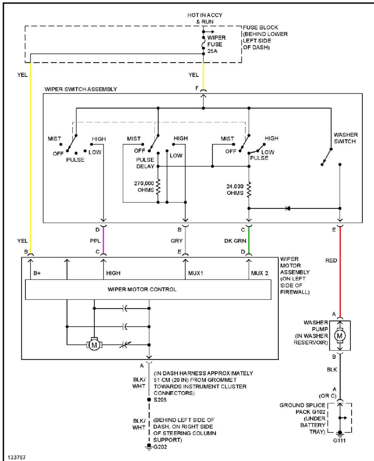
**Fig. 49: Pulse Wiper/Washer Circuit**
