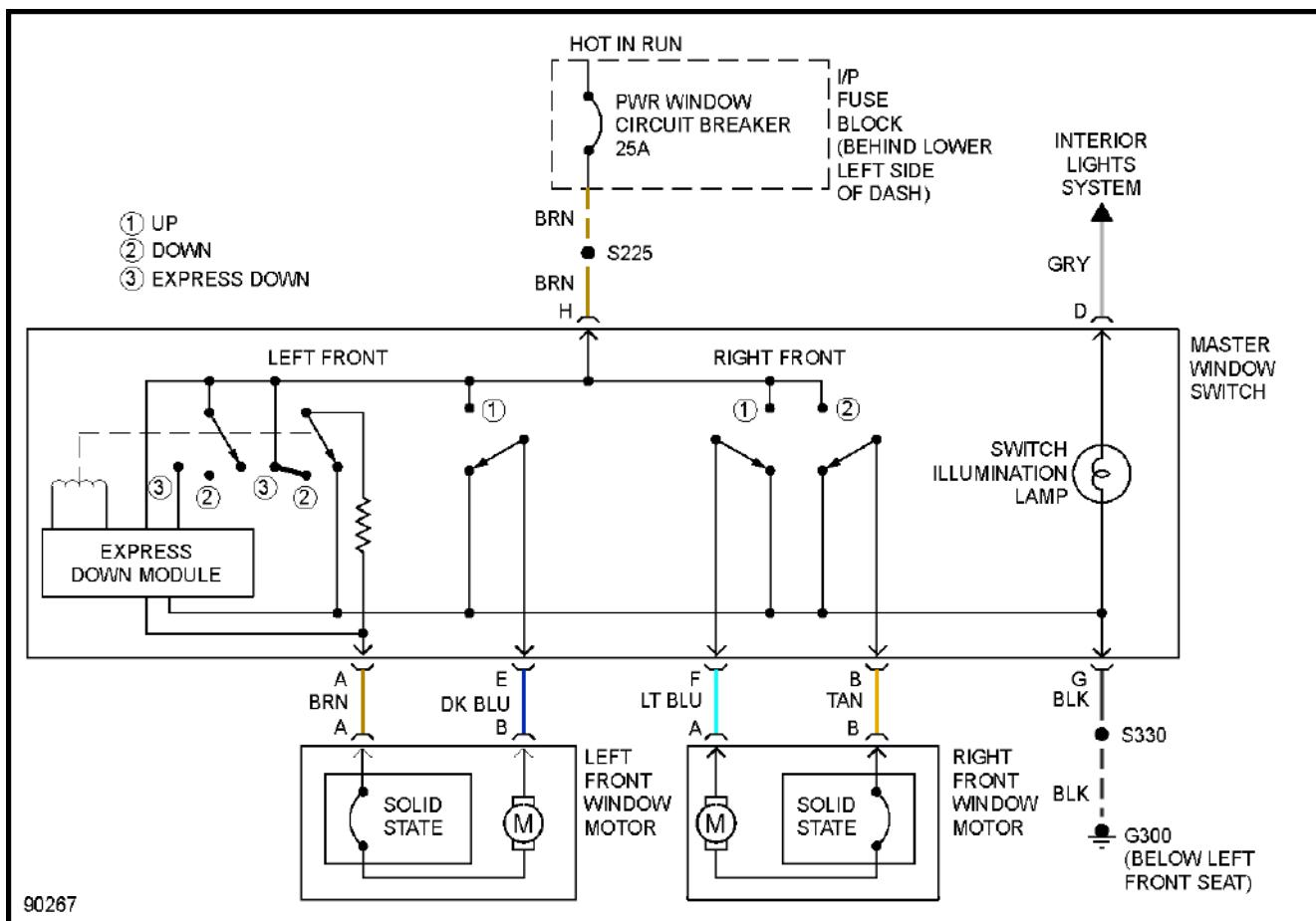
**Fig. 35: Power Window Circuit, 2 Door**
