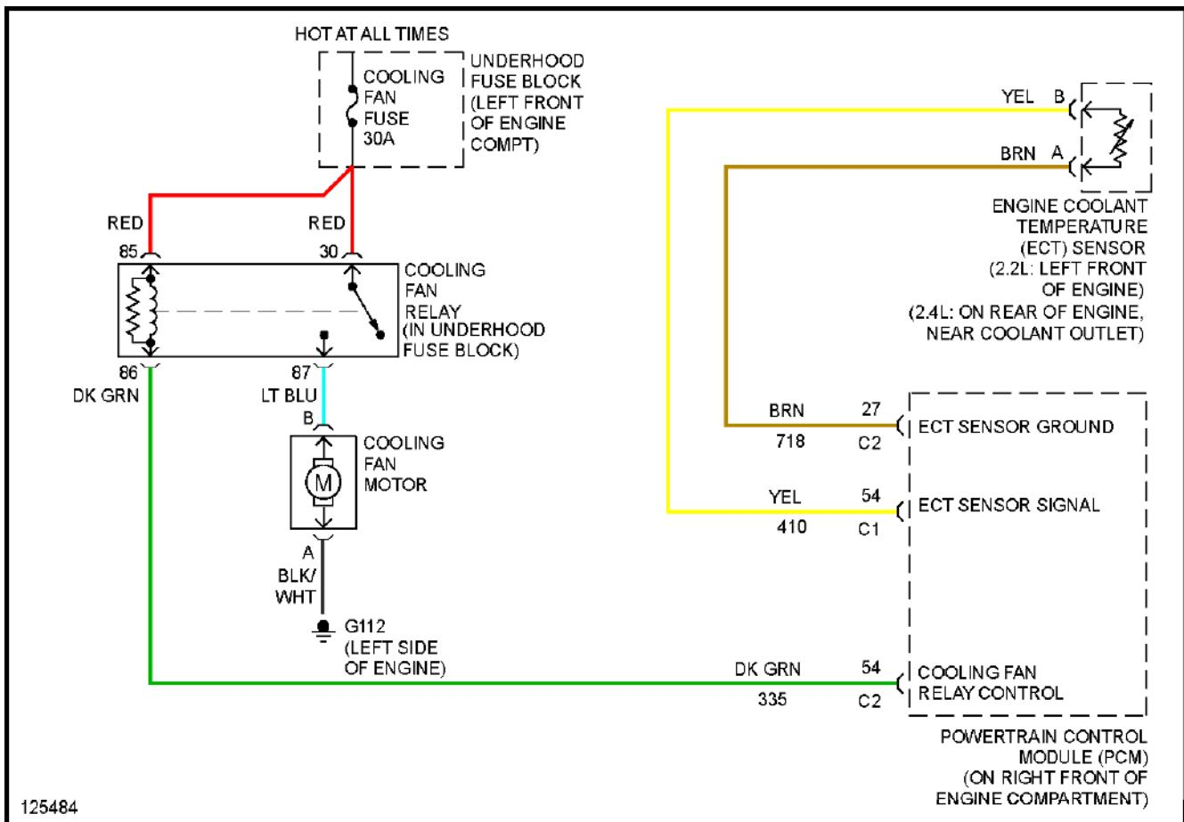
**Fig. 8: Cooling Fan Circuit**
