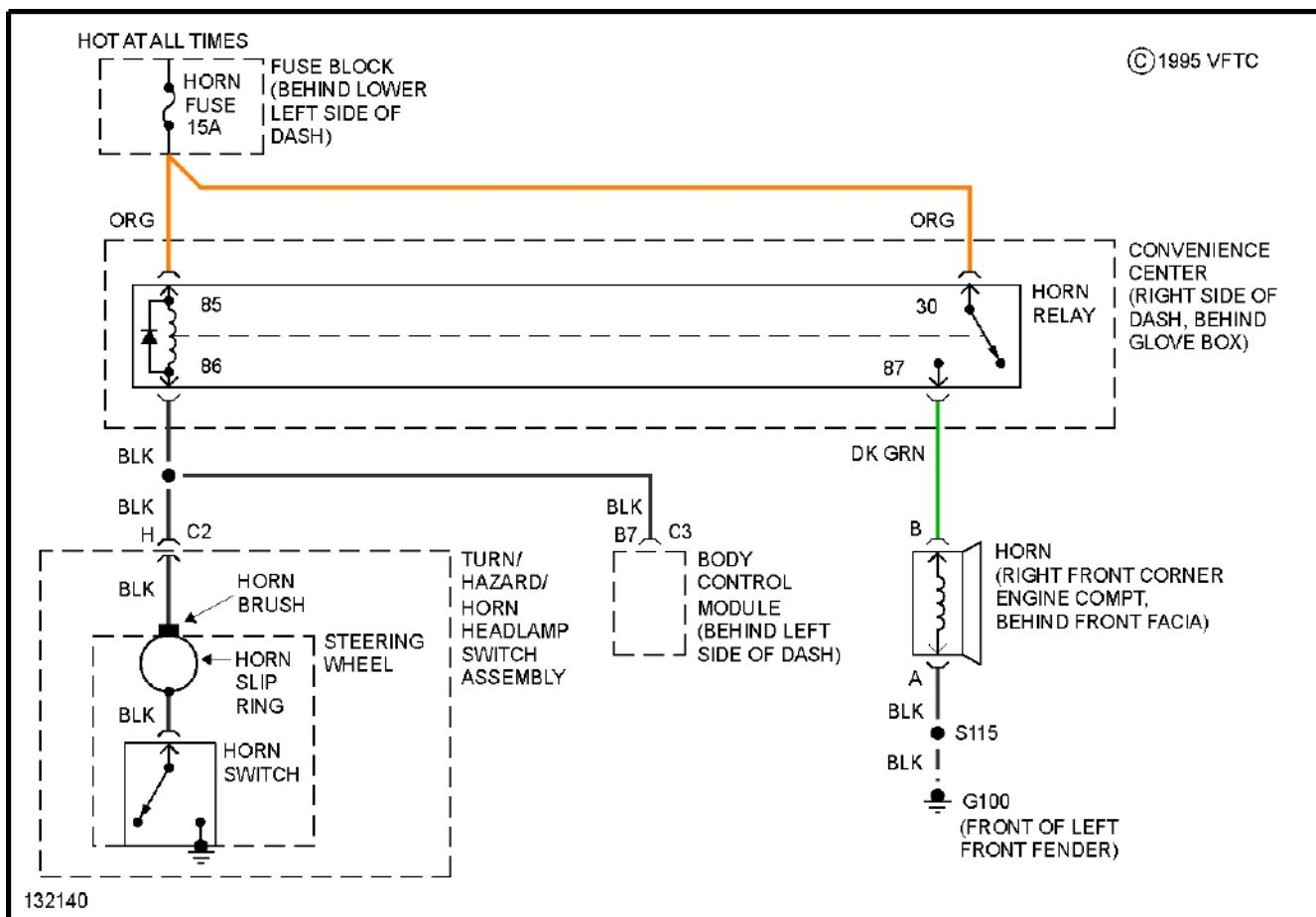
**Fig. 23: Horn Circuit**
