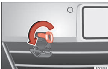
Fig. 71 En la parte derecha del parachoques delantero: enroscar la argolla de remolque.
