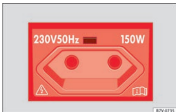
Fig. 193 Detalle de la consola central trasera: toma de corriente europea de 230 voltios.
