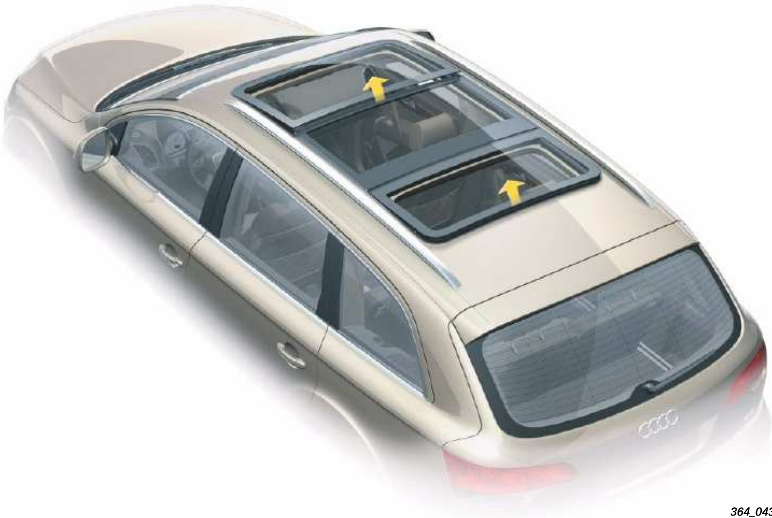
Techos de cristal 1 y 3 en posición deflectora
