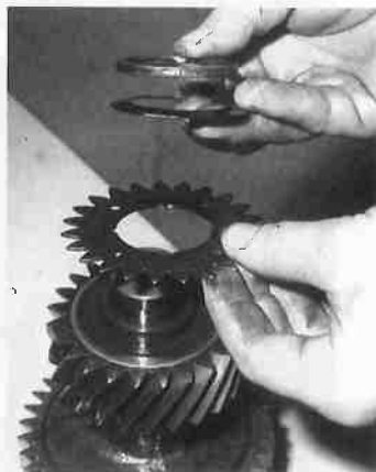
Montaje de los componentes del eje intermedio, respetando la orientación de la arandela elástica.
