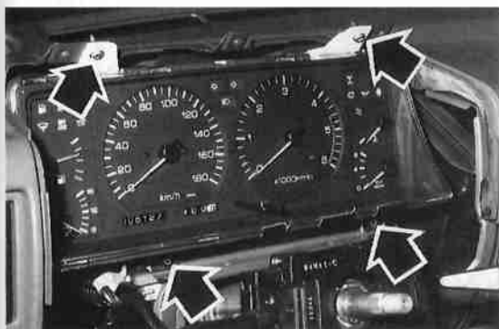
Tornillos de fijación del cuadro de instrumentos (Patrol GR).
