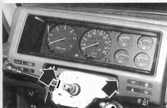
Tornillos de fijación de la cubierta del cuadro de instrumentos (Patrol 260).
