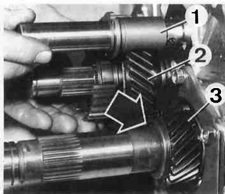
Montaje del piñón de 5ª - (3), orientar el resalte mayor (flecha) hacia atrás - Montaje simultáneo del eje del piñón de reenvío de marcha atrás - (1) y del piñón loco de 5ª (2)
