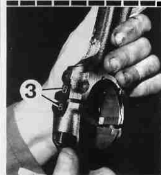
Marcas de biela y pistón 1. Surtidor de aceite - 2. Marca de diámetro del alojamiento de las cabezas de biela - 3. Marca del cilindro correspondiente.
