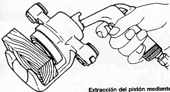
Extracción del pistón mediante aire comprimido.
