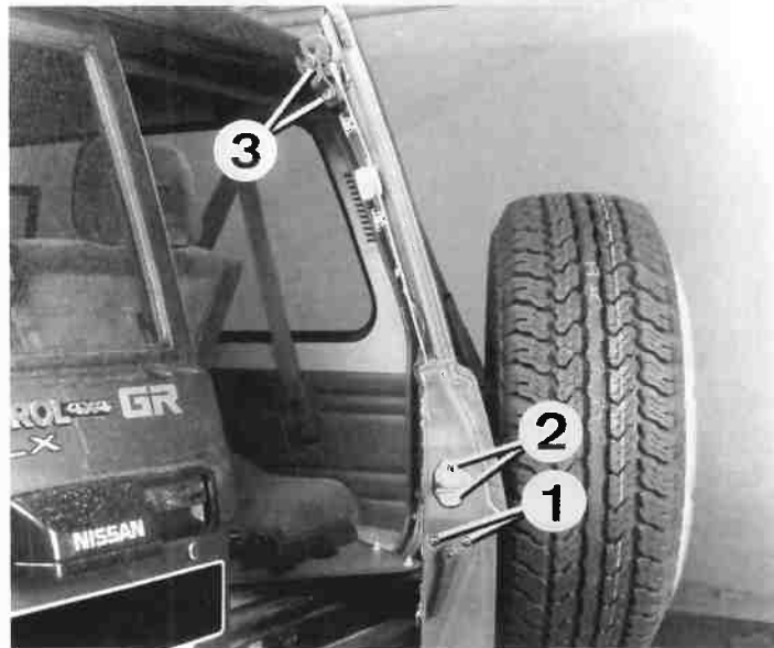
Desmontaje de un sistema de apertura de puerta trasera derecha del Patrol GR 1. Tornillos de fijación de la empuñadura - 2. Tornillos de fijación del gancho 3. Tornillos de fijación de la cerradura.
