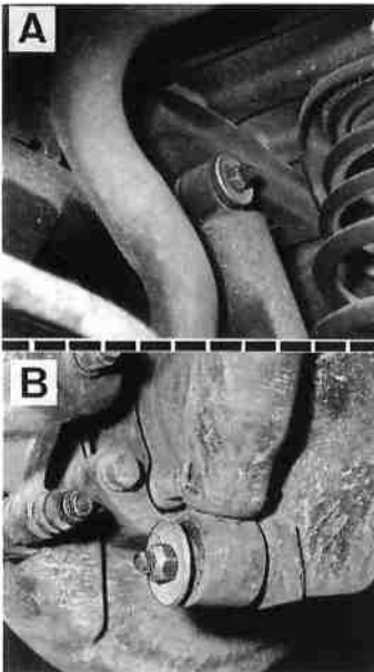
Fijaciones de un amortiguador (Patrol GR) A. Superior - B. Inferior.
