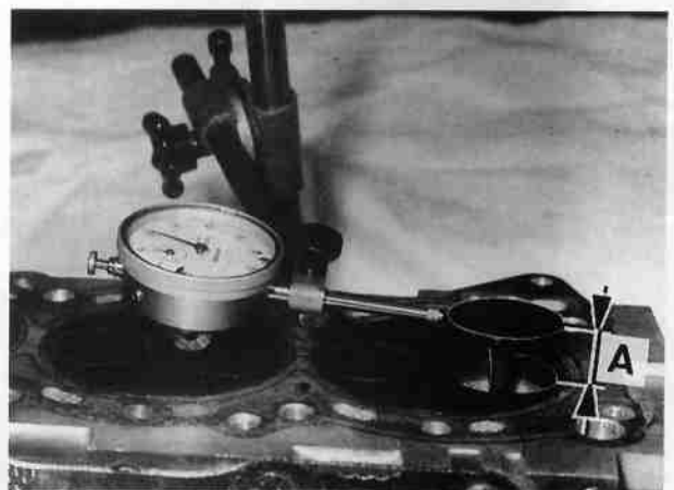
Control del juego guía-válvula A = 15 mm.
