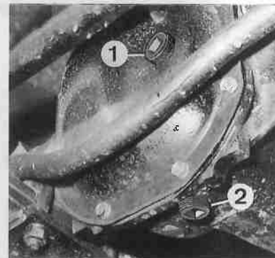
Situación de los tapones en el puente C 200 1. Llenado y nivel - 2. Vaciado.
