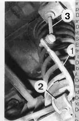
Desmontaje de la barra estabilizadora 1. Barra estabilizadora - 2. Cojinete - 3. Bieleta
