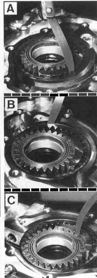
Control del juego radial A y B. Entre piñón exterior y cárter - C. Entre piñón interior y cárter.
