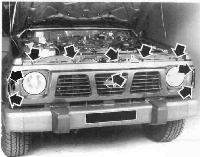
Grapas de fijación de la rejilla de calandra del Patrol GR.
