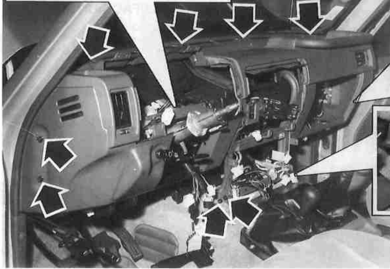
Tornillos de fijación del salpicadero (Patrol GR).
