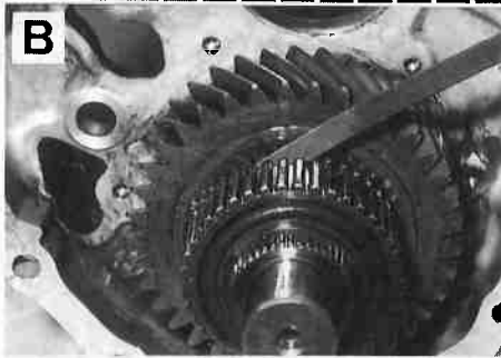
Elección de un segmento de bloqueo del eje primario.
