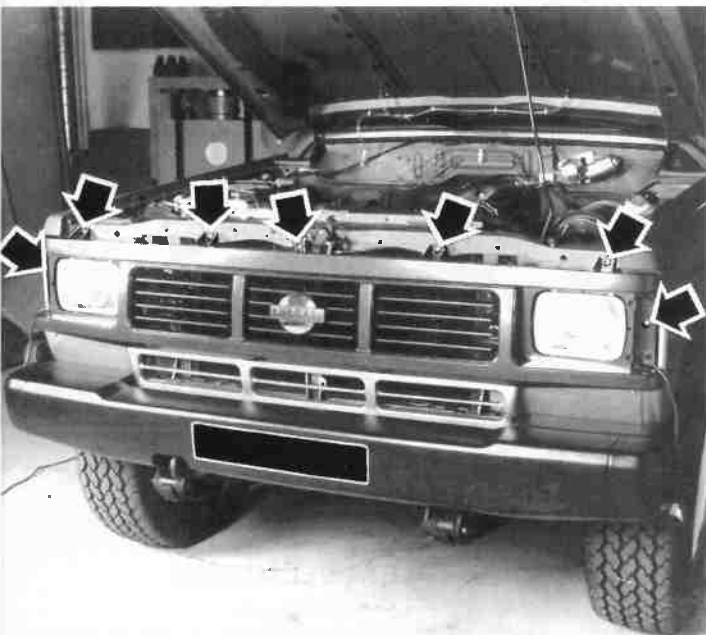
Grapas de fijación de la rejilla de calandra del Patrol 260.
