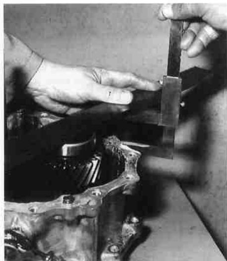
Medición de la altura del eje intermedio para determinar el calzo de reglaje.
