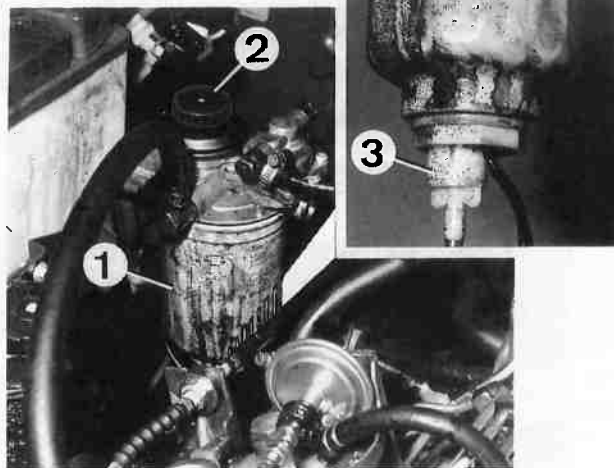
Purga del circuito de combustible 1. Filtro - 2. Bomba de cebado - 3. Grifo de purga del agua.
