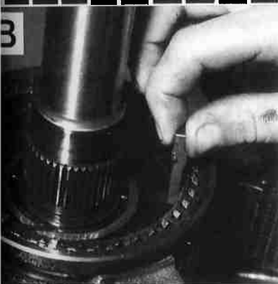
Montaje del mando de 4 ruedas motrices A. Orientación del manguito desplazable - B. Montaje de las chavetas de enclavamiento.
