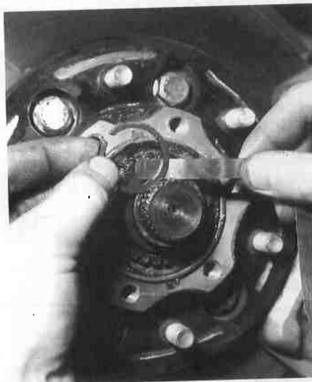
Selección del espesor del segmento de bloqueo del semieje.
