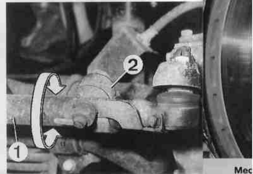
Reglaje del paralelismo 1. Barra de acoplamiento 2. Abrazadera de fijación.
