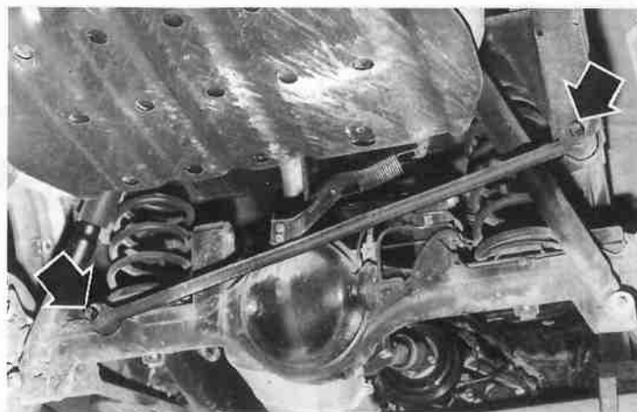
Tren trasero (Patrol GR) Flechas: Fijación de la barra transversal Panhard.
