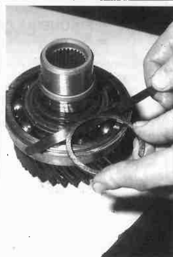
Elección de un segmento de bloqueo del eje primario.
