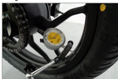
Desgaste radial de la rueda
