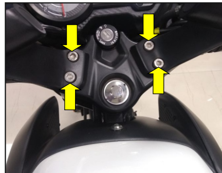
Pernos del Soporte del Manillar
