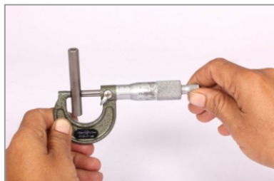
Díá. eje del balancín
