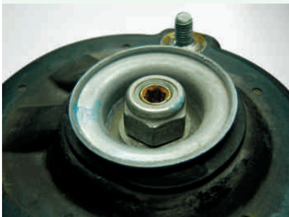
F7-Porca de fixação do coxim ao amortecedor
