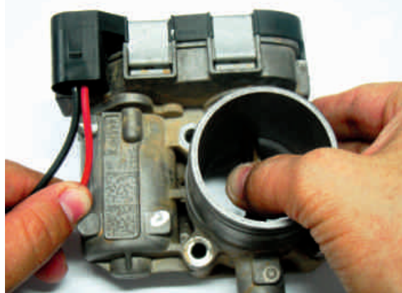
F3.2-Medição da resistência elétrica com a borboleta totalmente aberta
