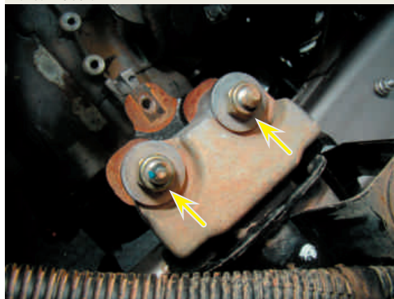
F12-Fixação superior do suporte da transmissão à carroceria
