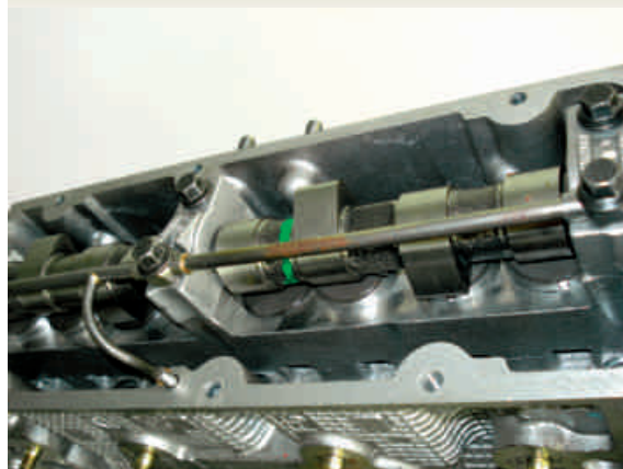
F7-Tampa de válvulas removida
