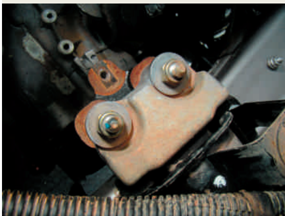
F16-Fixação superior do suporte da transmissão à carroceria
