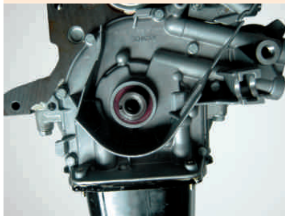
F4-Bomba de óleo instalada
