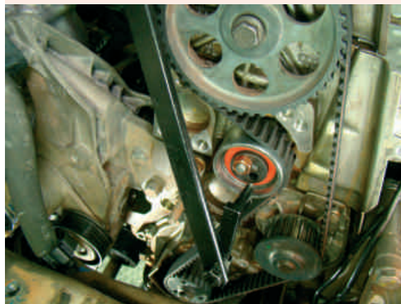
F23-Remoção cuidadosa da balança de tensionamento da correia dentada
