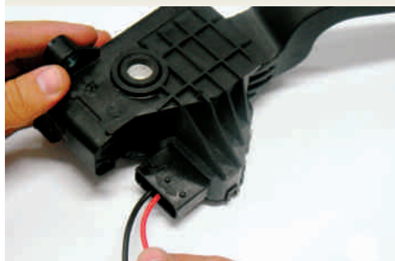
F.3.1-Medição da resistência elétrica da pista dos potenciômetros (pedal solto)
