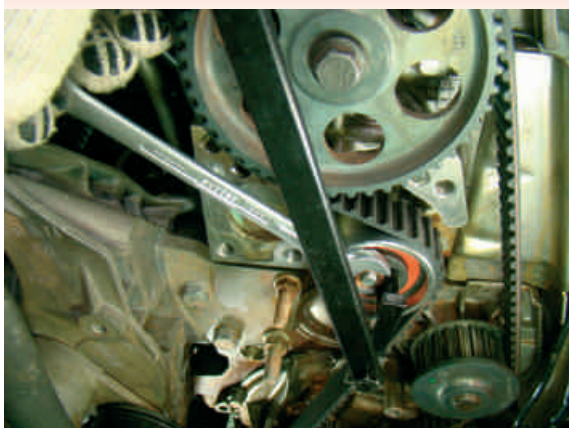
F22-Pré-aperto do parafuso de fixação do tensor da correia dentada
