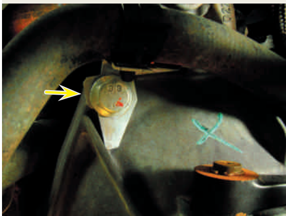
F4-Parafuso de fixação superior da transmissão ao motor
