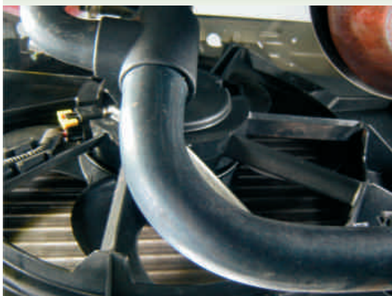
F5-Localização do eletroventilador
