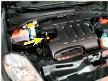
Localização do terminal elétrico do CKP
