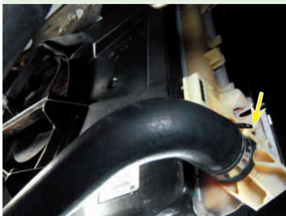
F7-Mangueira inferior do radiador
