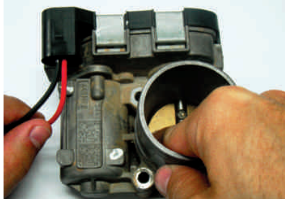
F3.1-Medição da resistência elétrica com a borboleta totalmente fechada
