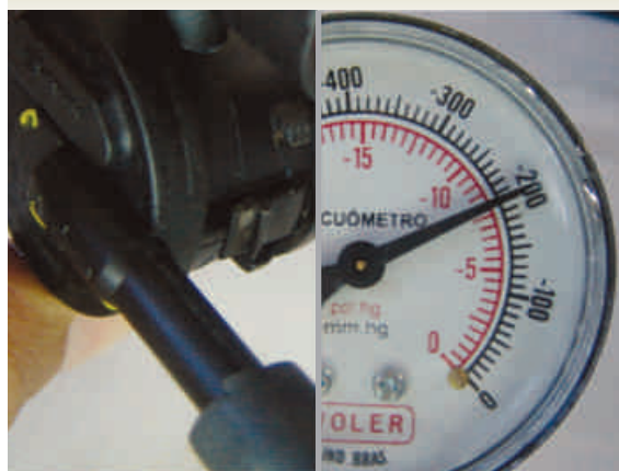
F.1.1-Bomba de pressão conectada à saída da CANP
