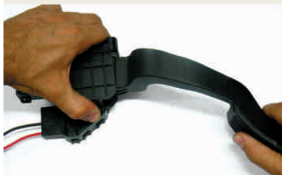
F.3.2-Medição da resistência elétrica da pista dos potenciômetros (pedal pressionado)
