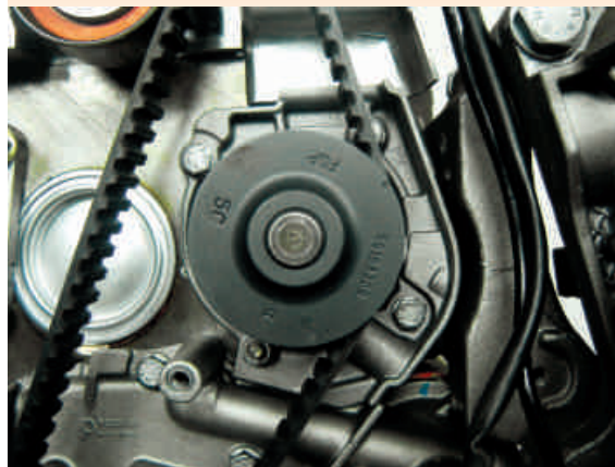
F1-Fixação da bomba d'água ao bloco do motor
