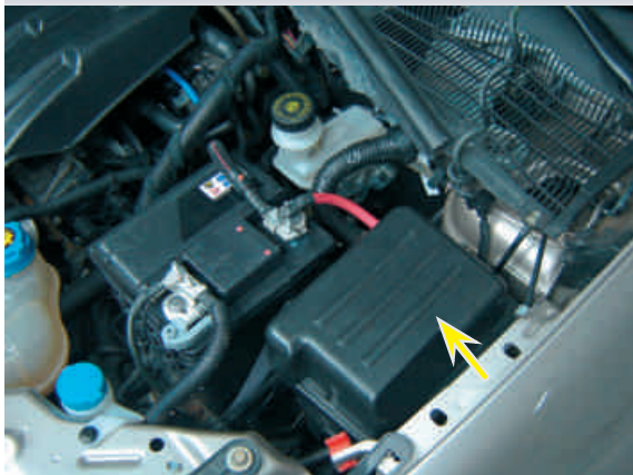
Localização dos fusíveis da (C.V.M)
