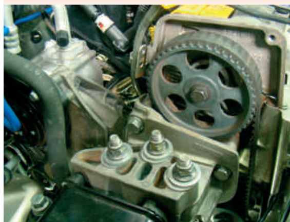
F32-Suporte frontal do motor reinstalado
