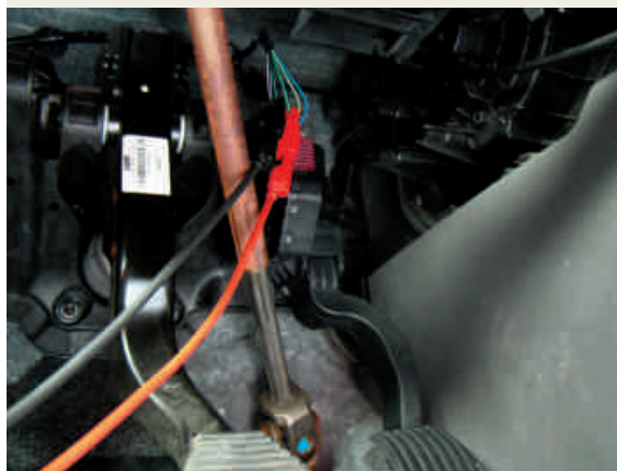
F.1.1-Medição da tensão de resposta dos potenciômetros do SPA (pedal solto)
