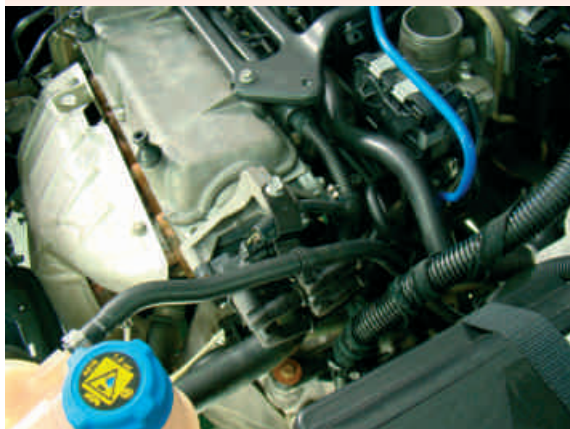
F31-Bobina de ignição e seu conector elétrico instalados
