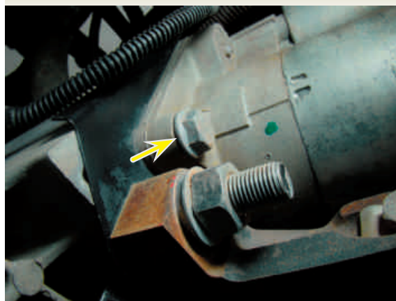
F6-Parafuso inferior de fixação do motor de partida
