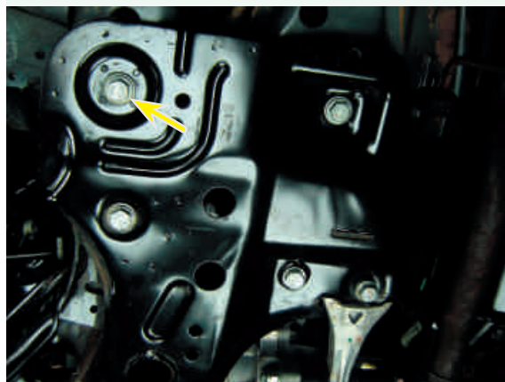
F12-Parafuso posterior de fixação do braço de controle ao quadro da suspensão
