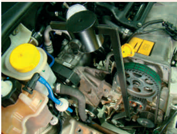
F20-Posição da balança de tensionamento automático da correia dentada
