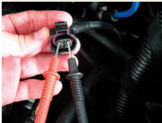
F2.1-Medição da tensão de alimentação
