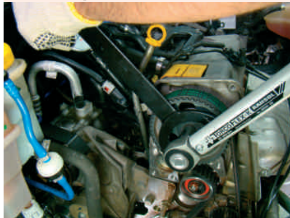
F25-A engrenagem do comando deve ser travada como um torque de 25 N.m
