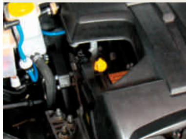
Localização do terminal elétrico do CKP
