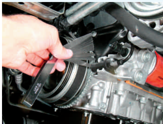
F.1.2 - Localização do terminal elétrico CKP.
