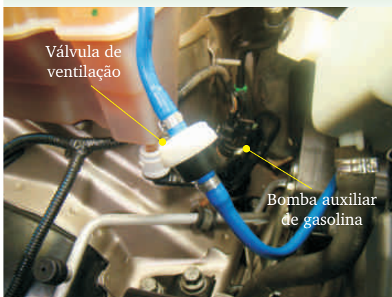
Bomba auxiliar de gasolina
