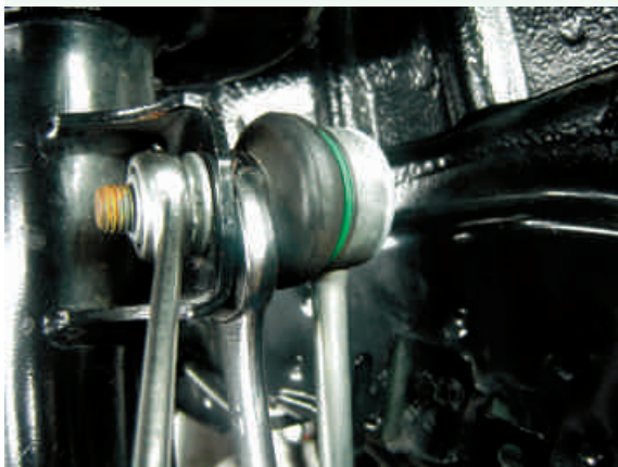
F13-Travamento do pino central da bieleta
