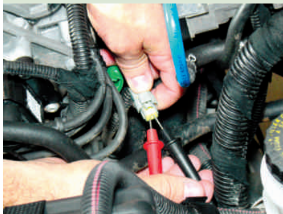
F.2.1-Tensão de alimentação do sensor ECT
