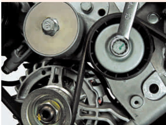
F3a-Alívio do tensor para remoção da correia de acionamento do alternador
