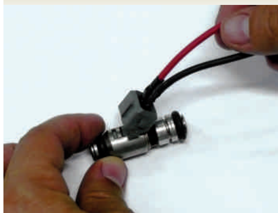
F.1.1-Teste da resistência do eletroinjetor
