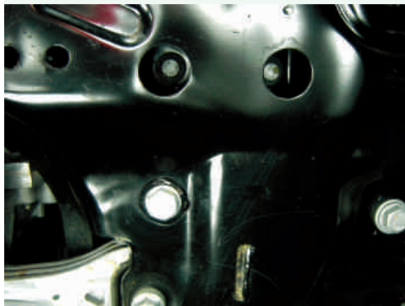
F15-Parafusos de fixação da barra estabilizadora ao quadro da suspensão
