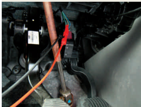
F1.1-Medição da tensão de resposta dos potenciômetros do SPA (pedal pressionado)
