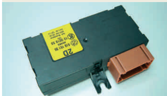
Central do vidro elétrico
