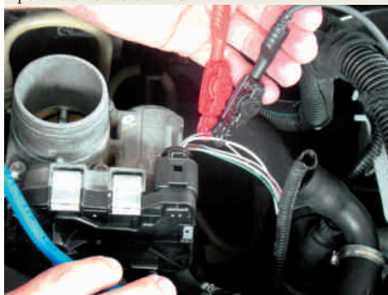
F1.1-Medição da resposta de tensão dos potenciômetros do ETC
