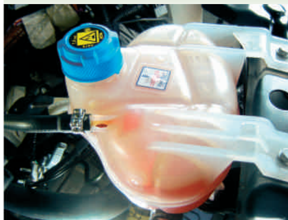
F6-Localização do reservatório de expansão
