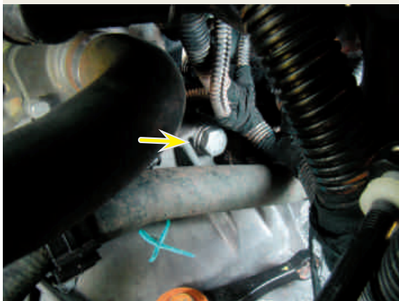
F5-Parafuso de fixação superior da transmissão ao motor
