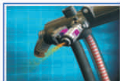
Injetor com pulverização deficiente
