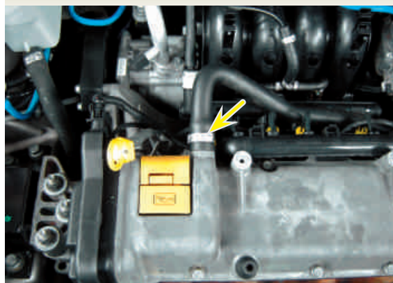
F2-Mangueira do blow-by na tampa de válvulas
