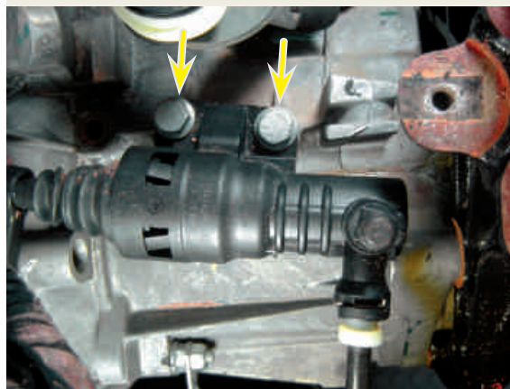
F2-Parafusos de fixação do cilindro de embreagem à transmissão
