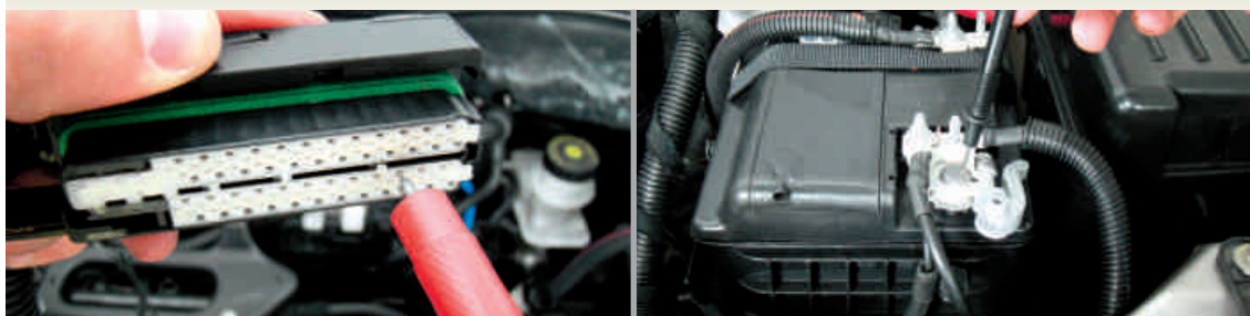
F.1.2-Medição da tensão de alimentação do MC (pós-chave)
