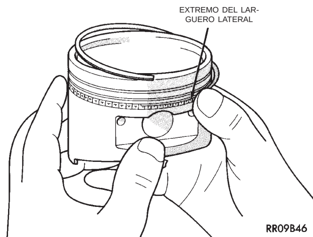
Fig. 9 Larguero lateral—Instalación
