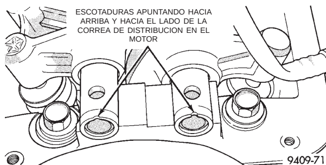
Fig. 35 Escotaduras del eje del brazo de balancín
