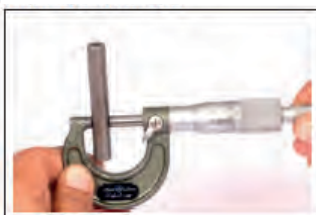
Diámetro externo de la horquilla selectora
