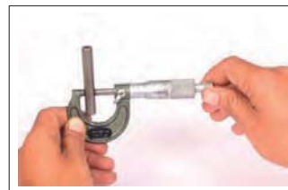
Diámetro eje de balancín
