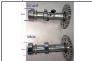
Altura eje de leva
