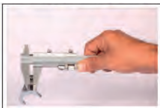
Diámetro de la guía de horquilla selectora
