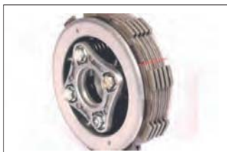
Altura de los discos de clutch apilados
