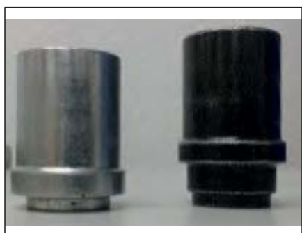
Herramienta para retirar y acoplar el retenedor de la bomba de agua y el balanceador
