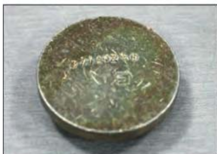
Herramienta de acople del sello de aceite del eje de salida
