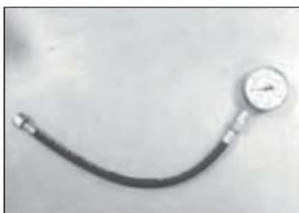
Herramienta para medir la presión en el cilindro
