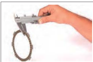
Espesor del disco de fricción
