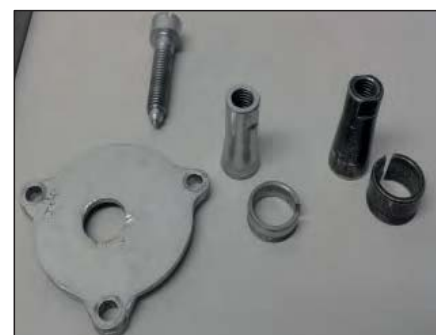
Herramienta para retirar y acoplar el retenedor de la bomba de agua y el balanceador
