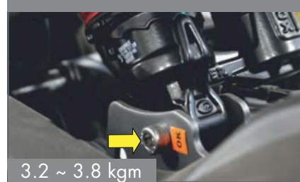
Tornillos caliper
