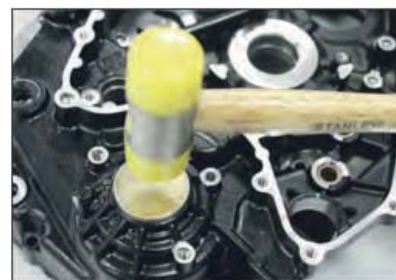
Herramienta de acople del sello de aceite del eje de salida
