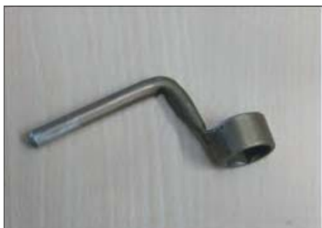
Herramienta para retirar el sensor de temperatura
