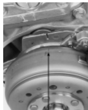
MARCAS DE AVANCE
