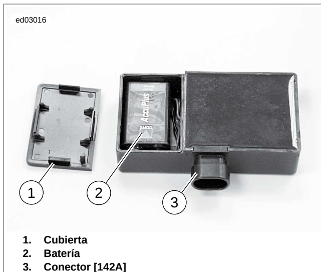
Figura 3-33. Compartimiento de la batería de la sirena (sirena de estilo anterior)
