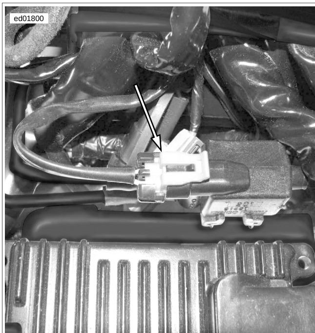
Figura B-14. Solenoide de purga [95] (debajo del asiento)
