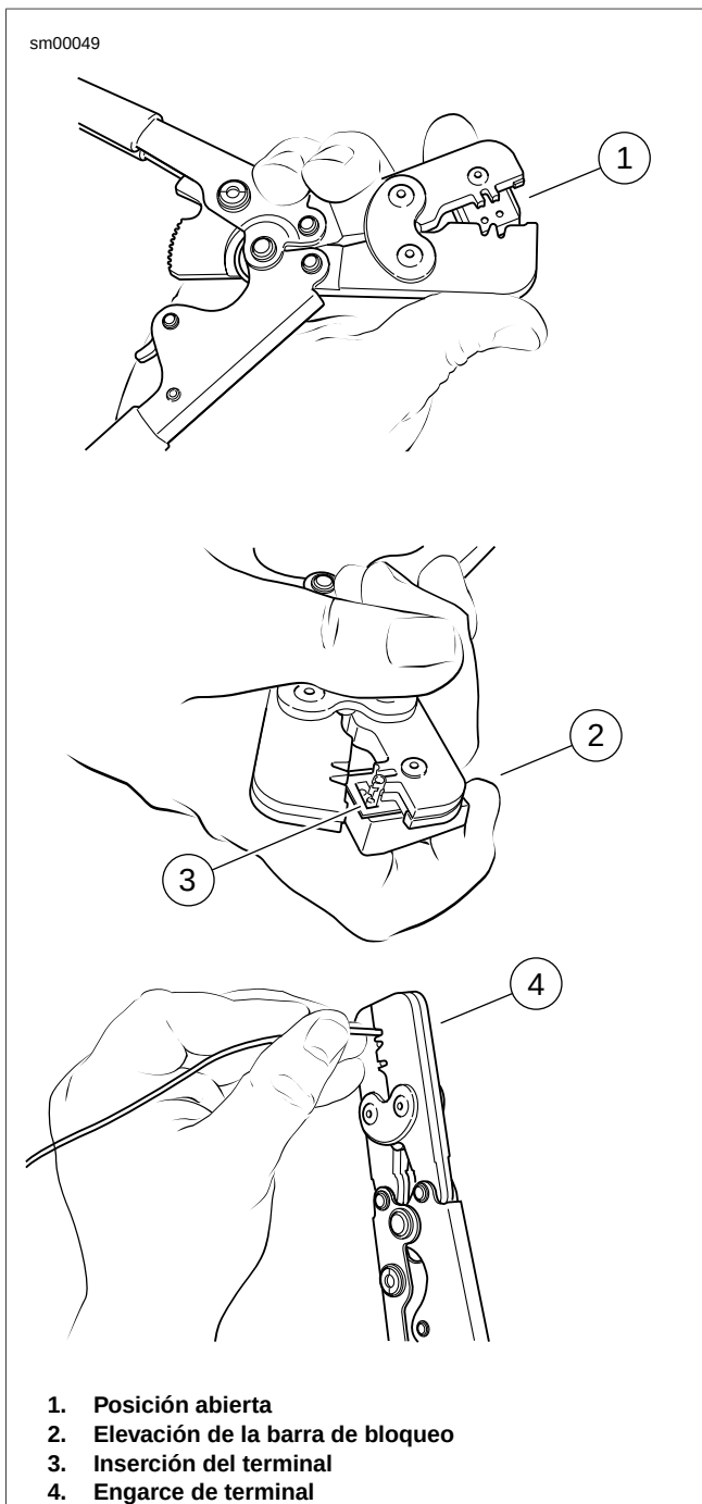
Figura A-46. Conector Packard Micro 64: Engarzador de terminal de entrada
