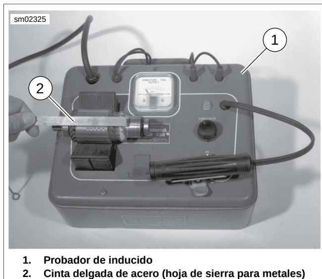
Figura 1-12. Prueba de la armadura en cortocircuito usando el probador de inducido
