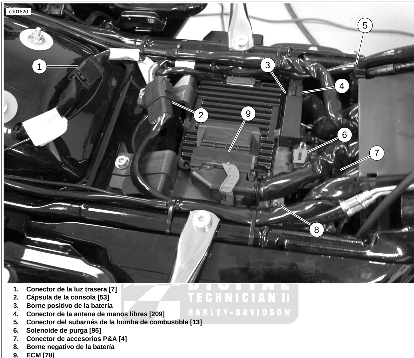
Figura B-6. Conectores eléctricos, debajo del asiento
