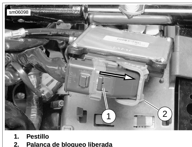
Figura A-38. Desacoplamiento del conector del ECM
