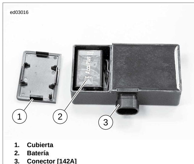
Figura E-31. Compartimiento de la batería (sirena de estilo anterior)
