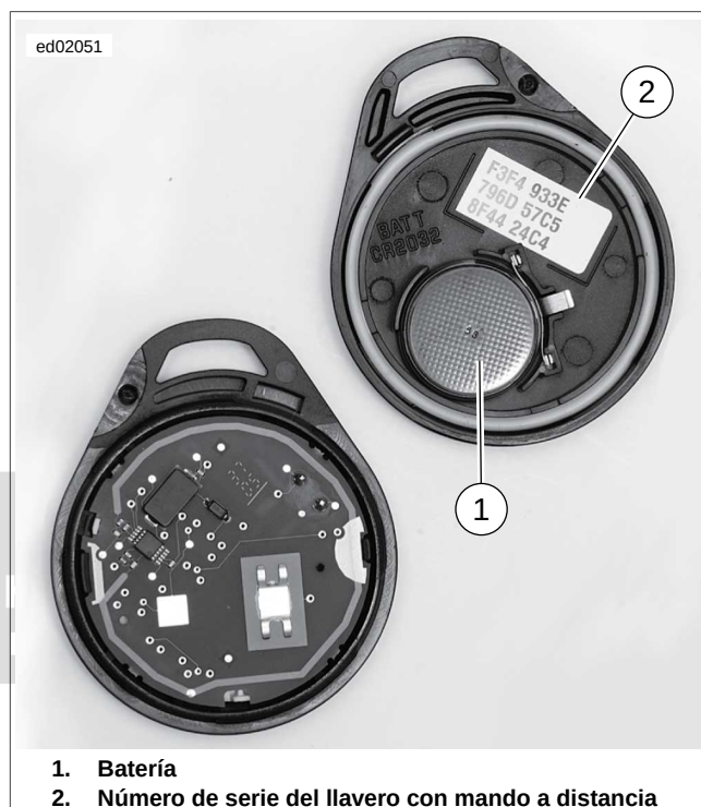
Figura 3-16. Llavero con mando a distancia abierto: HFSM
