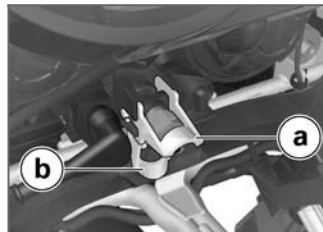
a Posición neutra b Posición con carga pesada
