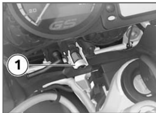
1 Ajuste del alcance de los faros
