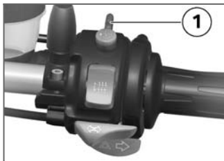
1 Interruptor de parada de emergencia
