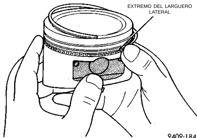
Fig. 82 Instalación del larguero lateral
