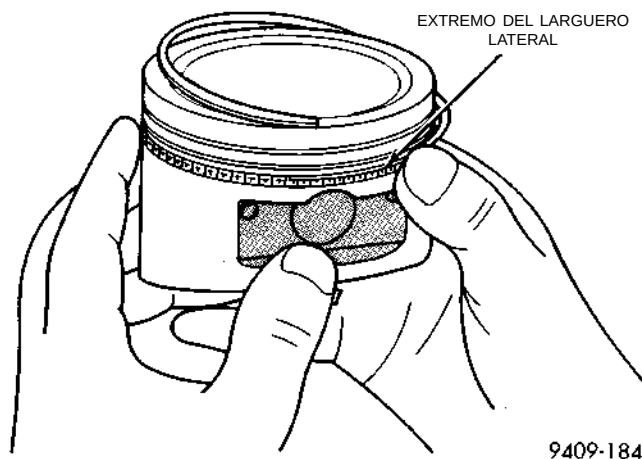
Fig. 82 Instalación del larguero lateral
