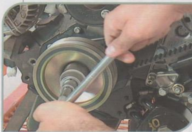
Remoção do parafuso da polia da árvore de manivelas
