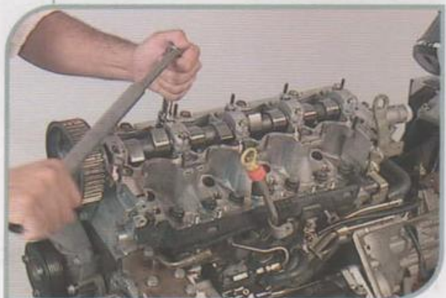
Remoção dos parafusos do cabeçote
