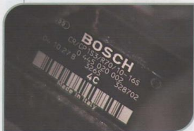
Etiqueta de identificação da bomba
