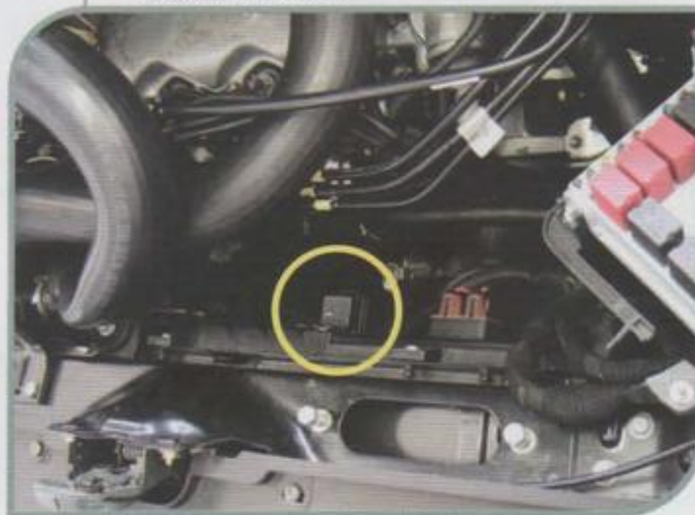
Localização do relé da velocidade alta do eletroventilador
