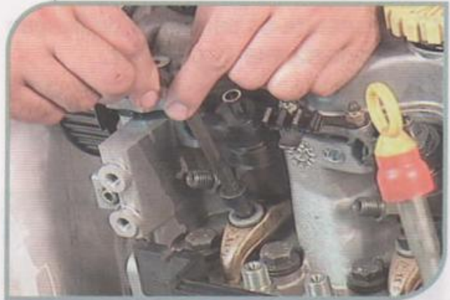
Remoção dos fixadores dos injetores
