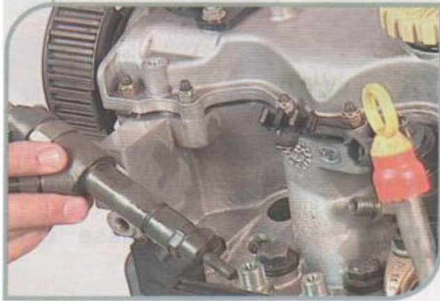
Remoção das porcas da tampa de válvulas
