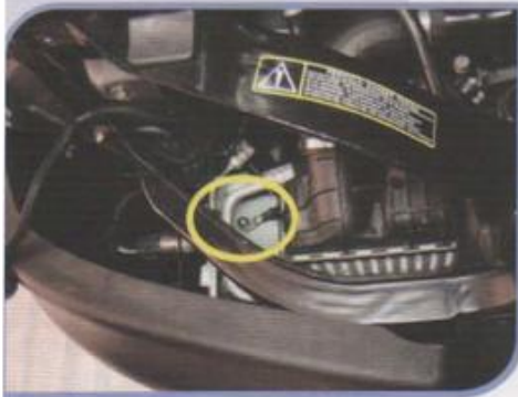
Eletroventiladores do radiador
