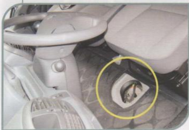
Localização da bomba de combustível
