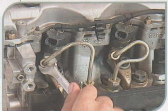
Conexões da tubulação de alimentação de combustível
