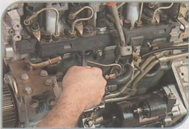
Tubulação da bomba ao Rail
