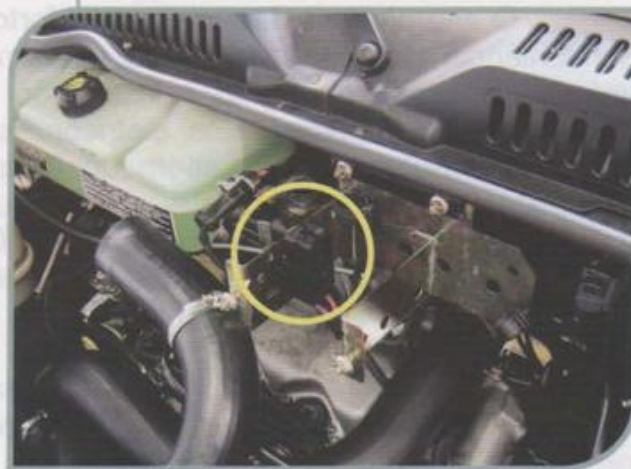
Localização do relé do termoviatore
