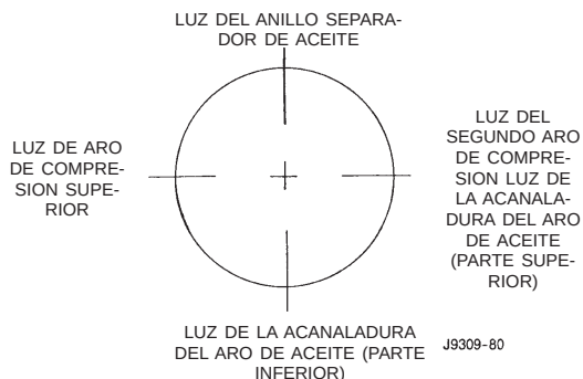
Fig. 50 Instalación correcta de los aros
