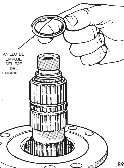
Fig. 74 Instalación de la arandela de empuje del eje del embrague
