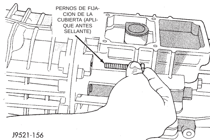
Fig. 103 Instalación de los pernos de fijación de la cubierta
