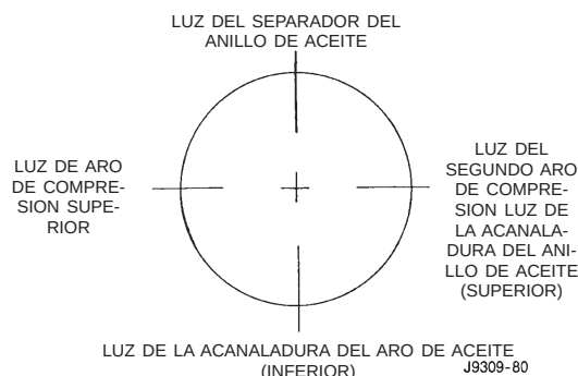
Fig. 52 Instalación correcta de los aros
