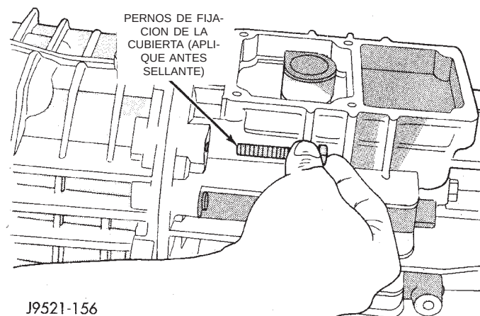
Fig. 95 Instalación de los pernos de fijación de la cubierta
