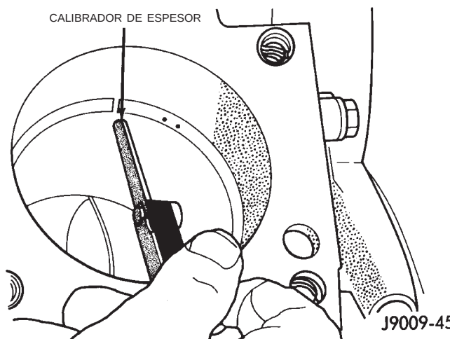
Fig. 64 Medición de la luz entre puntas de aro
