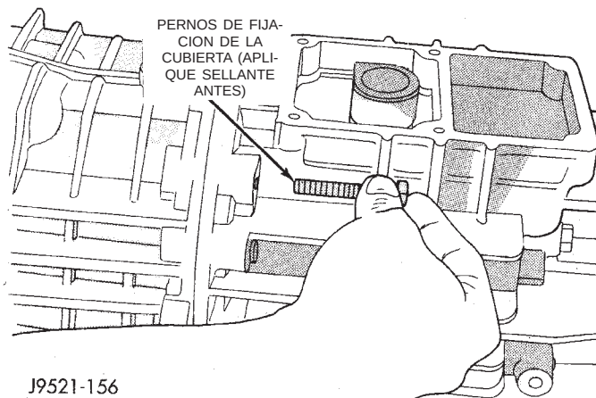
Fig. 122 Instalación de los pernos de fijación de la cubierta
