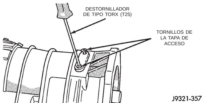
Fig. 235 Instalación de la tapa de acceso y la junta del anillo de posición
