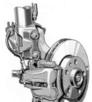
adherencia, que al producirse la fricción entre los mismos permiten frenar el giro de las ruedas y decelerar la velocidad de marcha del vehículo.
