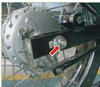
Tuerca eje trasero 8-10 Kg.-m
