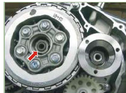
Tuerca clutch (rosca izquierda) 4.5 Kg.-m
