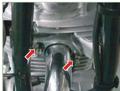
Tuercas silenciador 2-2.2 Kg.-m
