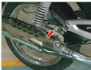
Tornillo silenciador 3.5-4.0 Kg.-m
