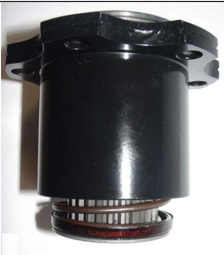
Conjunto de leva y seguidor
