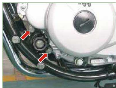
Soportes de motor M8 2.2 Kg.-m M10 2.4 kg.-m
