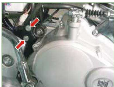
Soportes de motor M8 2.2 Kg.-m M10 2.4 kg.-m
