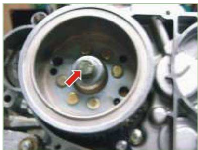
Tornillo rotor 4.5 Kg.-m
