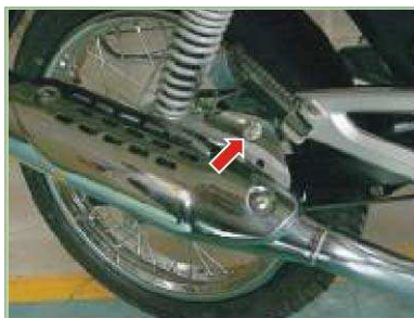
Tornillo silenciador 3.5-4.0 Kg.-m
