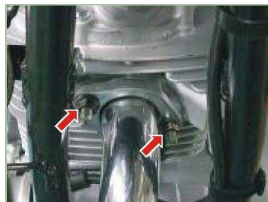
Tuercas silenciador 2-2.2 Kg.-m
