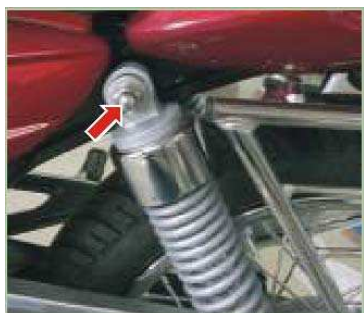
Tuerca amortiguador Trasero Arriba 3.5-4.0Kg.-m Abajo 2.7-3.0kg.-m
