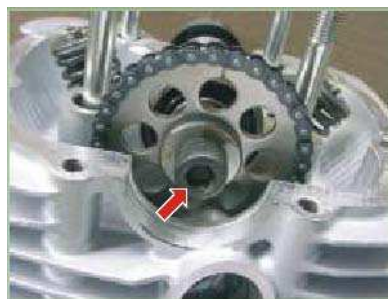
Tornillo arbol de levas 1.5 Kg.-m
