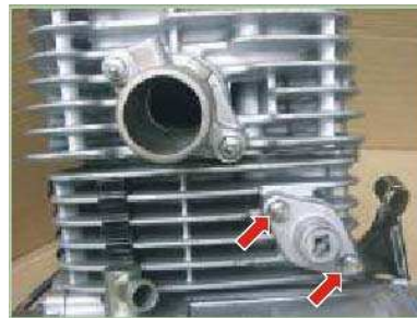
Tornillo tensor cadena 1.1 Kg.-m
