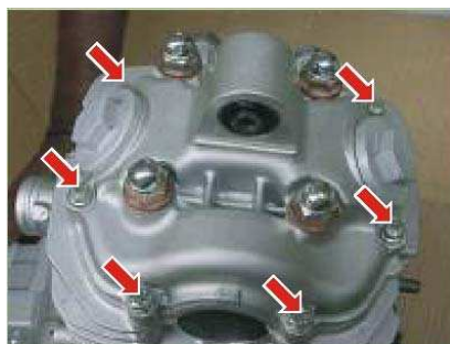
Tornillo tapa cabeza 1.1 Kg.-m
