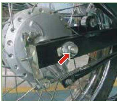
Tuerca eje trasero 8-10 Kg.-m
