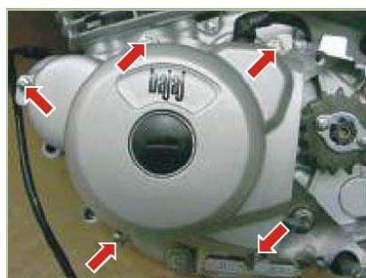
Tornillos tapa magneto 1.1 Kg.-m
