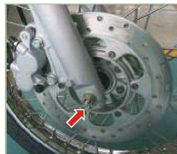
Tuerca eje delantero 4-5 Kg.-m
