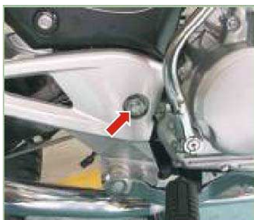
Tuerca eje basculante 8.0-10.0 Kg.-m
