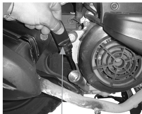
Medidor nivel de aceite
