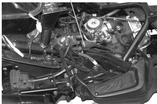
Cable conector del generador de C.A.
