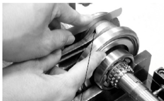
Separación de la biela del cigüeñal
