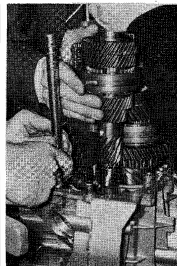
Colocación de los ejes con las horquillas y sus ejes en el cárter de embrague.
