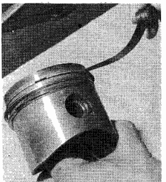
Control del juego en la ranura de los segmentos.
