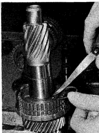
Medición del espesor de un anillo de sujeción a montar: sumar el espesor de la arandela a la del anillo utilizado. Montar un anillo del espesor inmediatamente inferior.
