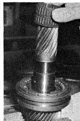
Desmontaje del rodamiento de agujas del piñón loco de 4ª.
