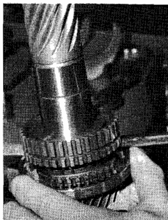
Desmontaje del cubo de sincronización de 3ª-4ª.
