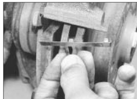
2.5 Extracción del resorte de retención de la pastilla
