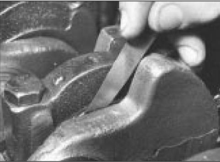
15.3 Comprobación de la holgura axial del cigüeñal en el cojinete principal nº 3
