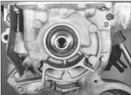
31.4 Ubicación montada de la bomba de aceite
