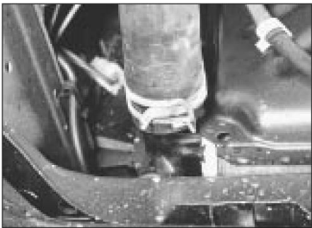
2.4a Conexión de manguera inferior del radiador - 1,3 litros
