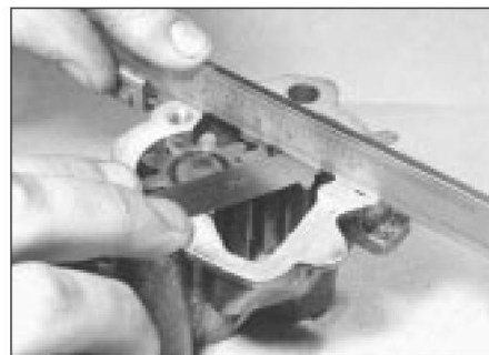
25.4 Comprobación de la holgura axial del engranaje de la bomba de aceite
