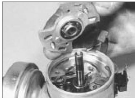
16.3 Desmontaje de la placa de soporte - 1,05 y 1,3 litros
