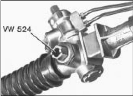
16.8 Ajuste del mecanismo de dirección asistida – usar herramienta VW
