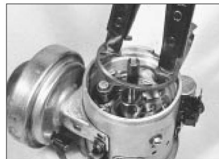
7.10b Extracción del anillo de retención de la placa de rodamiento
