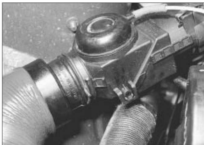
4.1 Unidad de aspiración del filtro de aire
