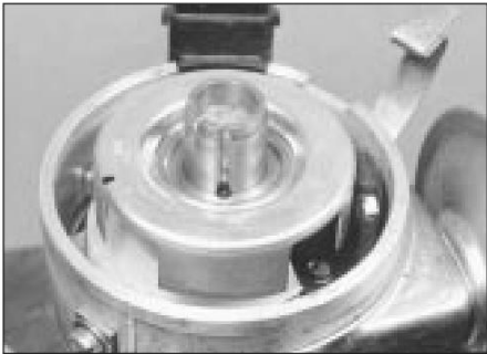
7.13 Alinee la muesca del rotor con la ranura del eje al volver a montar
