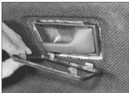
14.2 Desmontaje del marco interior de la manija de la puerta
