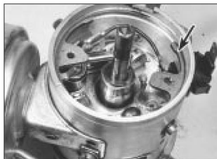
7.10a Posición de montaje correcta del anillo de retención de la placa de soporte
