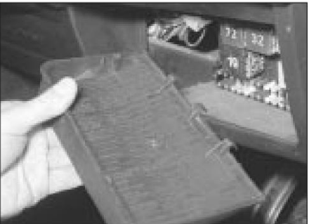
3.1 Extracción de la cubierta de la unidad de fusible/relé
