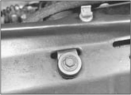
3.5 Perno de retención central y soporte del radiador
