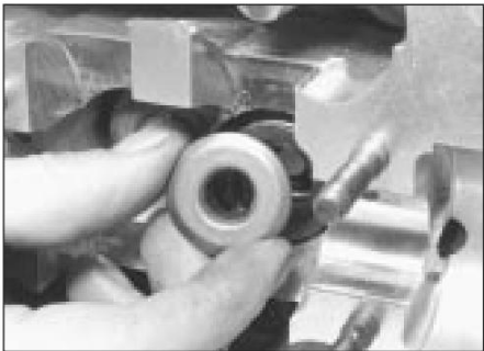
5.10 Desmontaje del asiento superior del resorte de válvula
