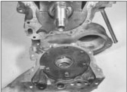
16.4a Desmontaje de la bomba de aceite. . .
