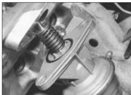
11.7a Montaje de la bomba de combustible
