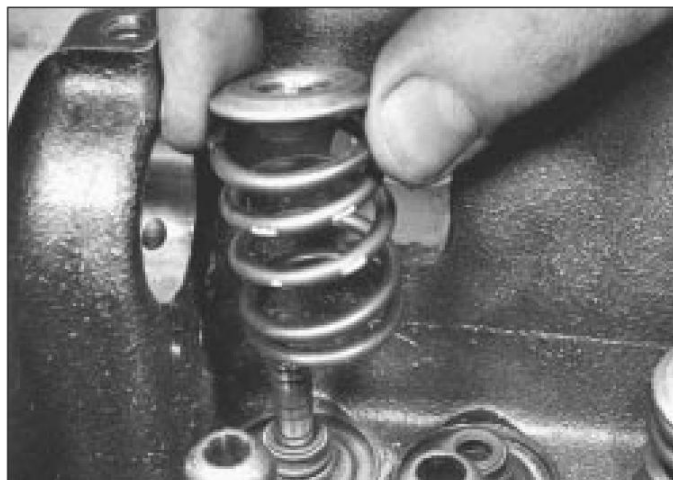
11.2b Extracción de resortes y retenedores de válvulas. . .
