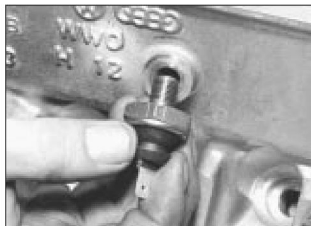
11.3 Reposición del presostato de aceite
