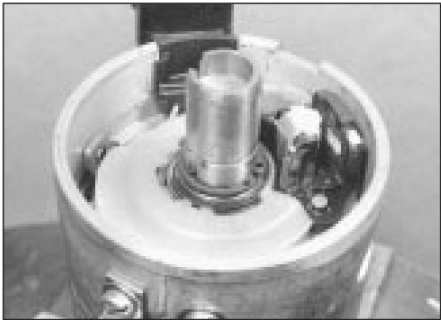
7.7 Sensor Hall, anillo de retención y arandelas
