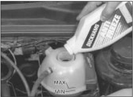
2.13 Relleno de refrigerante del motor
