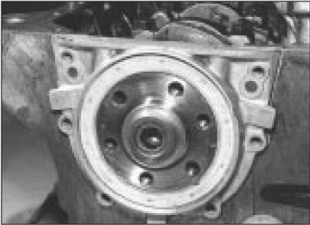
30.9 Montaje del retén de aceite trasero y de la brida del cigüeñal
