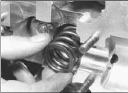
5.11a Extracción de un resorte de válvula exterior
