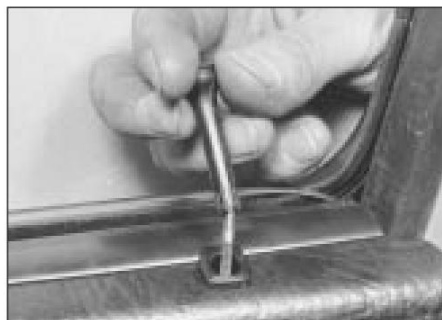
14.1 Destornillar el pomo de bloqueo de la puerta
