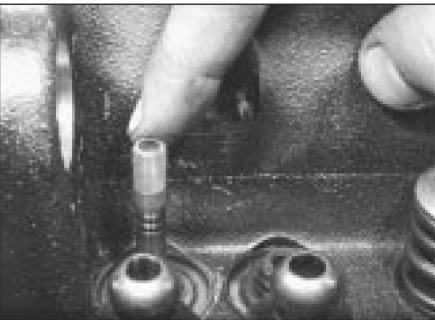
34.3 Ubique la funda de plástico en el vástago de la válvula. . .
