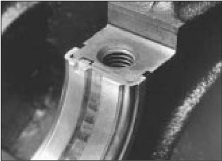
30.3f Asegúrese de que los extremos del rodamiento estén al ras con la cara de la junta
