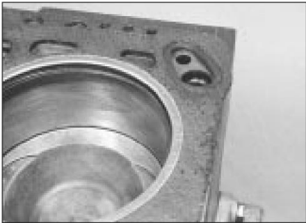
36.2 Montaje correcto de la junta de culata
