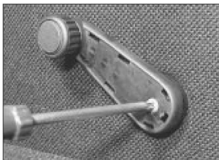
14.4b. . . y tornillo de retención del mango
