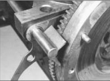
13.2 Un método para mantener estacionario el volante
