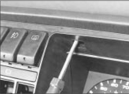
18.6b Retire los tornillos de sujeción del panel de instrumentos en la parte superior.
