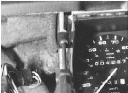
16.3 Extracción de tornillos del panel de instrumentos
