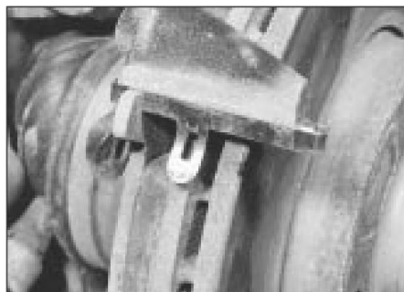
2.9 El resorte de retención de la pastilla está ubicado como se muestra
