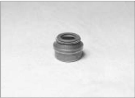
5.17 Un sello de aceite del vástago de la válvula
