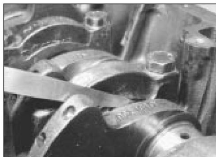
18.3 Comprobación de la holgura axial del cigüeñal
