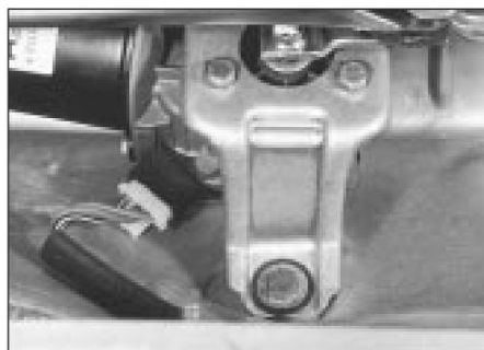
27.4 Motor del limpiaparabrisas que muestra la conexión de enchufe múltiple y los pernos de retención
