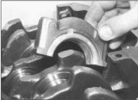
30.5 Montaje de tapas de cojinete de bancada
