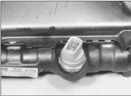
7.3 Termointerruptor del ventilador de refrigeración
