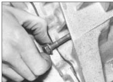
6.6a Afloje los pernos de fijación (se muestra el perno empotrado). . .
