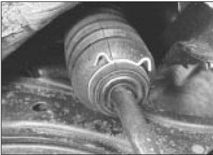
14.4 Fuelle del tirante de dirección y clip de retención
