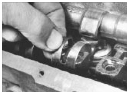
10.8 Eliminación de un clip de seguidor de cámara
