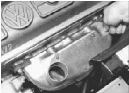
11.20 Montaje de la cubierta de aire caliente
