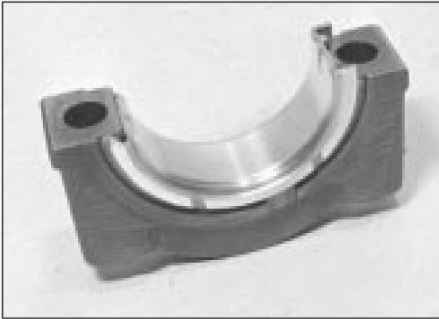
30.3d Montaje del cojinete principal central tipo brida en la tapa
