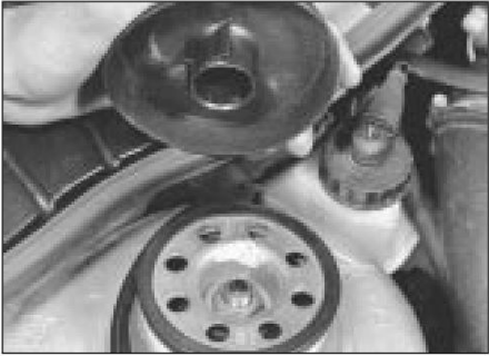
2.3 Desmontaje de la tapa superior del puntal de la suspensión delantera
