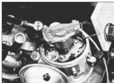
7.6b Brazo del rotor alineado con la marca PMS en el cuerpo del distribuidor
