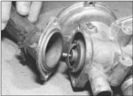
5.11b. . . Retire el codo del termostato. . .
