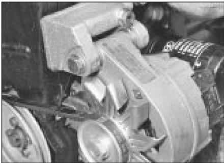
7.3 Perno de pivote y soporte del alternador - 1,3 litros
