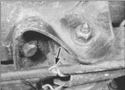
14.6 Clip de retención del cable del freno de mano (flecha) en el pivote de la viga del eje trasero
