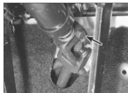
12.7 Junta universal de la columna de dirección (superior). Perno de abrazadera con flecha
