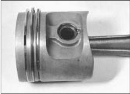
23.7a Espacios entre anillos espaciados a intervalos de 120°
