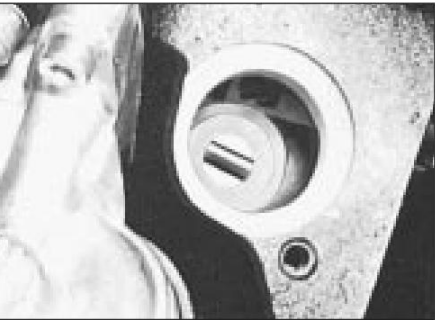
7.22 Posición del grifo de accionamiento de la bomba de aceite antes de volver a montar el distribuidor
