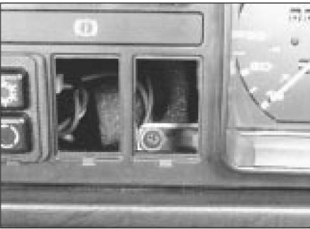
18.6a Tornillo de retención del panel embellecedor del salpicadero a través de la abertura de control del atenuador
