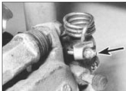
2.15 Soltar el cable del freno de mano (flecha) de la pinza
