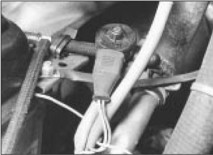
20.6 Unidad emisora del indicador de consumo de combustible
