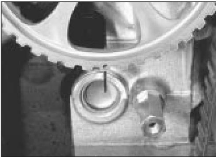
35.9 Piñón del árbol de levas (tipo posterior) con marca de índice alineada con el indicador de PMS de la tapa de distribución
