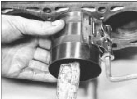
30.4 Uso de un compresor de anillos de pistón
