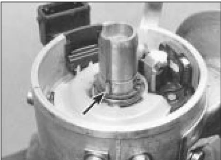
7.4b. . . y pasador de ubicación de la ranura del eje (flecha)
