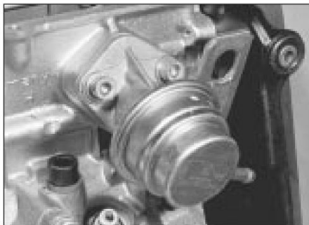
5.1 Ubicación de la bomba de combustible - 1,3 litros
