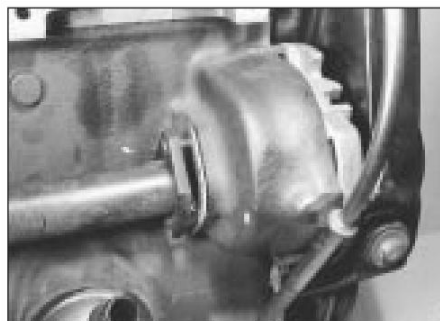
8.1d Desmontaje del tubo de refrigeración trasero del motor
