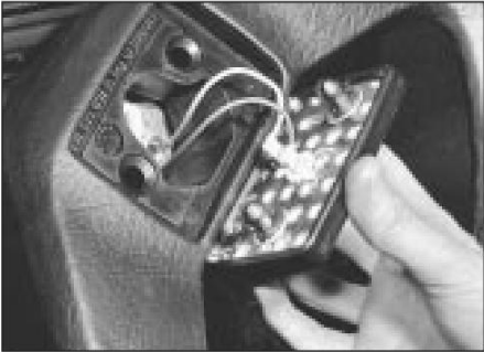
11.3a Desmontaje del centro del volante tapa – 1,3 litros
