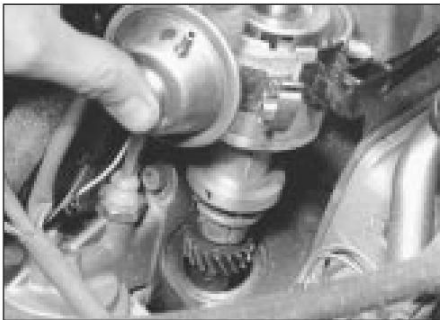
6.6a Desmontaje del distribuidor - motor de 1,8 litros
