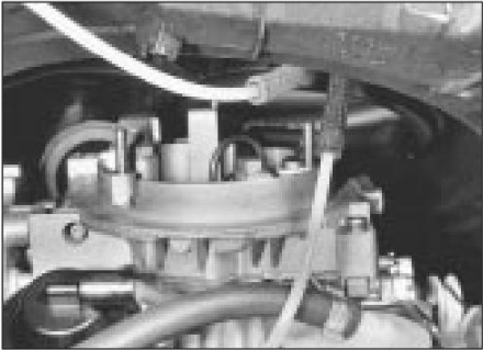
3.3a Desconexión del sensor de temperatura manguera . . .
