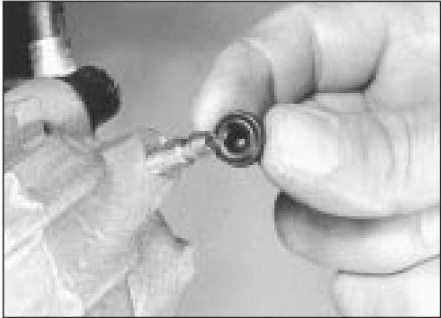
12.23 Montar la válvula de purga en el tapón protector.
