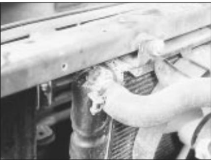
Las fugas de anticongelante suelen dejar un depósito cristalino como este.
