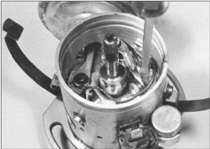
16.10b Ajuste de la separación de los puntos del interruptor de contacto
