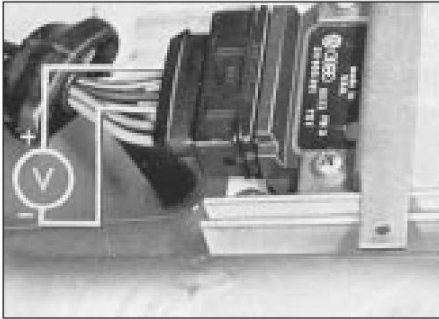
5.4 Conexión del voltímetro durante la prueba emisor de pasillo
