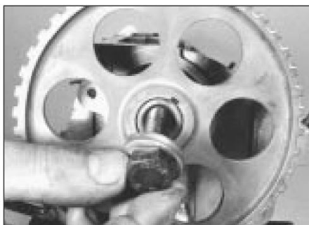
10.10 Extracción del perno de la rueda dentada del árbol de levas (se muestra la rueda dentada del tipo anterior)
