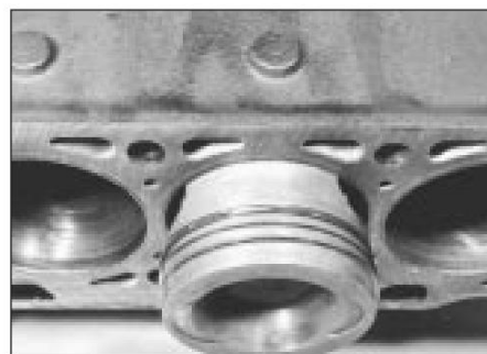
17.8 Desmontaje de un pistón
