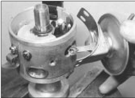
7.5 Desmontaje de la unidad de vacío
