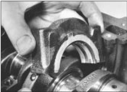
29.4 Montaje de la tapa del cojinete de bancada central
