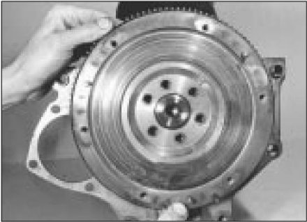
13.3 Desmontaje del volante
