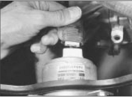
3.3b Desconectar el conector del cable del ventilador de refrigeración
