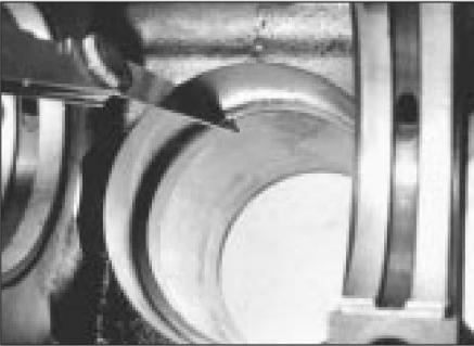
23.6 Comprobación de la holgura de los aros del pistón
