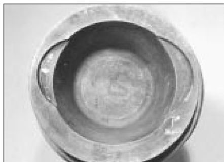
17.5 Corona del pistón que muestra la flecha que apunta al extremo de la correa de distribución del motor
