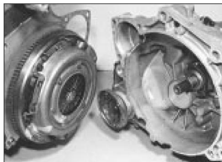
6.6b. . . Luego separe el motor y la transmisión.
