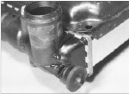
3.13 Goma de montaje inferior del radiador
