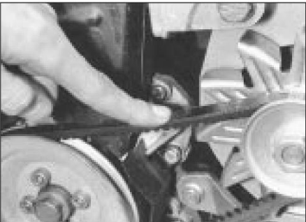
13.2 Comprobación de la tensión de la correa de transmisión del alternador
