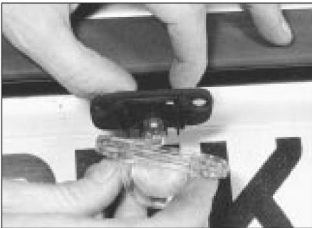
8.10 Extracción de la lente de la matrícula
