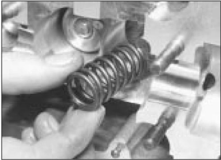
5.11b Extracción de un resorte de válvula interior
