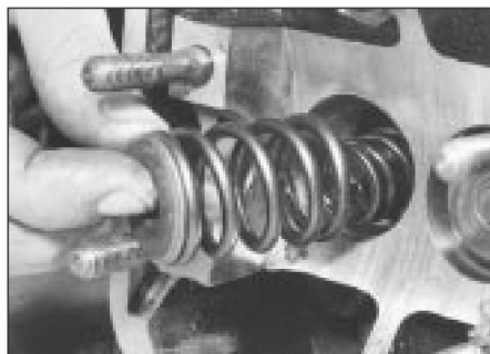
12.12b Ubicación de los resortes y la tapa de las válvulas. . .
