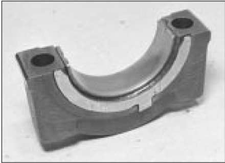
30.3e Montaje del cojinete central y arandelas de empuje separadas en la tapa
