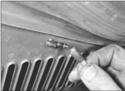
6.3 Desconexión de los tubos del lavaparabrisas del capó
