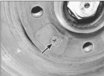
4.5 Tornillo de retención del disco de freno delantero (flecha)
