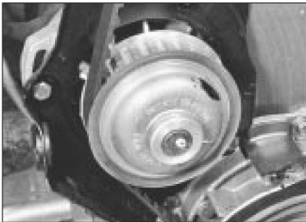
6.5 Desenganche la correa de distribución del piñón de la bomba de refrigerante
