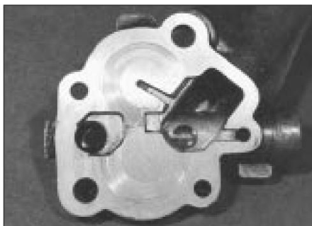
25.2 Examine la cara de la cubierta de la bomba de aceite para ver si hay rayas.
