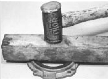
14.16 Instalación del nuevo sello de aceite trasero del cigüeñal
