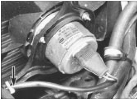
3.15 Asegure el cable del ventilador con un clip de plástico (flecha)
