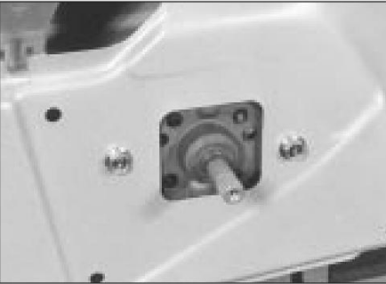
20.3a Pernos de fijación del elevalunas
