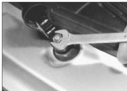
26.2 Aflojar la tuerca del brazo del limpiaparabrisas...
