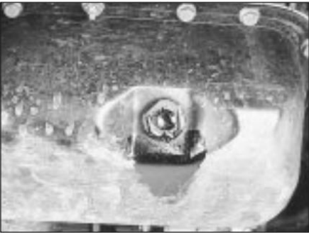
El aceite del motor puede perderse por el tapón de drenaje...
