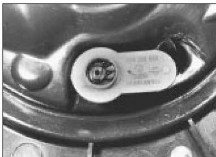
4.5 Vista superior del sensor de temperatura del aire - 1,3 litro
