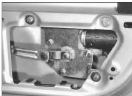
28.4b Montaje del motor del limpiaparabrisas trasero en el portón trasero
