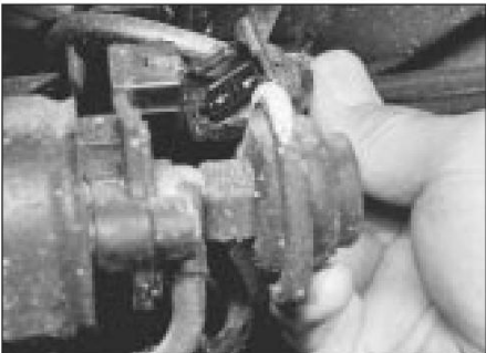
19.4 Desconexión del conector del cableado de la bomba de combustible
