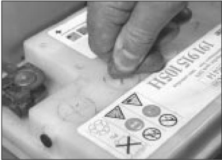
7.3a Retire los tapones de llenado de la batería. . .
