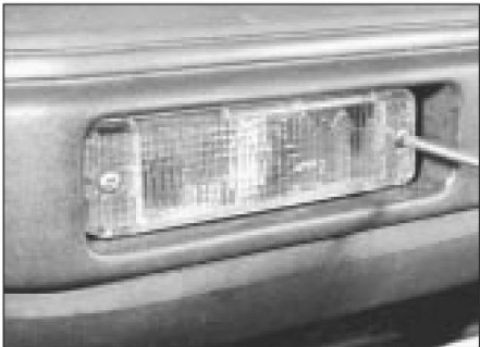
8.4 Extracción de la lente del intermitente delantero
