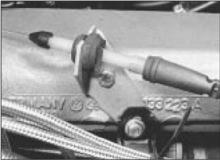
8.10 Regulador del cable del acelerador y soporte
