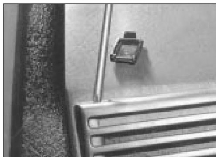
14.7a Retire los topes (cuando sea necesario) para acceder a los tornillos del panel de moldura.
