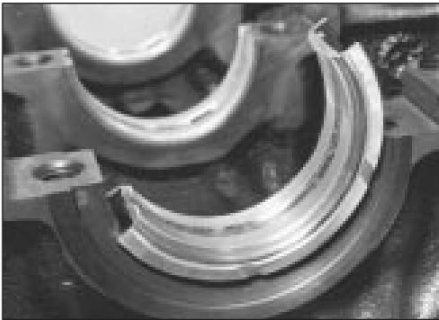
30.3a Montaje del cojinete principal central tipo brida en el cárter
