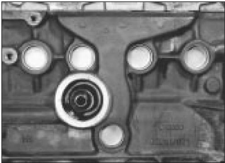
22.6 Tapones de núcleo en el bloque de cilindros
