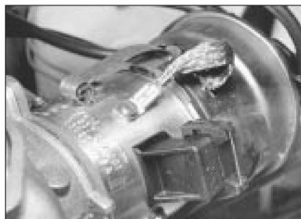
11.10 Montaje de la tapa del distribuidor y del cable de masa
