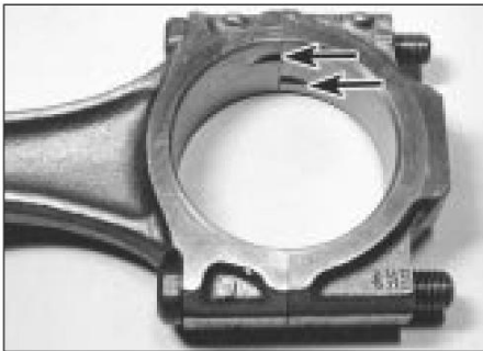
30.3 Ubicación correcta de las pestañas en los cojinetes de cabeza de biela (flecha)
