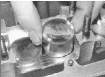
5.4 Desmontaje de un taqué hidráulico
