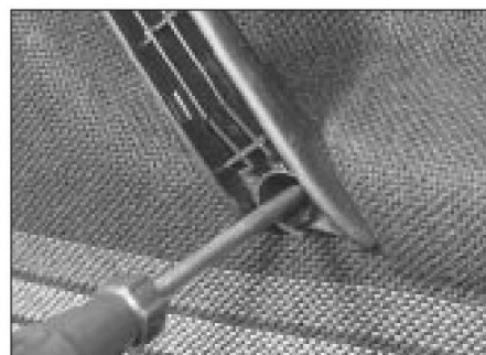
14.3b Quitar el mecanismo de retención del tirador de la puerta tornillos
