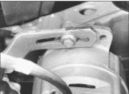
13.4a Enlace tensor de correa de transmisión del alternador - 1,3 litro
