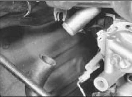
3.3b. . . y manguera de emisión del cárter - 1,3 litros
