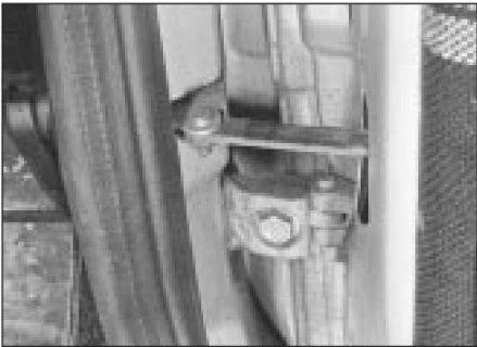
16.1 Correa de retención de puerta y bisagra
