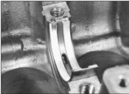
29.2 Montaje del casquillo del cojinete de bancada central
