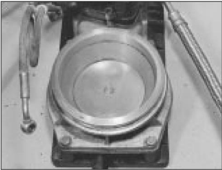
14.2 Vista superior de la placa del sensor de flujo de aire
