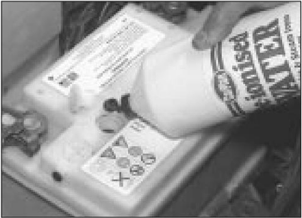
7.3b. . . y rellene el nivel de electrolito usando agua destilada o desionizada
