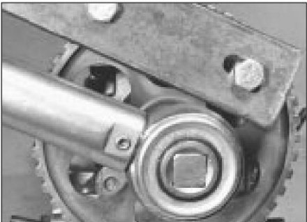
35.5 Método para apretar el perno de la rueda dentada del árbol de levas
