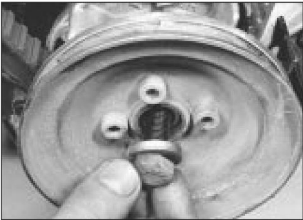
12.7 Desmontaje del perno y la arandela del piñón del cigüeñal
