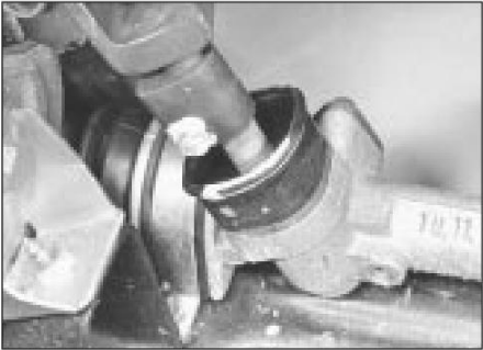
17.6 Unión piñón-columna inferior del mecanismo de dirección
