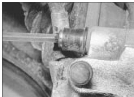
2.3a Extracción del perno de fijación de la pinza
