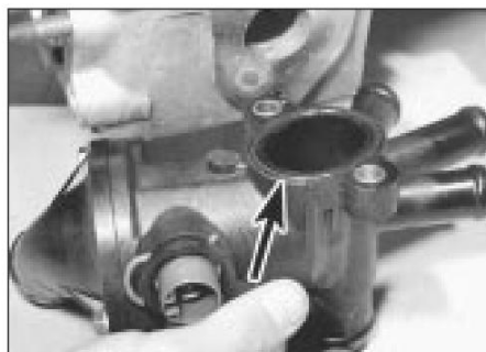
11.4 Junta tórica (flecha) en la carcasa del termostato
