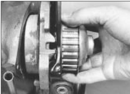
6.6 Extracción de la bomba de refrigerante
