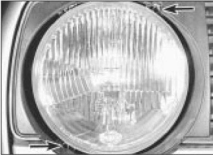
27.3 Gire los tornillos de ajuste (flechas) para ajustar la alineación del haz de faros
