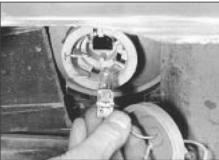
7.2 Desmontaje de la bombilla y el soporte de la luz antiniebla
