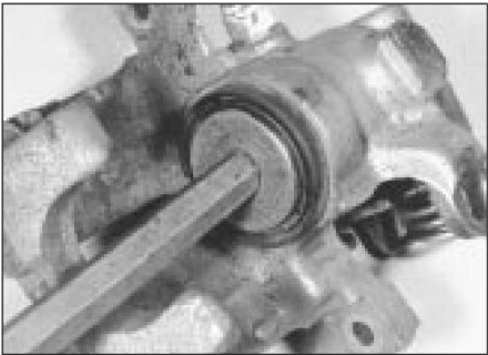
2.20a Retracción del pistón de la pinza con una llave Allen
