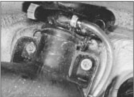
7.6 Válvula y manguera de ventilación de llenado de combustible
