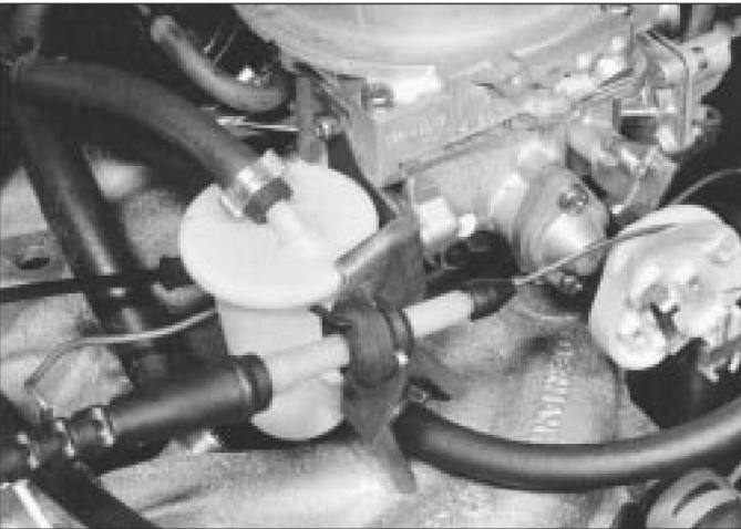
10.3 Cable del acelerador al control del acelerador del carburador
