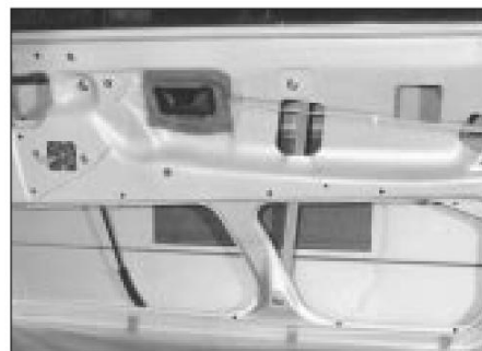
14.10 Cubierta de plástico retirada para acceder a los componentes de la puerta
