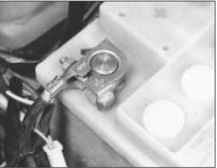
4.2 Conexión del terminal positivo de la batería
