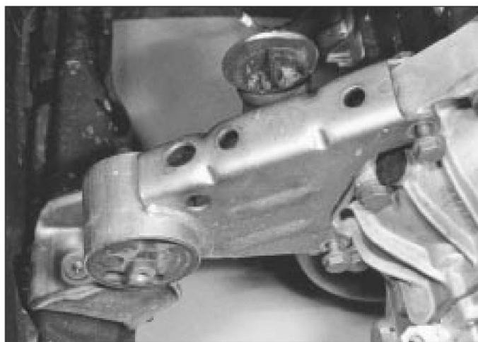
5.26b Desatornille y retire la unidad de montaje
