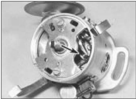
11.4 Puntos del interruptor de contacto vistos a través de la ventana en la placa de soporte (flecha) - Ducellier
