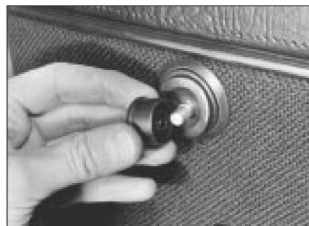
14.5 Desmontaje del pomo de ajuste del retrovisor exterior
