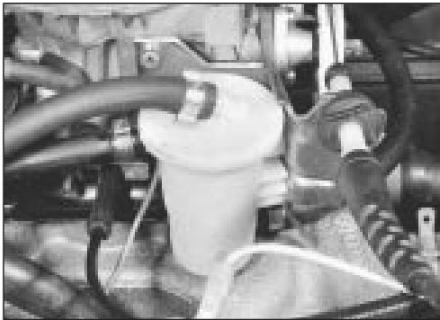
6.1 Ubicación del depósito de combustible - 1,3 litros
