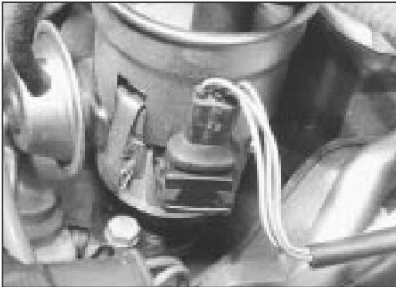
4.6a Conexión multiconector al sensor Hall en el lateral del distribuidor
