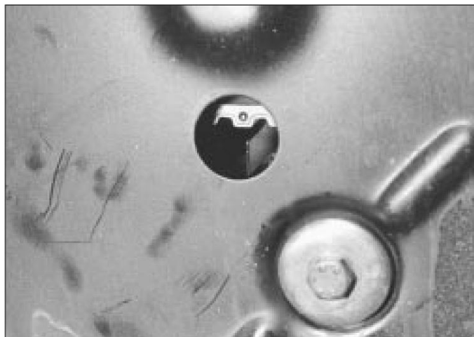
9.3a Marca de PMS en la rueda dentada del árbol de levas y puntero
