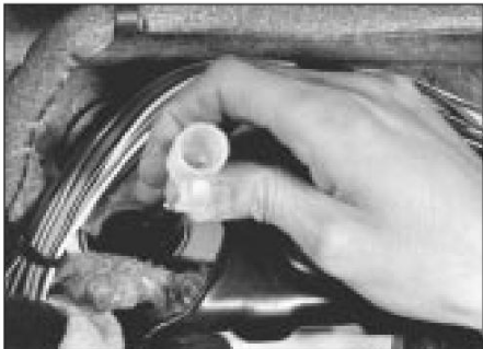
16.4 Desconectar el cable del velocímetro
