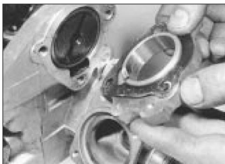
10.13 Desmontaje de la brida del distribuidor
