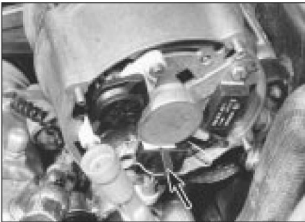
7.2 Conector múltiple de cable y clip de retención (flecha) - alternador Bosch
