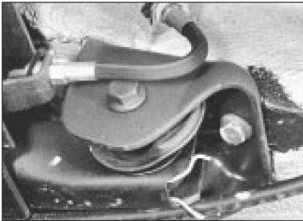
9.7 Posición de montaje de la cabeza del perno de pivote de la viga del eje
