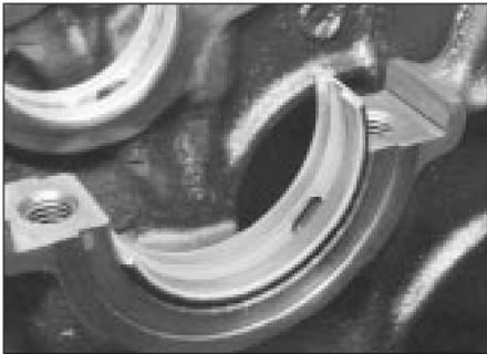
30.3b Montaje del cojinete principal central de tipo alternativo en el cárter. . .
