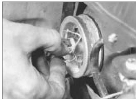
4.3 Apriete los clips de retención del bulbo. . .
