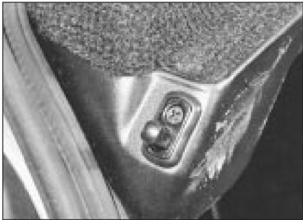
14.2 Interruptor de luz del maletero accionado por el portón trasero
