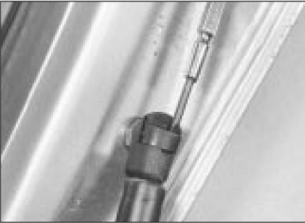
9.2a Soltar la abrazadera de rótula del amortiguador del portón trasero
