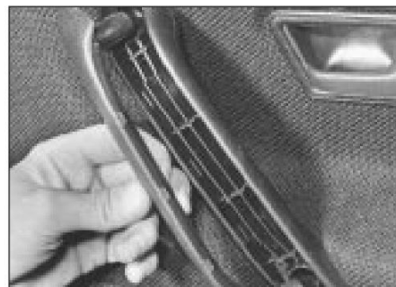
14.3a Extracción de la cubierta del tirador de la puerta
