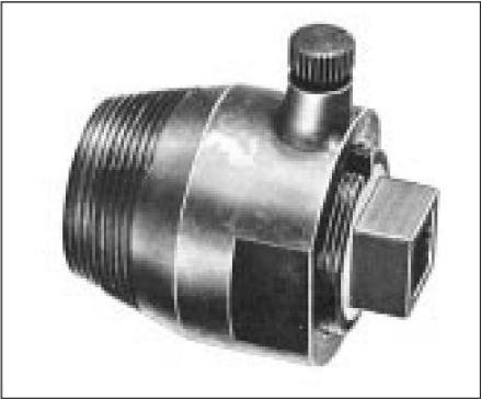
20.8 Herramienta VW 2085 para quitar el retén de aceite del cigüeñal (extremo de la correa de distribución) y sello de aceite del árbol de levas
