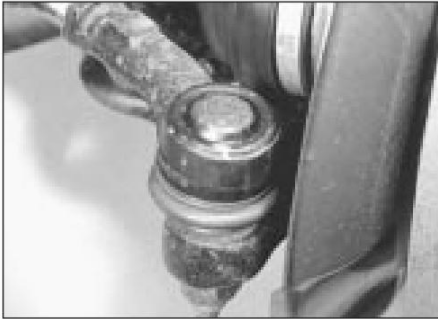
28.2 Inspeccionar las cubiertas antipolvo de las rótulas
