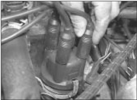
6.5 Asegúrese de que todas las conexiones de los cables HT estén seguro
