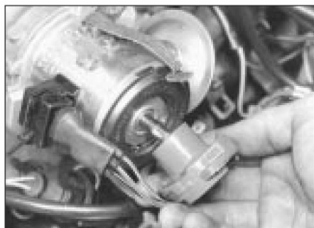
11.9 Montaje del brazo del rotor
