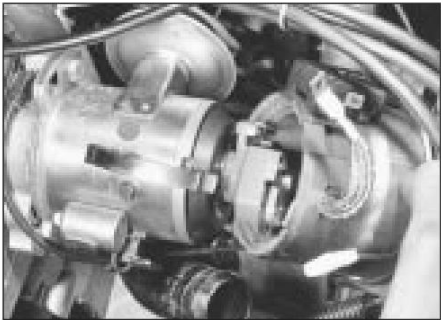
11.2 Retirar la tapa del distribuidor y el anillo filtrante
