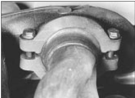
19.10 Conexión brida bajada de escape a colector - 1,3 litros
