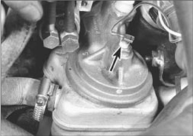
5.39 Transmisor de temperatura del aceite (flecha)
