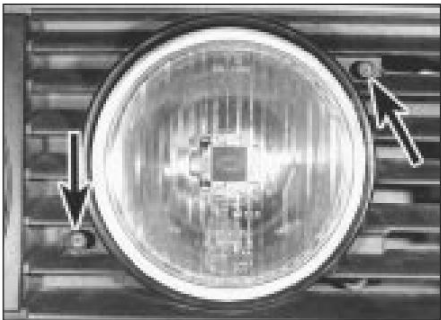
7.4 Tornillos de ajuste de alineación del haz de luz antiniebla (flecha)
