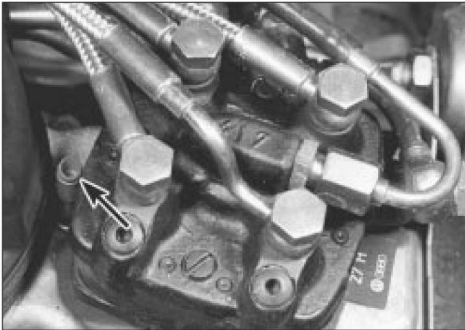
7.2 Ubicación del tornillo de ajuste de CO inactivo (flecha)
