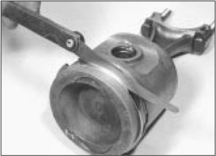
23.7b Comprobación de la pared entre el anillo y la ranura del pistón autorización
