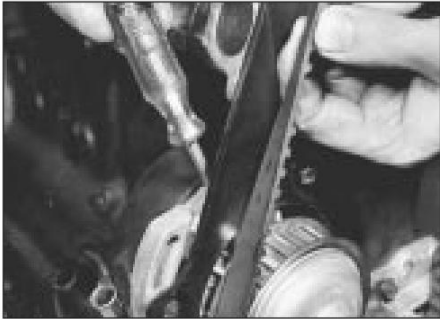
36.13 Tensar la correa de distribución
