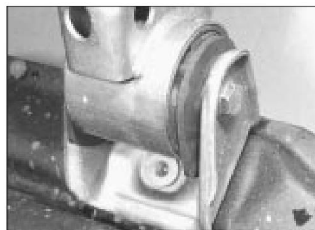
5.26a Desenroscar el perno pasante de montaje frontal
