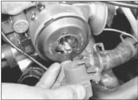
11.3 Retire el brazo del rotor
