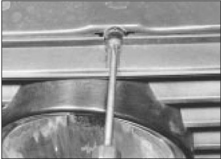
8.2 Aflojar los tornillos de sujeción de la rejilla delantera
