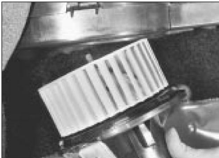
9.4 Retiro de la unidad de soplado de la carcasa
