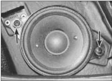
32.3 Tornillos de retención del altavoz montado en el salpicadero (flecha)
