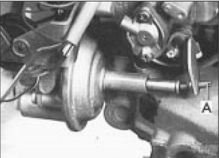
17.39b Tornillo de ajuste de ralentí rápido (A)
