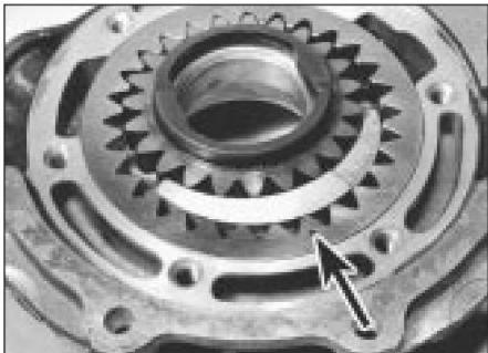
24.3b La muesca del rotor exterior (flecha) debe mirar hacia la cubierta.
