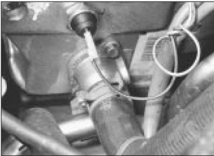
5.8a Ubicación del interruptor de presión de aceite en la parte trasera de la culata
