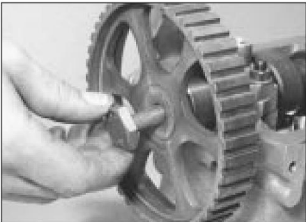
10.8 Montaje del tornillo del piñón del árbol de levas
