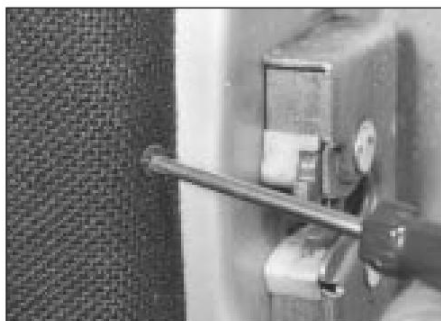
14.7b Extracción del tornillo de retención del panel embellecedor (borde trasero)
