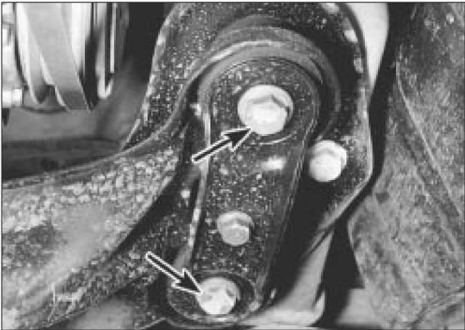
22.4 Puntos de fijación del soporte del parachoques delantero al larguero (flecha)
