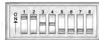
Ejemplo de ocho interruptores DIP con tres posiciones
