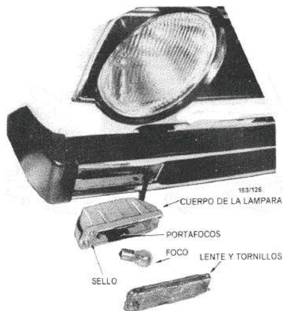
Componentes de la Lámpara de Señal de Vuelta
