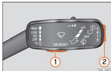
Fig. 125 Palanca del limpiaparabrisas: teclas de control.
