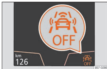
Fig. 231 En la pantalla del cuadro de instrumentos: indicación de Front Assist desactivado.
