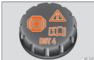
Fig. 61 Vano motor: tapón del depósito del líquido de frenos.
