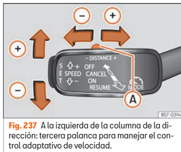
Fig. 236 A la izquierda de la columna de la dirección: tercera palanca para manejar el control adaptativo de velocidad.
