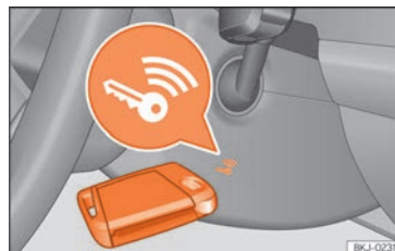
Fig. 216 A la derecha de la columna de dirección: arranque de emergencia.
