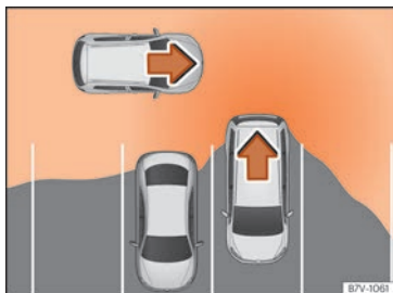
Fig. 245 Representación esquemática del asistente de desaparcamiento: zona vigilada alrededor del vehículo que está desaparcando.
