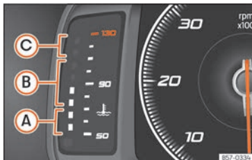
Fig. 124 Cuadro de instrumentos digital: indicador de temperatura del líquido refrigerante del motor.
