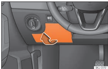
Fig. 63 En el tablero de instrumentos del lado del conductor: tapa de la caja de fusibles.
