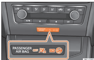
Fig. 25 Parte central del tablero de instrumentos: testigo de control de la desactivación del airbag del acompañante.
