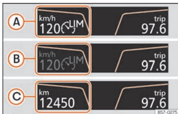
Fig. 226 En la pantalla del cuadro de instrumentos: indicaciones del estado del limitador de velocidad.
