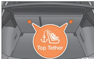
Fig. 38 Posición de las anillas Top Tether en la parte posterior del asiento trasero.
