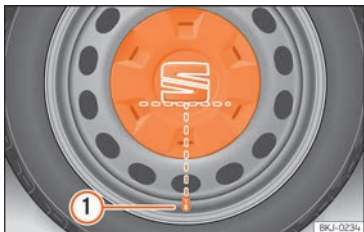
Fig. 70 Colocación correcta del embellecedor central de rueda para llantas de acero.
