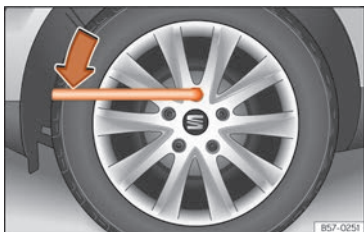
Fig. 72 Cambio de rueda: aflojar los tornillos de rueda.
