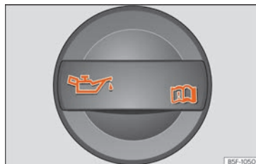
Fig. 59 Tapón de la boca de llenado de aceite del motor en el vano motor.
