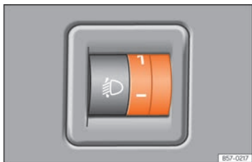
Fig. 143 Tablero de instrumentos: regulador del alcance de los faros.
