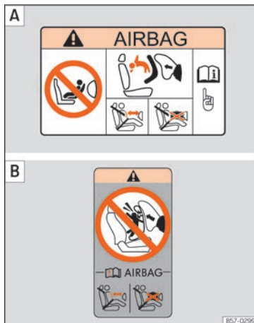
Fig. 30 Adhesivos del airbag - versión 1: en el parasol del lado del acompañante [A] y en el marco posterior de la puerta del acompañante [B].
