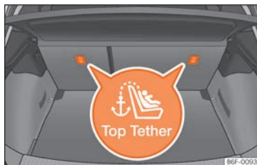
Fig. 34 Posición de las anillas Top Tether en la parte posterior del asiento trasero.
