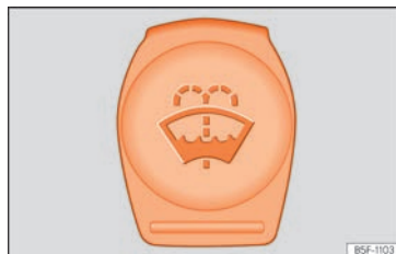
Fig. 62 En el vano motor: tapón del depósito del limpiacristales.
