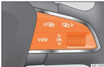
Fig. 126 Lado derecho del volante multifunción: teclas para utilizar los menús y las indicaciones informativas del cuadro de instrumentos.
