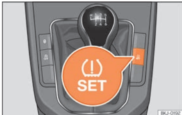
Fig. 284 Consola central: tecla del sistema de control de los neumáticos.
