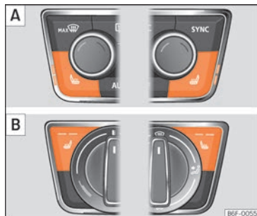
Fig. 149 En la consola central: mandos para la calefacción de los asientos delanteros. [A]: versión con Climatronic. [B]: versión con aire acondicionado manual.
