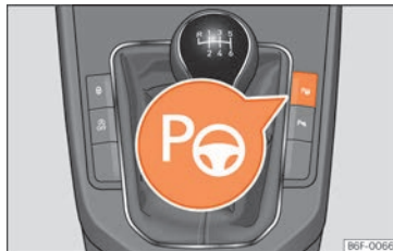
Fig. 247 En la consola central: tecla para conectar el sistema de aparcamiento asistido.
