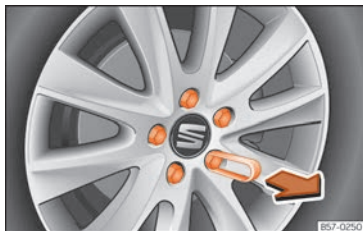
Fig. 71 Rueda: tornillos de la rueda con capuchones.
