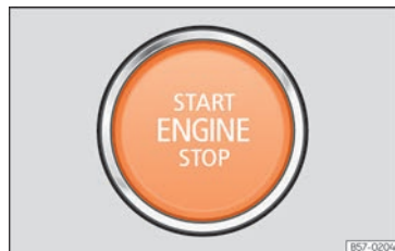
Fig. 215 En la parte inferior de la consola central: pulsador de arranque.
