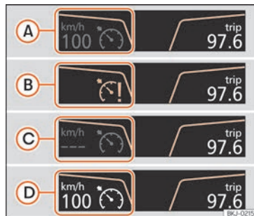
Fig. 225 Pantalla del cuadro de instrumentos: indicaciones de estado del GRA.
