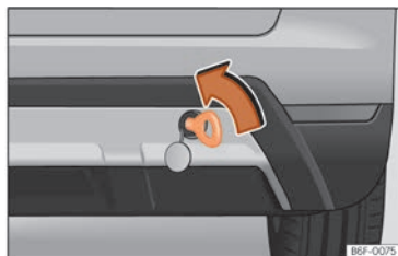
Fig. 77 Parte derecha del parachoques trasero: argolla de remolque.
