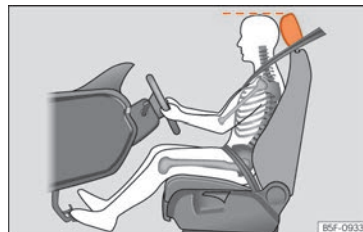
Fig. 84 Posición correcta del apoyacabezas del conductor.
