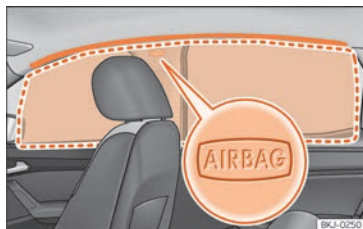
Fig. 28 Ubicación y zona de despliegue del airbag para la cabeza.
