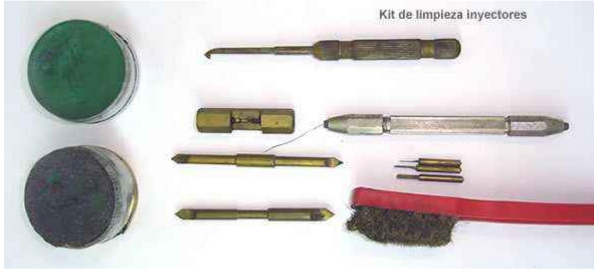
Las incrustaciones fuertes en lugares poco accesibles, como el taladro de la tobera, pueden ablandarse sumergiéndola en agua mezclada con sosa cáustica y detergente. Posteriormente debe ser limpiada y secada, para sumergirla a continuación en gasoleo hasta el momento del montaje.
