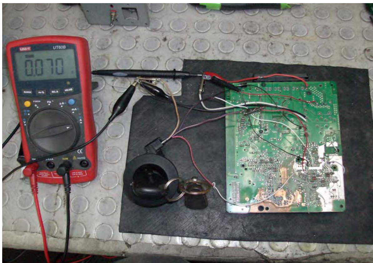
Figura 29: Prueba de BCM con aro lector y llave
