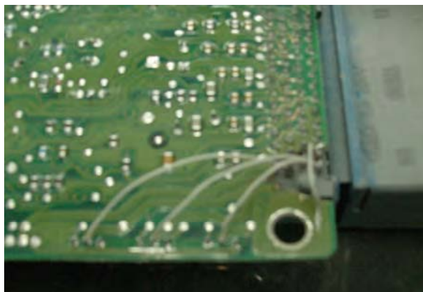
Figura 19: Reconstrucción de pistas con cable calibre 22
