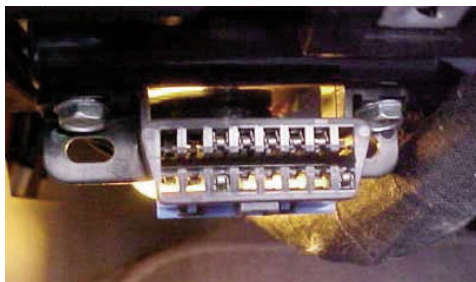
El conector suele encontrarse a un costado de la barra de dirección, debajo del tablero.
