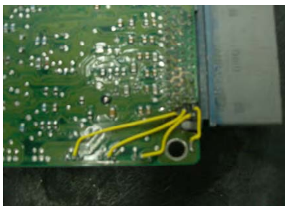
Figura 20: Reconstrucción de pistas con cable calibre 24
