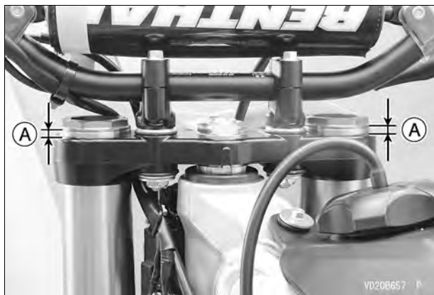
A. Posición de la abrazadera de la horquilla estándar
