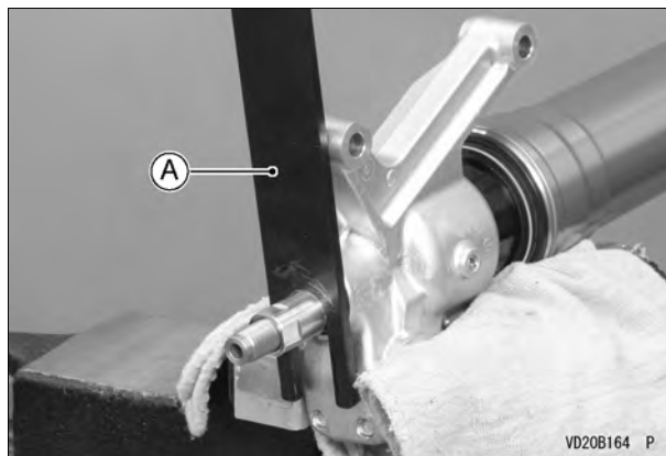
A. Llave para el tapón superior, 49 mm (herramienta especial: 57001-1653)
