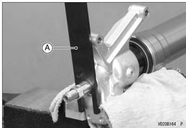
A. Llave para el tapón superior, 49 mm (herramienta especial: 57001-1653)
