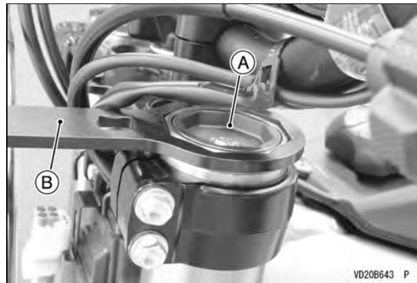
A. Tapón superior de la horquilla delantera B. Llave para el tapón superior, 49 mm (herramienta especial: 57001-1653)
