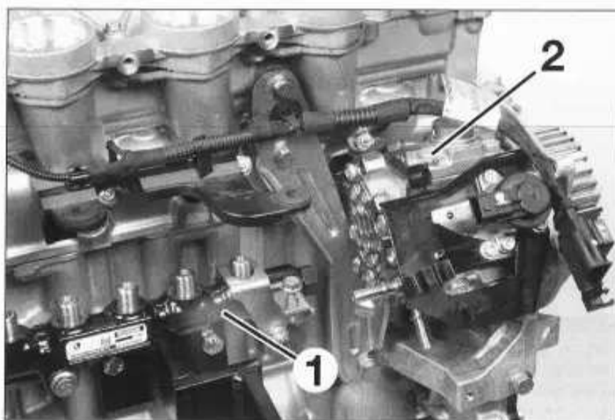
1. Rampa alimentación de alta presión - 2. Bomba de alta presión.
