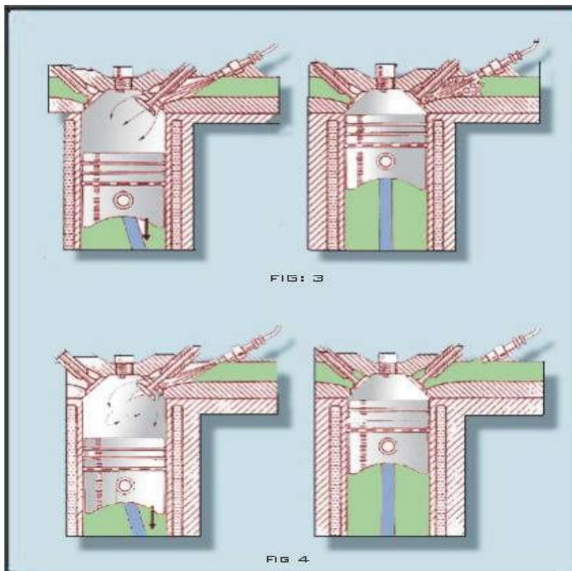
En este caso recibe el nombre de inyección continua. Cuando la válvula de admisión se abre, la corriente de aire que provoca arrastra también la niebla del combustible al interior del cilindro y cuando la válvula permanece cerrada, esta niebla se va acumulando en la misma entrada que la válvula cierra hasta la próxima abertura en la que será arrastrada de nuevo por la corriente de aire provocada.
