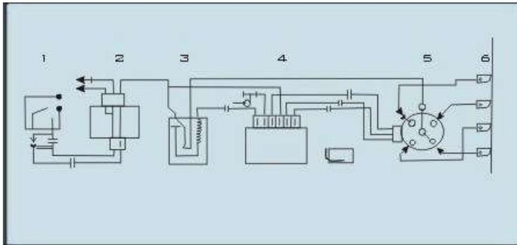
Un ejemplo de aplicación del generador HALL es el sistema TSZH BOSCH el cual dispone de un módulo similar en funcionamiento al TSZI analizado anteriormente con la salvedad de la distribución de los terminales en el módulo, por ejemplo el generador Hall se alimenta a través de los terminales 3 y 5 mientras que la señal de entrada al módulo es por el terminal 6
