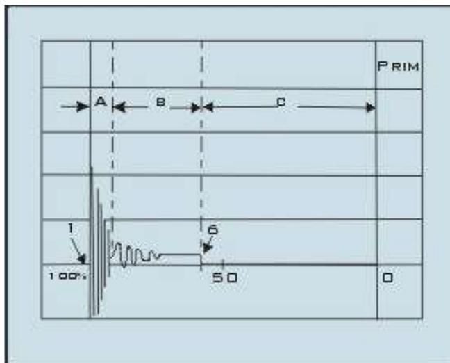
En esta curva se aprecia una notable diferencia con respecto al oscilograma primario del encendido convencional. Falta por completo la oscilación amortiguada al comienzo de la transición de apertura es causada únicamente por las capacidades de conmutación existentes y quizás por condensadores de
