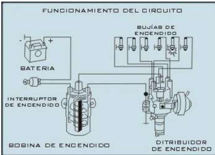
Componentes: batería, interruptor de encendido , bobina, distribuidor, platinos, condensador, bujías.
