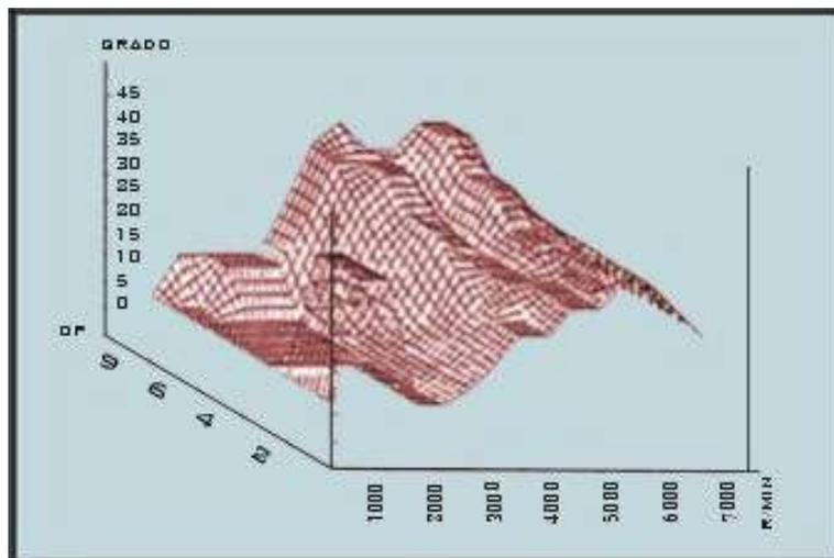
Este sistema no se adecua con las demandas actuales en cuanto a obtener un buen quemado de la mezcla de aire y gasolina y una mínima emisión de gases contaminantes, ya que no basta exclusivamente con girar mas de prisa para que el motor necesite mas avance, pues el avance depende también del estado de carga a que esté sometido en ese momento el motor.
