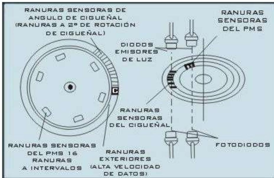
Un generador fotoeléctrico utiliza la emisión de luz de un diodo LED que choca con un fototransistor y genera un señal de voltaje. La rueda de disparo es un disco que pasa entre el diodo y el transistor, por lo tanto, cuando una de las ventanas del disco queda entre el diodo y el fototransistor, la luz del diodo pasa y se genera un nivel alto en la salida. Los generadores fotoeléctricos son utilizados como sensores de posición del cigüeñal en un sinnúmero de sistemas.
