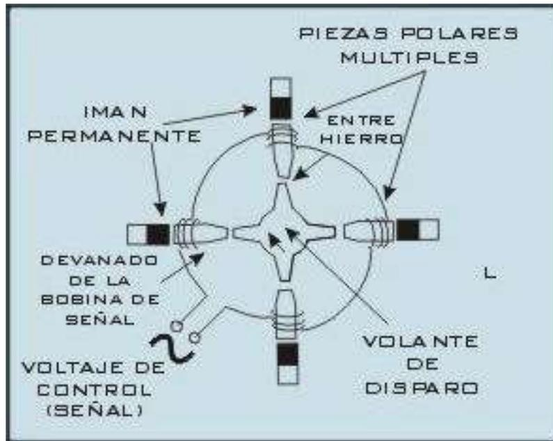
Está formado por una bobina de captación, una pieza polar con un imán permanente mas un rotor giratorio conectado al eje del distribuidor.
