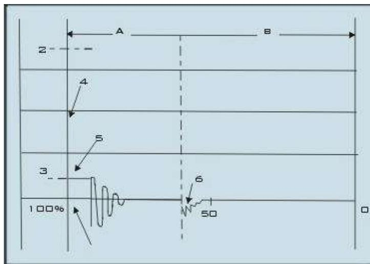
Prácticamente no se diferencia del oscilograma secundario del encendido convencional. Para la transición de cierre, tensión de encendido, chispa y amortiguación es idéntico que el oscilograma normal. En lugar de decir contactos abiertos o cerrados, se dice ahora solamente transistor en corte o en saturación (conduciendo).
