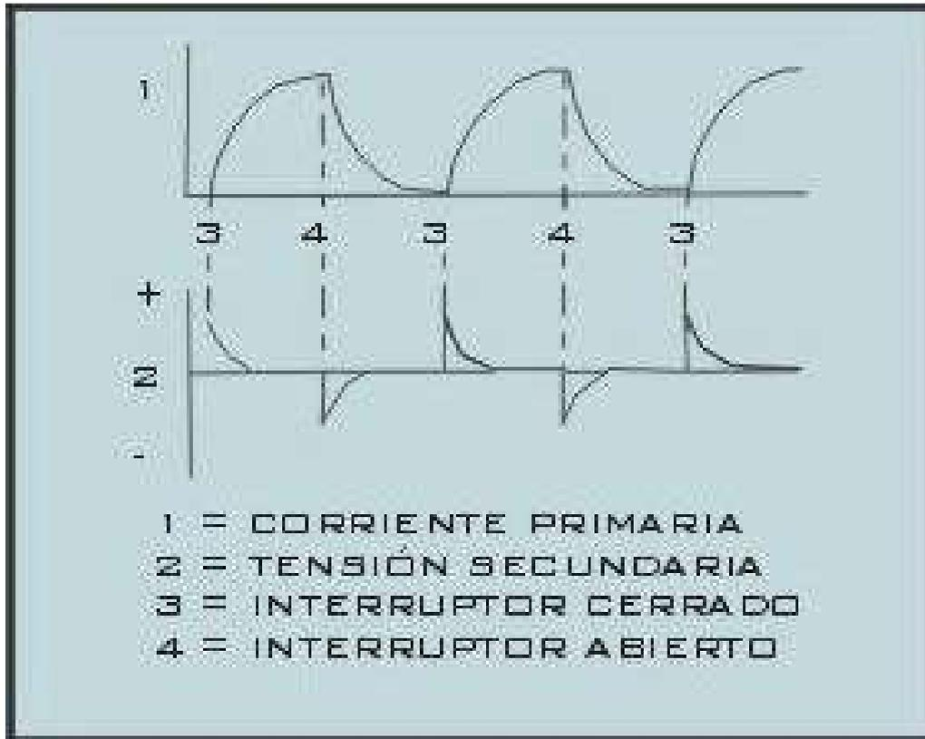
Para que se induzca tensión en el secundario de un transformador es necesario que el campo magnético del primario varíe.
