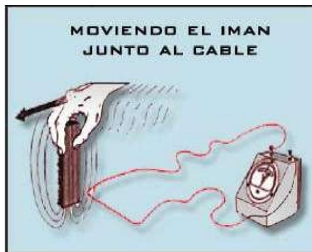
Si el imán se deja cerca del conductor pero no se mueve, la aguja del instrumento no se desvía, lo que indica que el movimiento es absolutamente necesario para producir un campo magnético.
