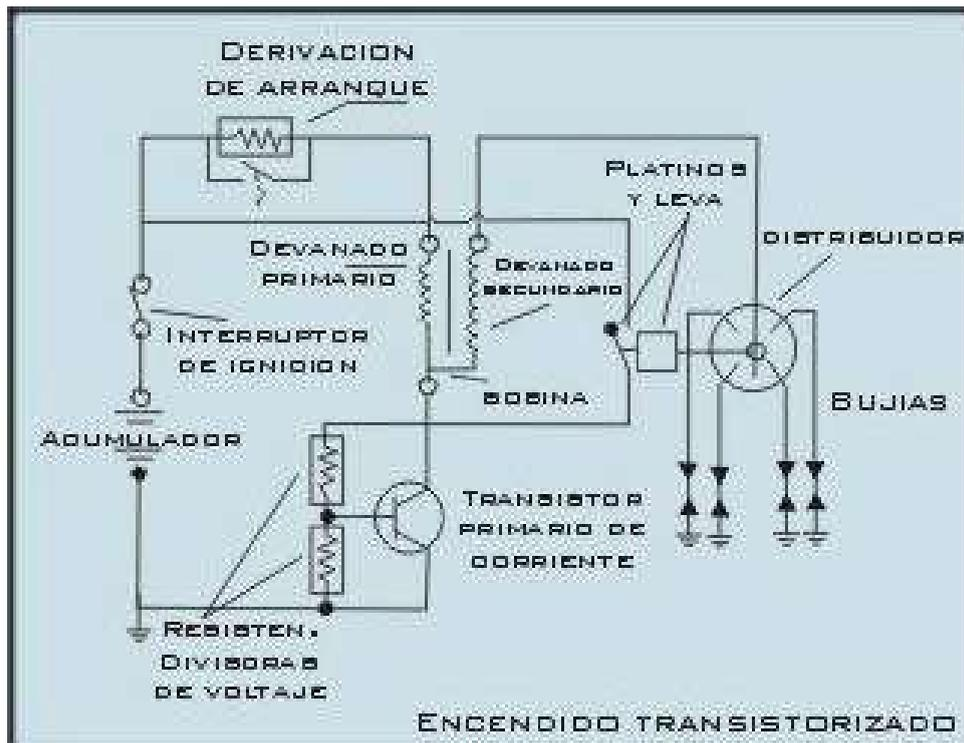
Este sistema propio de Bosch tiene la ventaja con respecto al encendido convencional de liberar al raptor de la función de alimentar de corriente al primario de la bobina, dicha labor la realiza un transistor de
