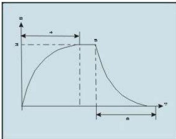
Este fenómeno se compara con frecuencia a la inercia, es necesario tirar fuertemente de una carretilla para ponerla en movimiento, e inversamente cuando está rodando hay que frenarla para detenerla. La inercia y la autoinducción tienden a oponerse a toda modificación del estado existente.
