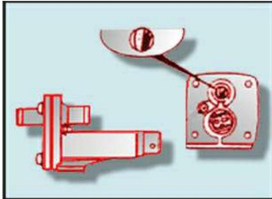
Válvula IAC : En este tipo de válvula se controla tanto el arranque en frío como estabilidad del ralentí según la carga. La válvula es gobernada por un motor eléctrico el cual recibe señales desde la ECU para posicionarse.
