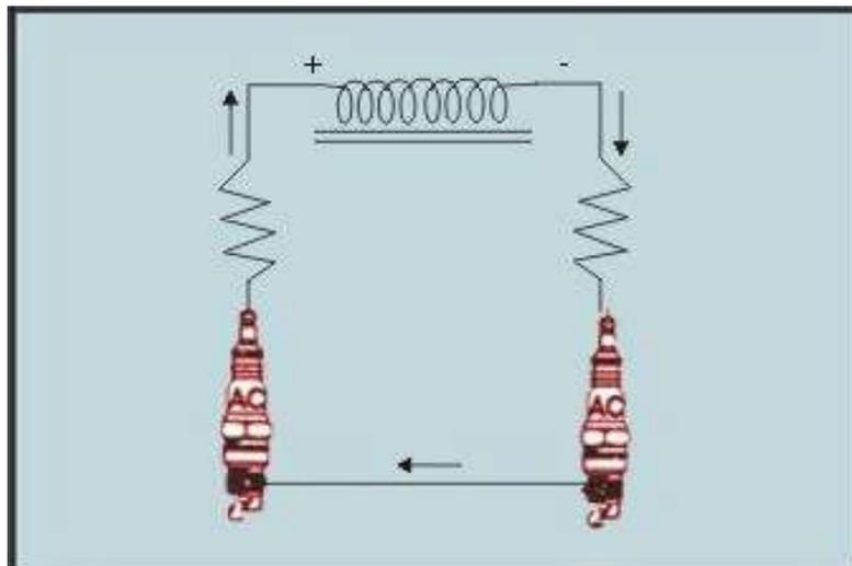
Un circuito de control dentro del módulo, maneja el flujo de la corriente primaria y su tiempo de ángulo de contacto, el devanado de la bobina primaria tiene una resistencia muy pequeña (menor a 1 ohms). Cuando se aplica un voltaje de 14 volts circula una corriente teórica mayor que 14 amperes. Lo cual ayuda a disminuir el tiempo de saturación. Sin embargo, para evitar daño en los componentes del sistema, el flujo máximo de la corriente se debe mantener entre 8.5 a 10 amperes.
