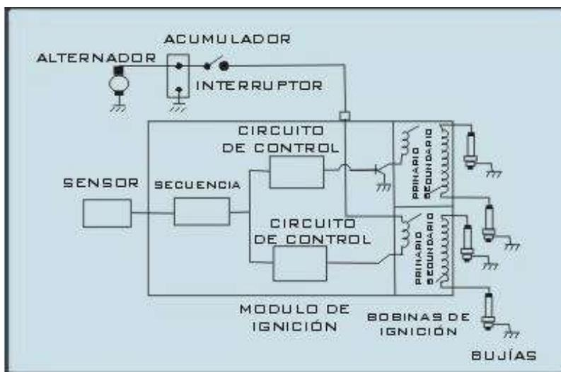
Se vigila la corriente máxima de la bobina en el ciclo previo. Si no alcanzó su valor máximo, el módulo aumenta el tiempo de intervalo para permitir la saturación completa de la bobina. Si se alcanzó la corriente máxima, el módulo disminuye el tiempo de ángulo de contacto, para reducir la potencia consumida por el sistema.
