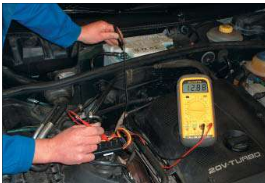
Medición con cable adaptador
