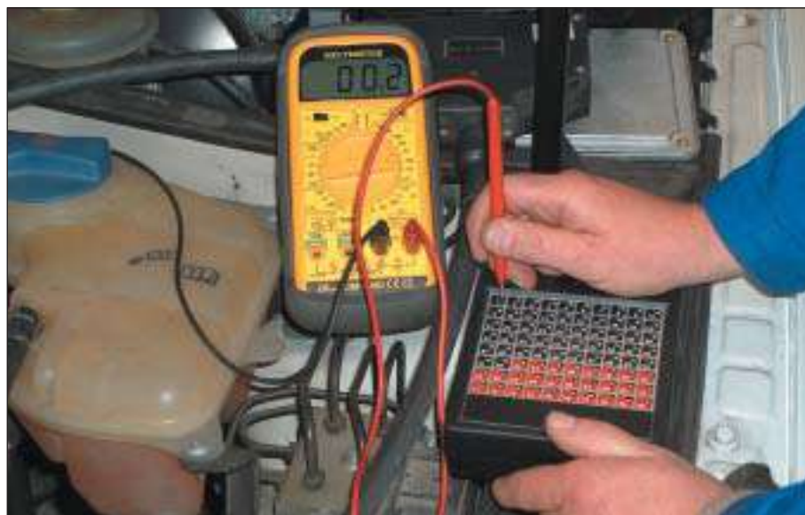
Comprobación con caja de comprobación
